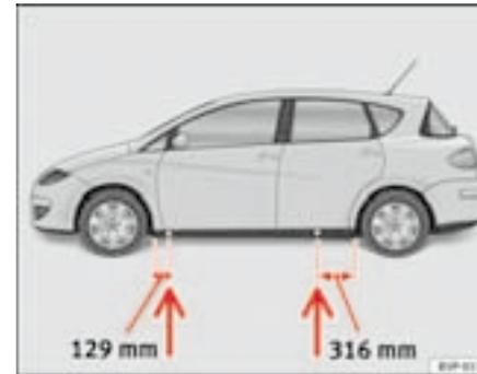
**Fig. 171** Puntos de apoyo del gato
