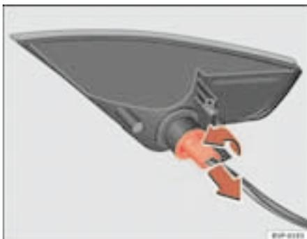
Fig. 190 Piloto una vez extraído del parachoques
