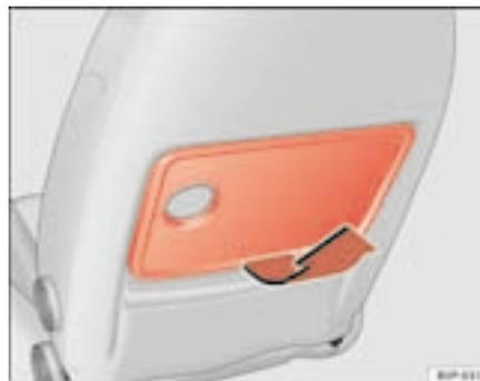
Fig. 102 Mesita plegable del asiento delantero izquierdo
