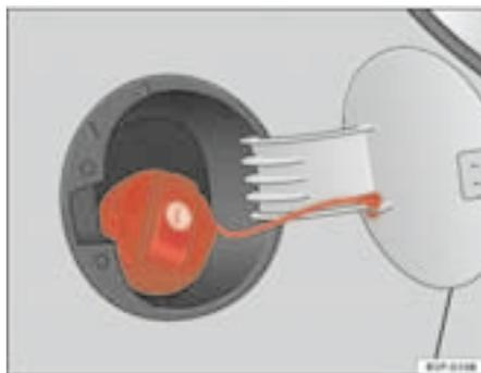
Fig. 154 Tapa del depósito abierta
