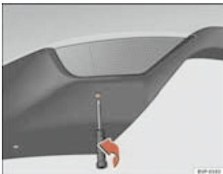
Fig. 189 Piloto montado en parachoques desde una vista inferior
