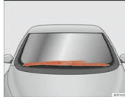
**Fig. 162** Limpiacrystal en la posición para realizar el cambio
