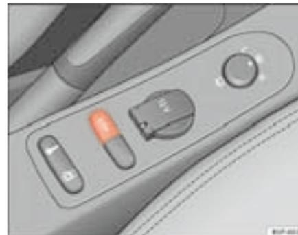
**Fig. 129** Detalle de la consola central: tecla ESP
