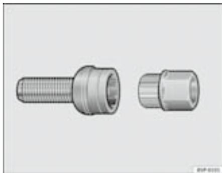
**Fig. 174** Tornillo antirrobo de la rueda
