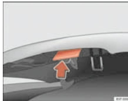
Fig. 156 Gancho apertura capó motor.
