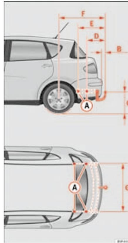
Fig. 153 Puntos de fijación del dispositivo de remolque
