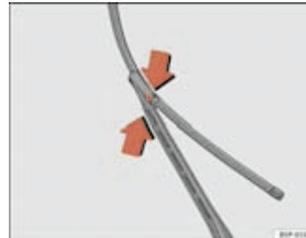
**Fig. 163** Cambio de las escobillas del limpiaparabrisas
