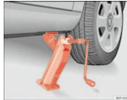
**Fig. 172** Colocación del gato
