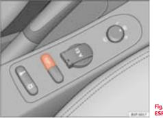
Fig. 129 Centre console: ESP button
