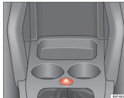
Fig. 77 Tableau de bord : commutateur du signal de détresse
