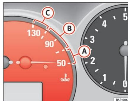
Fig. 35 Tableau de bord : indicateur de température de liquide de refroidissement du moteur
