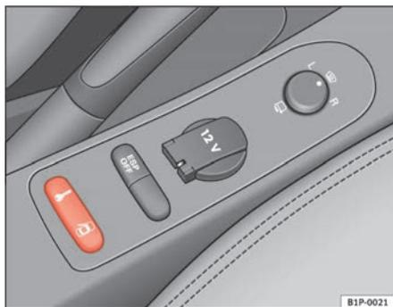
Fig. 60 Détail de la console centrale : touche de verrouillage centralisé
