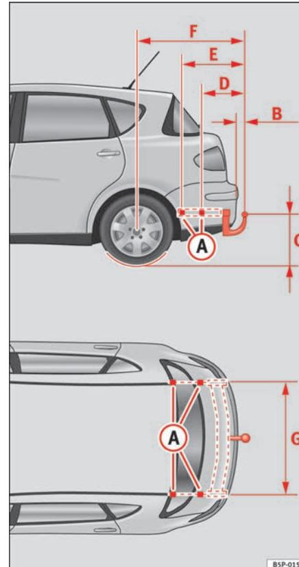
Fig. 158 Points de fixation du dispositif d'attelage
