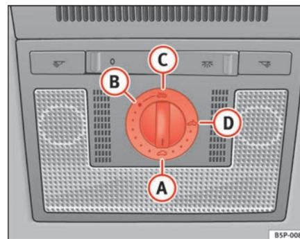
Fig. 71 Détail du revêtement du ciel de pavillon : commande rotative du toit ouvrant coulissant/relevable
