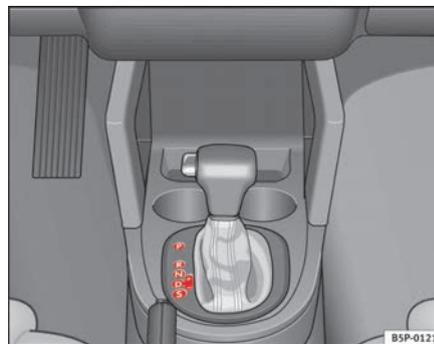
Fig. 138 Console centrale : levier sélecteur de la boîte automatique / de la boîte DSG
