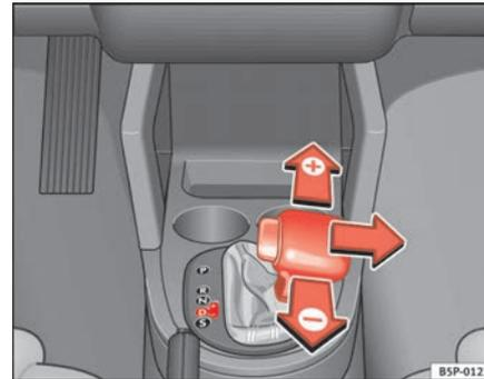
Fig. 142 Changement de vitesses avec la commande tiptronic
