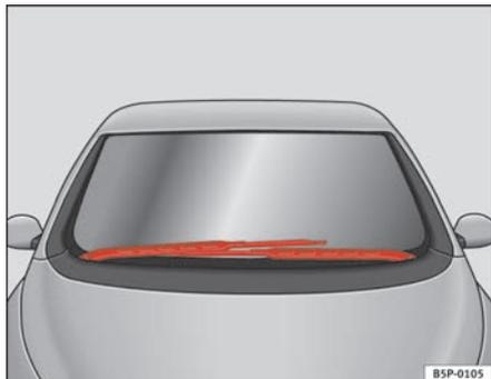
**Fig. 167** Essuie-glace en position de maintenance
