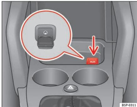
**Fig. 118** Connecteur pour l'entrée auxiliaire audio
