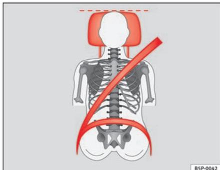
**Fig. 3** Appuie-tête correctement réglé, vu de l'avant
