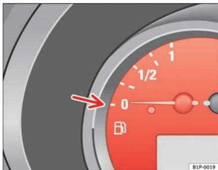
Fig. 34 Tableau de bord : Indicateur de niveau du réservoir de carburant
