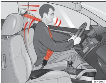
**Fig. 11 Conducteur avec la ceinture de sécurité comme il convient : il est tenu par celle-ci en cas de freinage sec**
