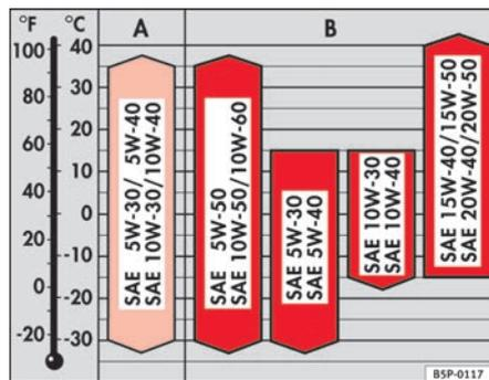
Fig. 162 Types d'huile en fonction de la température
