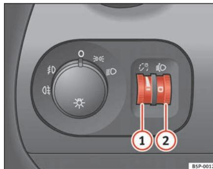
Fig. 75 Tableau de bord : molettes du rhéostat d'éclairage des cadrans et des commandes et du réglage du site des projecteurs
