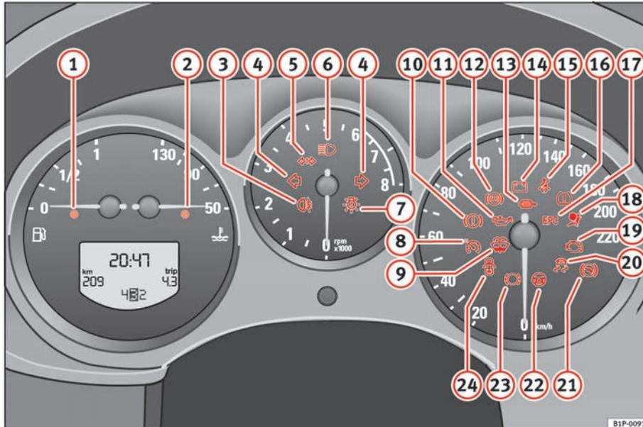
Fig. 47 Combiné d'instruments avec témoins d'alerte et de contrôle. Certains des témoins d'alerte et de contrôle présentés ici n'existent que sur certaines versions ou constituent des options.
