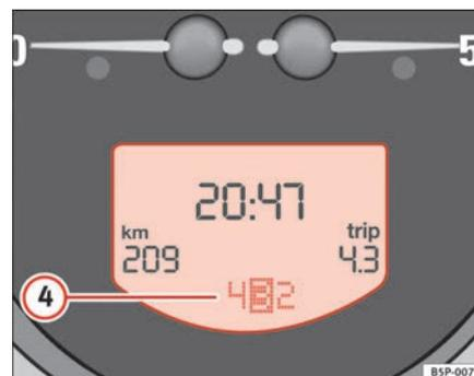
Fig. 37 Détail du tableau de bord : écran avec indicateur de marches du Tiptronic
