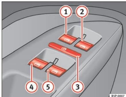
Fig. 69 Détail de la porte du conducteur : éléments de commande des glaces avant et arrière
