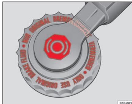
**Abb. 170** Im Motorraum: Abdeckung des Bremsflüssigkeitsbehälters
