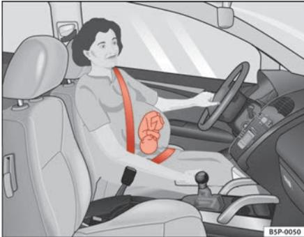
Abb. 15 Gurtbandverlauf bei schwangeren Frauen
