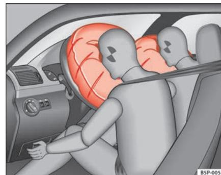
**Abb. 20 Aufgeblasene Frontairbags**
