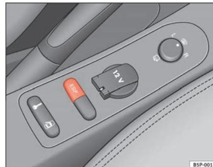
Abb. 134 Ausschnitt aus der Mittelkonsole: ESP-Taste
