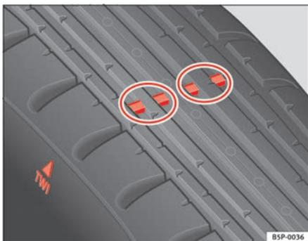
Abb. 171 Prinzipdarstellung Reifenprofil: Verschleißanzeiger
