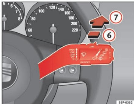
Abb. 88 Scheibenwischer- und Scheibenwascherhebel: Scheibenwischer für die Heckscheibe
