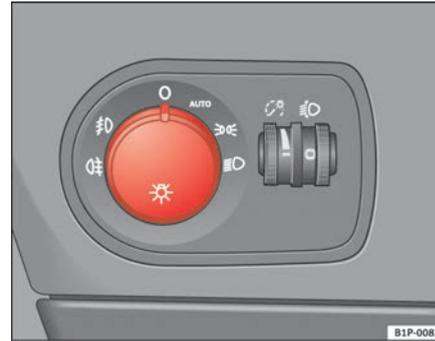
Abb. 74 Automatisches Fahrlicht
