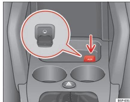
Abb. 118 Anschluss für einen zusätzlichen Audio-Eingang
