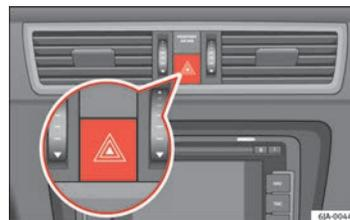
Fig. 59 Quadro strumenti: interruttore lampeggio di emergenza
