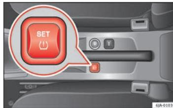
Fig. 128 Interruttore per la regolazione del livello di gonfiaggio dei pneumatici
