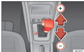
Fig. 107 Leva selettoria: Tiptronic
