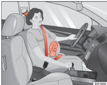
Fig. 14 Posizione del nastro della cintura di sicurezza per donne in stato di gravidanza
