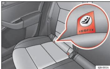
Fig. 28 Occhielli di fissaggio del sistema ISOFIX
