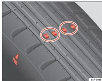
Fig. 124 Profilo dei pneumatici con indicatori di usura
