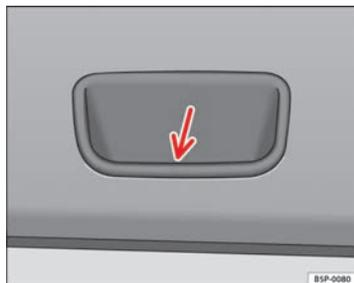
Fig. 52 Dettaglio del rivestimento interno del portellone posteriore: maniglia di presa ad incasso
