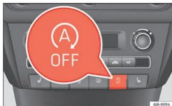
Fig. 111 Quadro strumenti: tasto del sistema START-STOP
