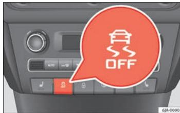
Fig. 104 Sistema ESC: Interruttore dell'ASR
