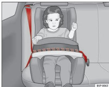
Fig. 26 Seggiolino del gruppo 1 montato sul sedile posteriore; il bambino siede rivolto verso il senso di marcia
