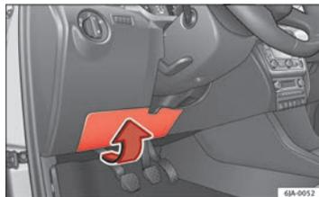
Fig. 140 Parte inferiore del cruscotto, copertura dei fusibili
