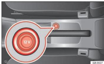
Fig. 87 Console centrale: presa di corrente da 12 V
