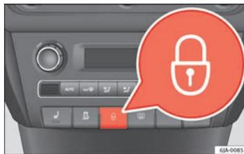
Fig. 47 Interruttore della chiusura centralizzata
