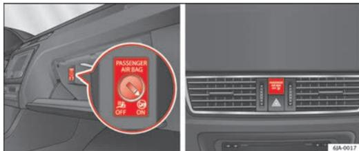
Fig. 24 Commutatore dell'airbag frontale del passeggero anteriore/spia di disattivazione dell'airbag del passeggero anteriore
