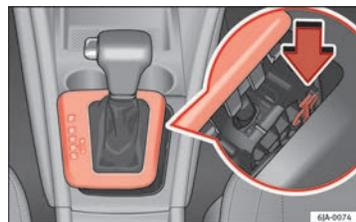
Fig. 108 Sbloccaggio d'emergenza della leva selettoria
