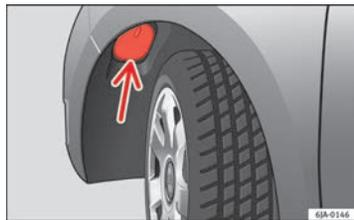
Fig. 149 Sostituzione della lampadina degli anabbaglianti: passaruote
