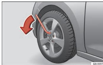
Fig. 131 Sostituzione della ruota: Come allentare i bulloni della ruota ▶
