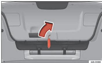
Fig. 53 Sbloccaggio di emergenza del portellone del bagagliaio.
