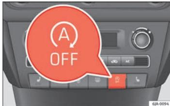
Abb. 111 Kombi-Instrument: Taster **START-STOPP-System**.
