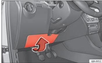
Abb. 140 Sicherungsdeckel: Untere Seite der Instrumententafel
