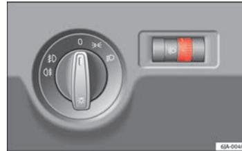
Abb. 57 Kombi-Instrument: Leuchtweitenregulierung
