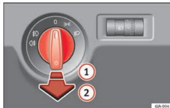
Abb. 56 Kombi-Instrument: Lichtschalter ▶
