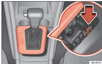
Abb. 108 Wählhebel-Notentriegelung
