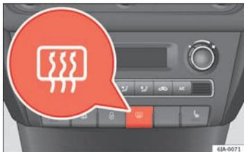
Abb. 63 Schalter für Heckscheibenheizung
