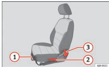
Abb. 70 Bedienelemente am Sitz / Bedienelemente an einem Sportsitz
