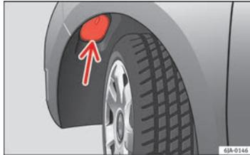
Abb. 149 Glühlampe für Abblendlicht auswechseln: Radkasten
