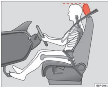
Abb. 2 Die richtige Kopfstützeinstellung für den Fahrer
