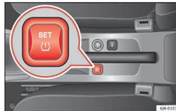
Abb. 128 Taste zum Einstellen des Reifenfülldruck-Kontrollwerts
