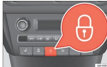
Abb. 47 Taster für Zentralverriegelung
