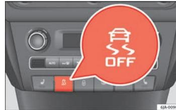
Abb. 104 ESP-System: Schalter für ASR
