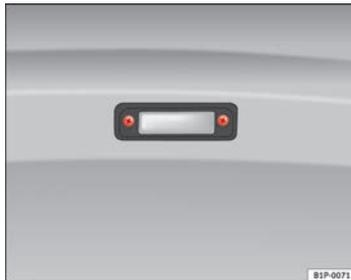
Abb. 165 Ausbau der Kennzeichenleuchte
