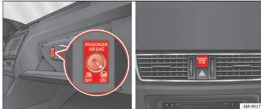
Abb. 24 Schalter für Beifahrer-Frontairbag/Kontrollleuchte für Abschaltung des Beifahrerairbags
