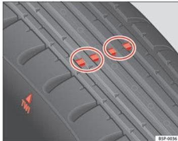
Abb. 124 Reifenprofil mit Verschleißanzeiger
