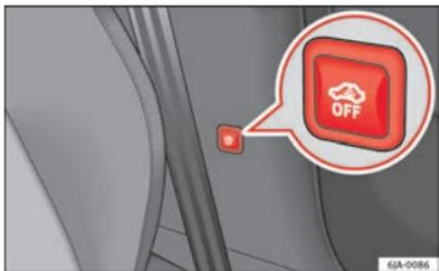
Fig. 49 Touche de la protection volumétrique et de la protection anti-soulèvement
