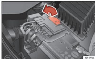
Fig. 129 Batterie : ouverture du cache ▶
