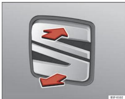
Fig. 50 Hayon : ouverture de l'extérieur
