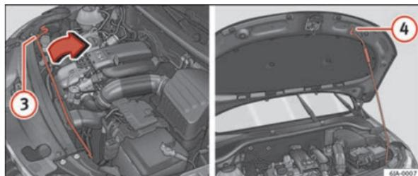
Fig. 124 Verrouillage du capot du compartiment-moteur
