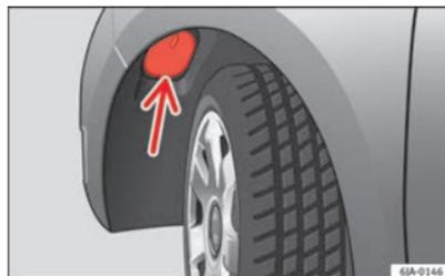
Fig. 155 Remplacement de l'ampoule des feux de croisement : passages de roues
