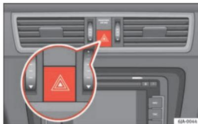
**Fig. 58** Tableau de bord : commande des feux de détresse
