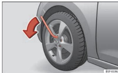
Fig. 138 Changement de roue : Desserrage des boulons de roue
