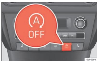
Fig. 110 Tableau de bord : touche du système START-STOP
