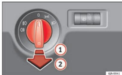
Fig. 55 Tableau de bord : commande des feux
