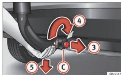
Fig. 121 Déverrouiller la barre à boule d'attelage ▶
