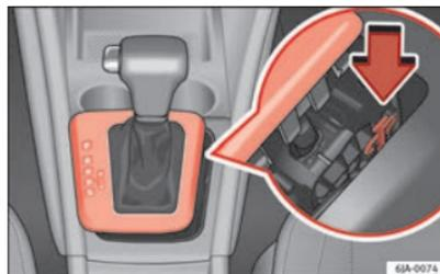
Fig. 107 Déverrouillage d'urgence du levier sélecteur
