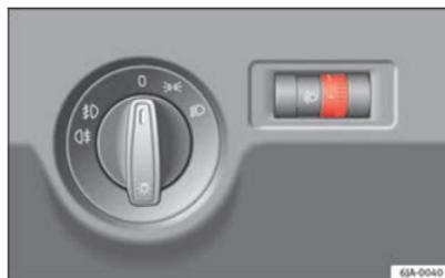
Fig. 56 Tableau de bord : dispositif de réglage du site des projecteurs
