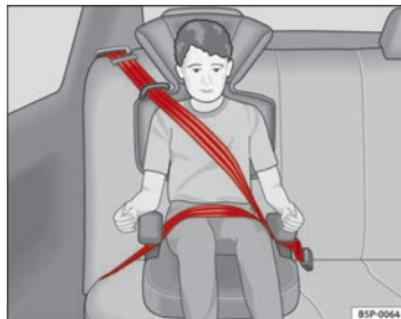
**Fig. 27** Siège pour enfant monté face à la route sur la banquette arrière.
