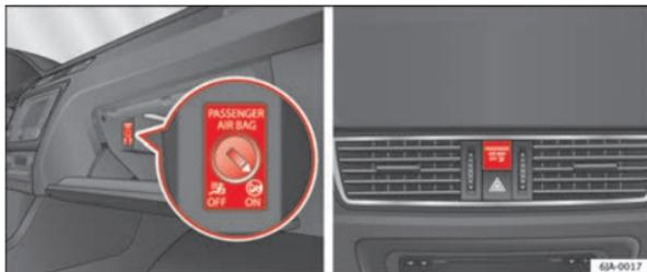
Fig. 24 Commande de l'airbag frontal du passager avant/témoin de désactivation de l'airbag passager
