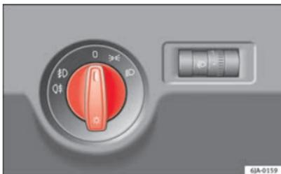
Fig. 54 Tableau de bord : Commande d'éclairage
