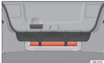
Fig. 136 Emplacement du triangle de signalisation
