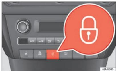
Fig. 46 Touche de verrouillage centralisé
