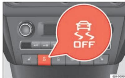
Fig. 103 Système ESC : Interrupteur de l'ASR
