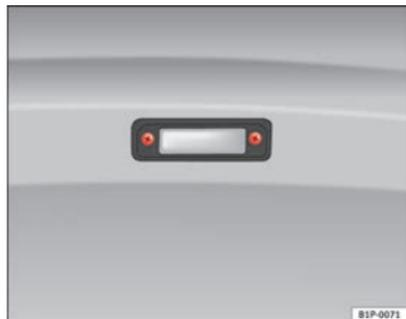
Fig. 171 Dépose de l'éclairage de la plaque d'immatriculation
