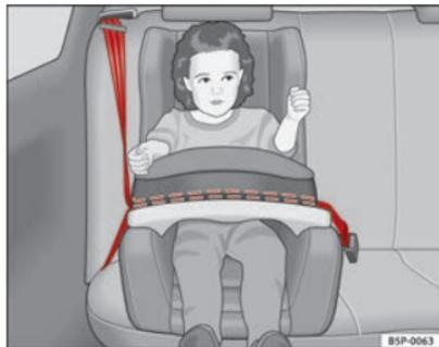
**Fig. 26** Siège pour enfant du groupe 1 monté face à la route sur la banquette arrière.
