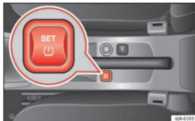
Fig. 135 Commande de réglage du niveau de gonflage des pneus
