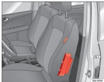
**Fig. 20** Airbag latéral dans le siège du conducteur
