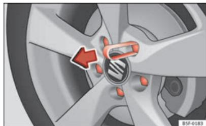
Fig. 134 Retirer le cache du boulon de la roue
