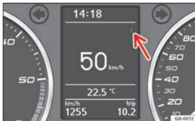
Fig. 33 Indicateur multifonction
