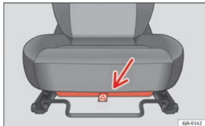
Fig. 89 Sièges du conducteur : rangement
