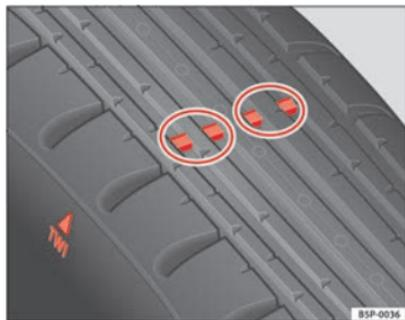
Fig. 131 Sculptures des pneus avec indicateurs d'usure
