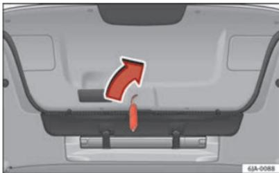
Fig. 52 Déverrouillage d'urgence du hayon.
