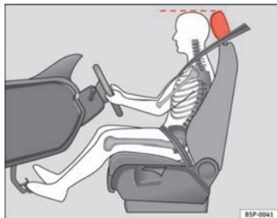
Fig. 2 Position correcte de l'appuie-tête du conducteur
