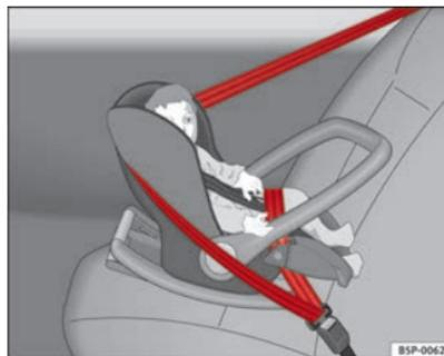
Fig. 25 Siège pour enfant du groupe 0 monté sur la banquette arrière, dos à la route.
