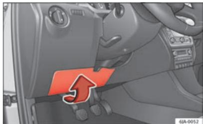
Fig. 147 Partie inférieure de la planche de bord, cache des fusibles
