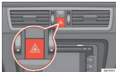
**Fig. 58** Cuadro de instrumentos: conmutador de los intermitentes de emergencia ▶
