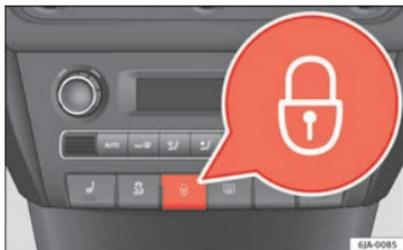
Fig. 46 Pulsador del cierre centralizado
