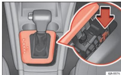
Fig. 107 Desbloqueo de emergencia de la palanca selectora
