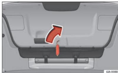
Fig. 52 Desbloqueo de emergencia del portón del maletero.
