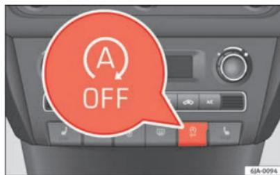
Fig. 110 Cuadro de instrumentos: tecla del sistema START-STOP
