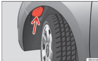
Fig. 155 Cambio de lámpara de la luz de cruce: pasarruedas
