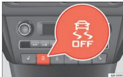
Fig. 103 Sistema ESC: Interruptor del ASR
