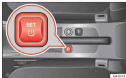
Fig. 135 Conmutador del ajuste del nivel de inflado de neumáticos
