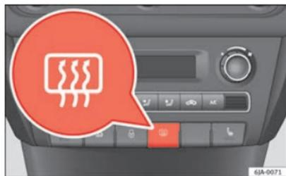
Fig. 62 Conmutador de la luneta térmica
