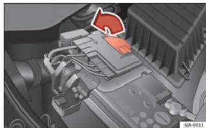
**Fig. 129** Batería: abertura de la cubierta
