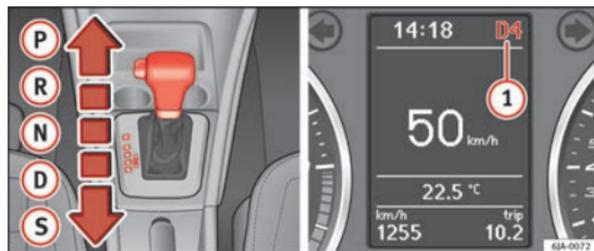
Fig. 105 Palanca selectora / Pantalla informativa: posiciones de la palanca selectora
