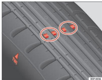
Fig. 131 Perfil de los neumáticos con indicadores de desgaste
