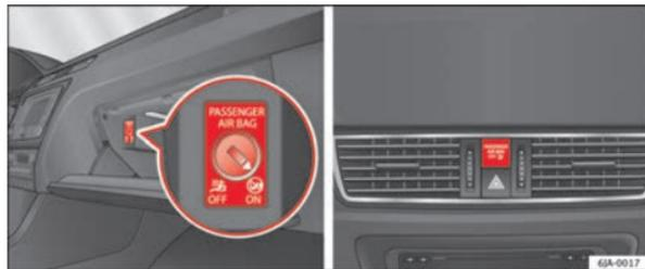
Fig. 24 Conmutador del airbag frontal del acompañante / testigo para desconexión de airbag del acompañante
