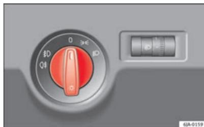
**Fig. 54** Cuadro de instrumentos: Mando de las luces
