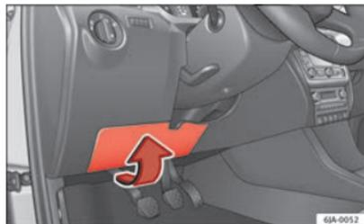
Fig. 147 Parte inferior del tablero de instrumentos tapa de fusibles
