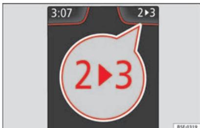
Fig. 37 Tableau de bord : indicateur du rapport le plus économique (boîte mécanique)
