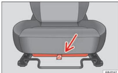
Fig. 149 Siège du conducteur : rangement.
