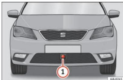
Fig. 189 Au niveau du pare-chocs avant : capteur radar.
