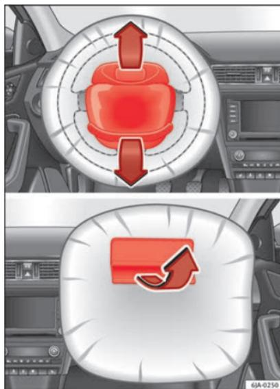
**Fig. 16** Comportement des caches des airbags lors du déclenchement des airbags frontaux.
