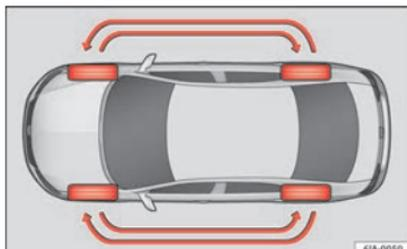
Fig. 215 Permutation des roues.
