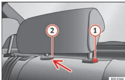
**Fig. 142** Appui-tête central arrière : point de déverrouillage.
