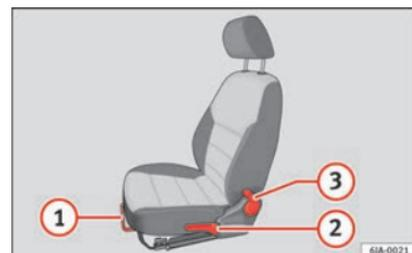
Fig. 9 Sièges avant : réglage manuel du siège.
