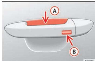
**Fig. 123** Système de fermeture et de démarrage sans clé Keyless Access : surface sensible **A** de déverrouillage vers l'intérieur de la poignée de porte, et surface sensible **B** de verrouillage vers l'extérieur de la poignée de porte.
