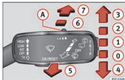
Fig. 32 Utilisation de l'essuie-glace avant et arrière.
