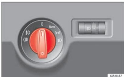
**Fig. 129** Tableau de bord : commande des feux.
