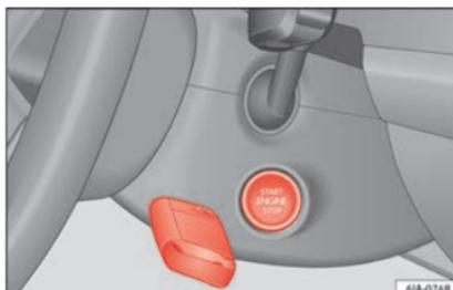
**Fig. 174** Démarrage d'urgence sur les véhicules équipés du système Keyless Access.
