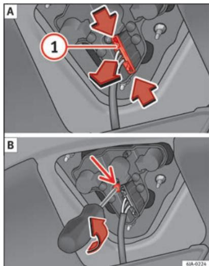
**Fig. 105** démonter le porte-ampoule.
