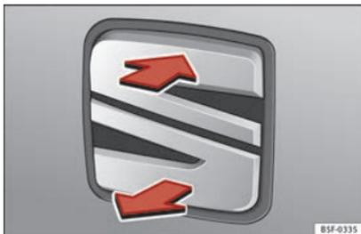
Fig. 126 Hayon : ouverture de l'extérieur.
