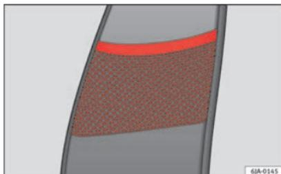
Fig. 157 Dossiers des sièges avant : filets.
