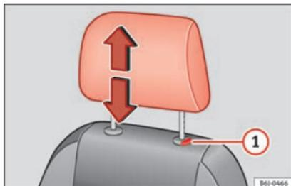
**Fig. 141** Appui-tête avant : réglage ou démontage.
