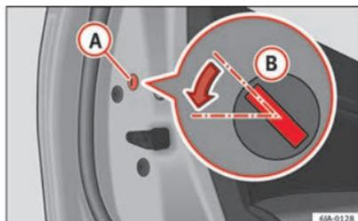
**Fig. 4** Porte arrière : verrouillage d'urgence.
