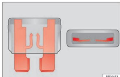
**Fig. 56** Représentation d'un fusible grillé.
