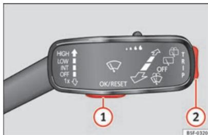
Fig. 35 Levier d'essuie-glace : touches de contrôle.
