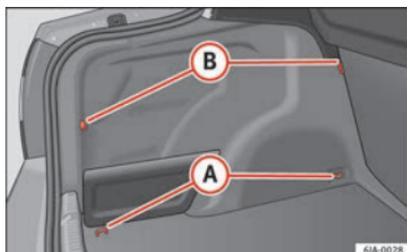
**Fig. 161** Coffre à bagages : éléments de fixation.
