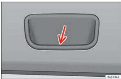
Fig. 127 Détail de la garniture intérieure du hayon : cavité pour tirer.
