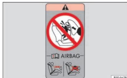
Fig. 23 Sur le cadre arrière de la porte du passager : autocollant concernant l'airbag.
