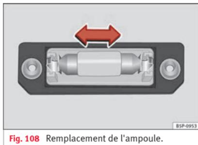
**Fig. 108** Remplacement de l'ampoule.
