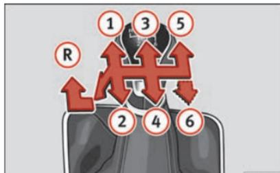
Fig. 176 Schéma d'une boîte mécanique 5 vitesses ou 6 vitesses.
