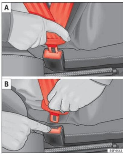
Fig. 11 Placer et retirer le pêne de verrouillage de la ceinture de sécurité.
