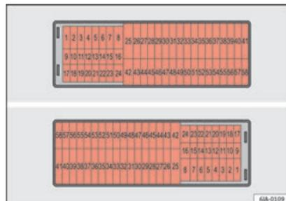
**Fig. 85** Vue schématisée du boîtier de fusibles à gauche/droite du volant.
