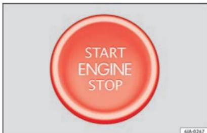
**Fig. 173** Sur la colonne de direction : bouton de démarrage du système de fermeture et démarrage sans clé Keyless Access. Sur les véhicules avec le volant à droite, le réglage est symétrique.
