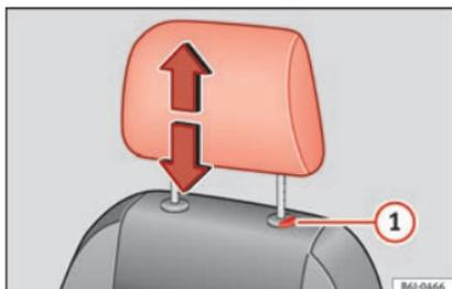
Fig. 10 Siège avant : réglage de l'appuie-tête.
