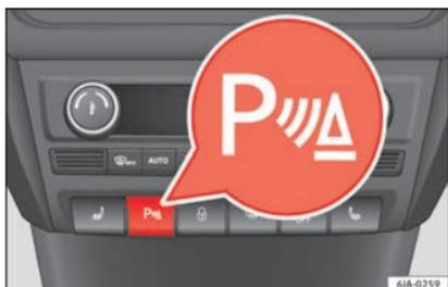
Fig. 182 Console centrale : touche de l'aide au stationnement.
