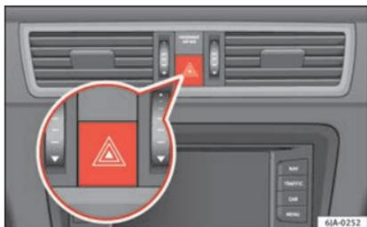
**Fig. 133** Tableau de bord : commande des feux de détresse.
