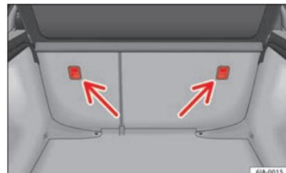
Fig. 25 Anneau de fixation Top Tether\*.
