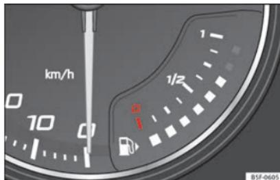
Fig. 112 Indicateur de carburant.
