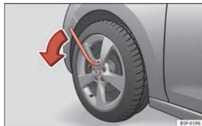
Fig. 62 Changement de roue : desserrer les vis de roue.
