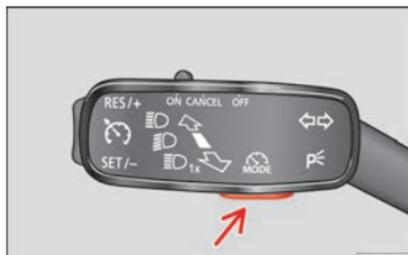
Fig. 191 Sur le levier des clignotants et des feux de route : touche des systèmes d'aide à la conduite.
