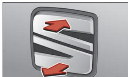
**Fig. 5** Hayon : ouverture de l'extérieur.
