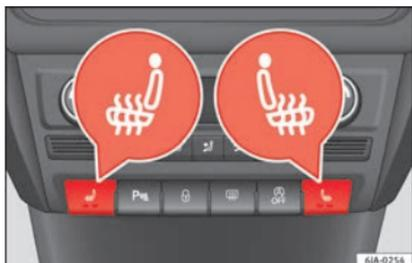
Fig. 143 Chauffage des sièges avant.
