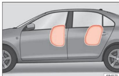
**Fig. 19** Airbags latéraux complètement gonflés du côté gauche du véhicule.
