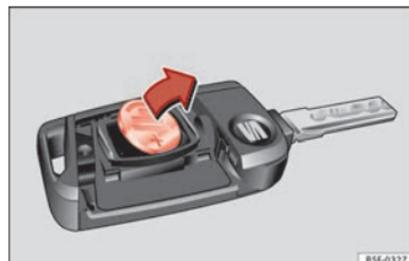
**Fig. 119** Clé du véhicule : retirez la pile.
