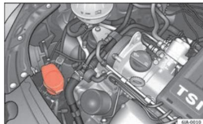
**Fig. 210** Compartiment-moteur : réservoir du système de liquide lave-glace.
