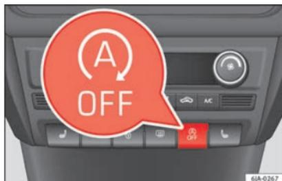
**Fig. 193** Tableau de bord : touche du système Start-Stop.
