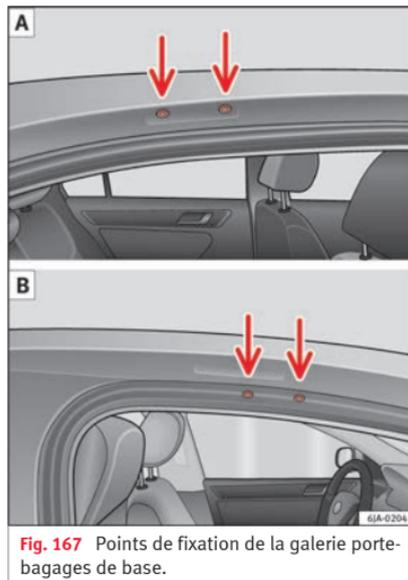
Fig. 167 Points de fixation de la galerie porte-bagages de base.
