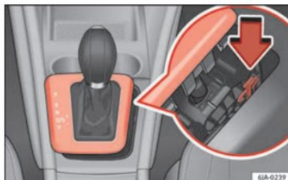
**Fig. 44** Déverrouillage d'urgence du levier sélecteur.
