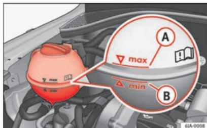
**Fig. 208** Compartiment-moteur : réservoir de liquide de refroidissement.
