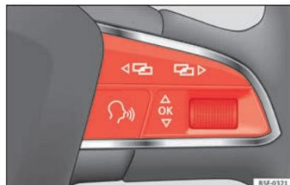
**Abb. 36** Rechte Seite Multifunktions-Lenkrad: Steuertasten.
