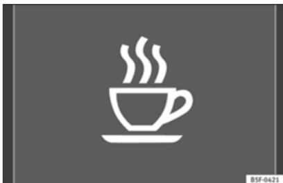
**Abb. 194** Im Display des Kombi-Instruments: Symbol der Müdigkeitserkennung.
