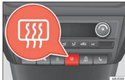
**Abb. 137** Schalter für Heckscheibenheizung
