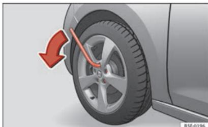
Abb. 62 Radwechsel: Radschrauben lockern
