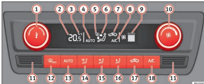
**Abb. 171** Climatronic: Bedienelemente
