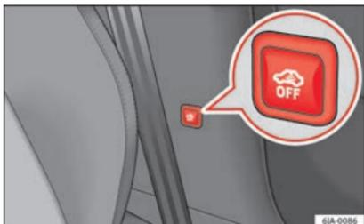
**Abb. 125** Taste der Innenraumüberwachung und des Abschleppschutzes.
