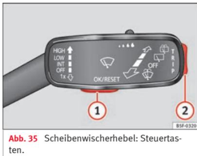
**Abb. 35** Scheibenwischerhebel: Steuertasten.
