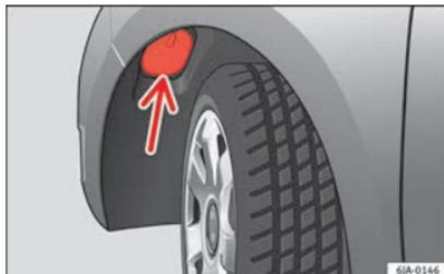
**Abb. 91** Lampe für Ablendlicht wechseln: Radkasten
