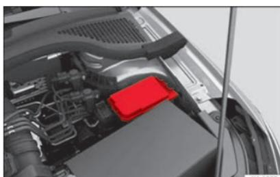
**Abb. 55** Im Motorraum: Abdeckung des Sicherungskastens.
