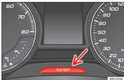
**Abb. 111** Kombi-Instrument: Kilometerzähler und Rückstelltaste.
