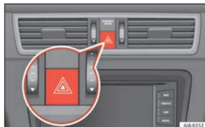
**Abb. 133** Kombiinstrument: Schalter für Warnblinkanlage
