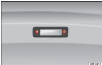
**Abb. 107** Ausbau der Kennzeichenleuchte
