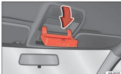
Abb. 156 Detail der Dachverkleidung: Brillenfach
