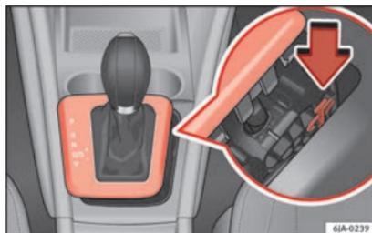
**Abb. 44** Notentriegeln der Wählhebelsperre
