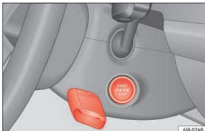
**Abb. 174** Notstart bei Fahrzeugen mit Keyless Access.
