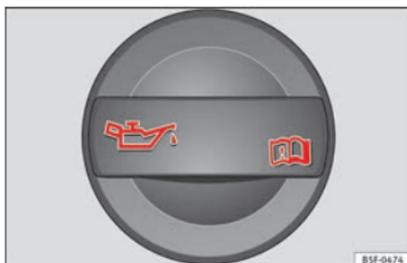
Abb. 50 Deckel der Motoröl-Einfüllöffnung im Motorraum
