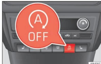
Abb. 193 Kombiinstrument: Taste für Start-Stop-System.
