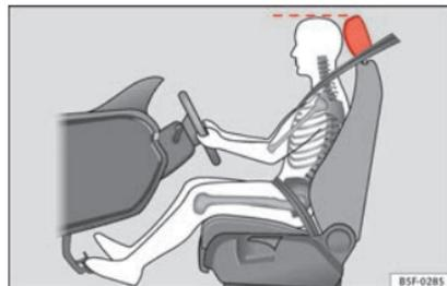
**Abb. 72** Die richtige Kopfstützeinstellung des Fahrers.
