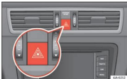
**Fig. 133** Painel de instrumentos: interruptor das luzes de emergência.
