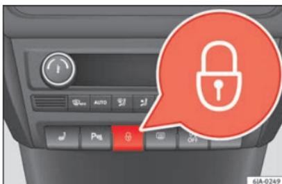
**Fig. 2** Consola central: interruptor do fecho centralizado.
