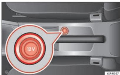
Fig. 154 Consola central: tomada de corrente 12 V.
