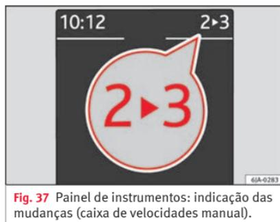
Fig. 37 Painel de instrumentos: indicação das mudanças (caixa de velocidades manual).
