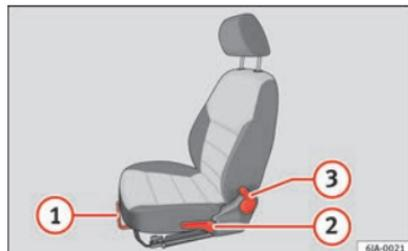
Fig. 9 Bancos dianteiros: ajuste manual do banco.
