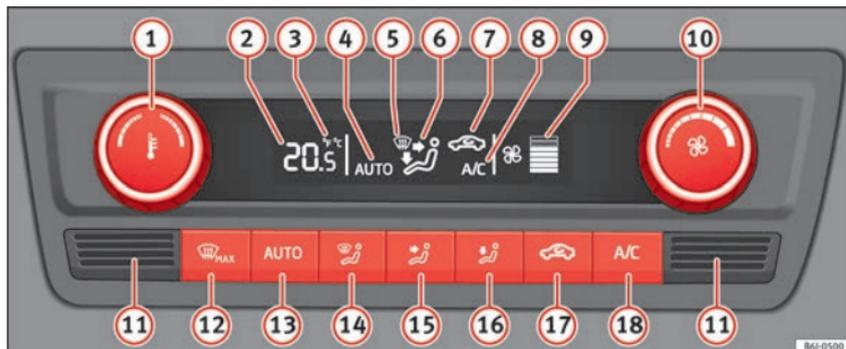
Fig. 171 Climatronic: elementos de utilização.
