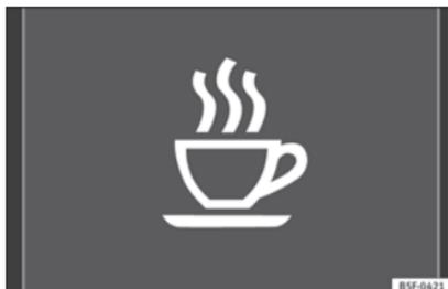
Fig. 194 Sul display del quadro strumenti: simbolo del riconoscimento della stanchezza del conducente.
