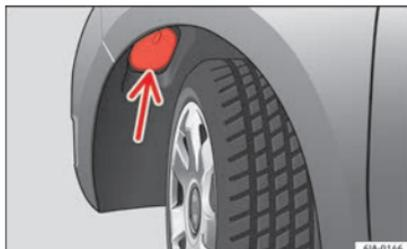
**Fig. 91** Sostituzione della lampadina delle luci anabbaglianti: passaruota.
