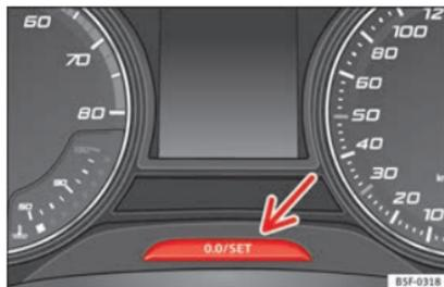
**Fig. 111** Quadro strumenti: contachilometri e tasto di azzeramento.
