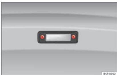
**Fig. 107** Smontare la luce della targa.
