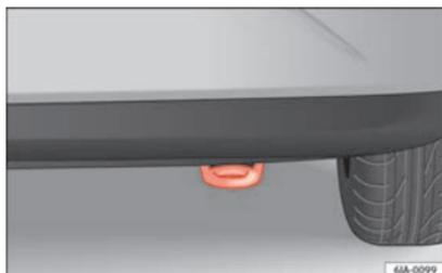
**Fig. 66** Paraurti posteriore destro: occhiello di traino.
