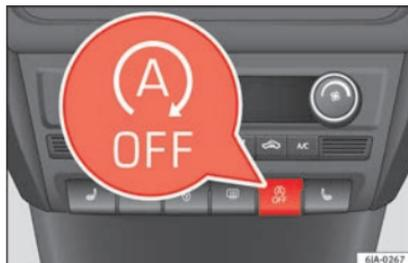
**Fig. 193** Quadro strumenti: tasto del sistema Start/Stop.
