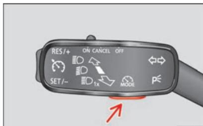
**Fig. 191** Sulla leva degli indicatori di direzione e degli abbaglianti: tasti per i sistemi di assistenza alla guida.
