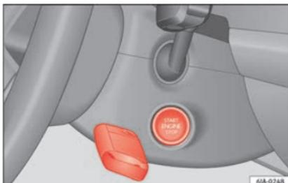
**Fig. 174** Avviamento di emergenza su veicoli con Keyless Access.
