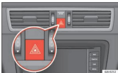
**Fig. 29** Plancia portastrumenti: interruttore lampeggio di emergenza.
