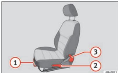
**Fig. 9** Sedili anteriori: regolazione manuale del sedile.
