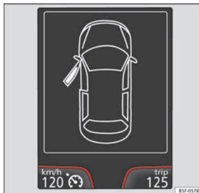
Fig. 41 Sul display del quadro strumenti: indicazione di porte aperte.
