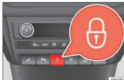
**Fig. 121** Interruttore della chiusura centralizzata.
