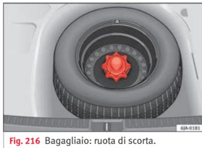
Fig. 216 Bagagliaio: ruota di scorta.
