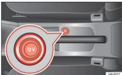
**Fig. 154** Consolle centrale: presa di corrente da 12 V.
