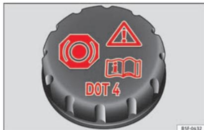
**Fig. 52** Vano motore: tappo del serbatoio del liquido dei freni.
