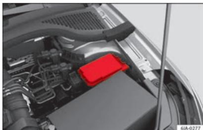
**Fig. 55** Nel vano motore: coperchio della scatola dei fusibili.
