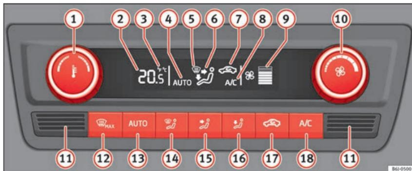
**Fig. 45** Sulla consola centrale: comandi del Climatronic.
