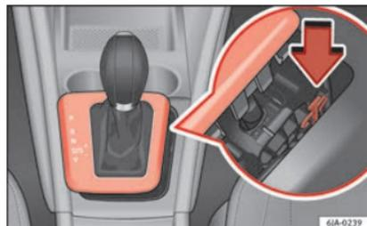
**Fig. 44** Sbloccaggio d'emergenza della leva selettoria.
