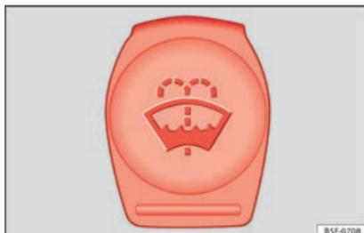
**Fig. 53** Nel vano motore: tappo del serbatoio del tergicristalli.
