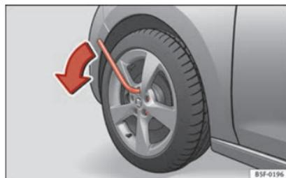
Fig. 62 Cambio di una ruota: allentare le viti della ruota.
