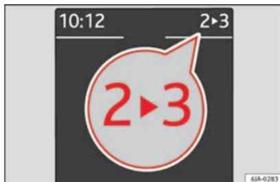
**Fig. 37** Quadro strumenti: Assistente cambio marce (cambio manuale).
