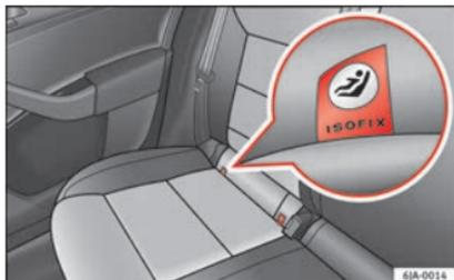
Fig. 24 Occhielli di fissaggio del sistema ISOFIX.
