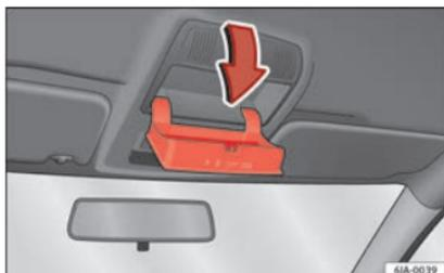
**Fig. 156** Un dettaglio del pannello del tetto: portaocchiali.
