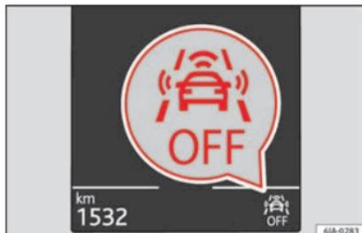
**Fig. 190** Sul display del quadro strumenti: indicazione di Front Assist disattivato.
