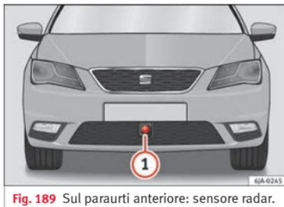
**Fig. 189** Sul paraurti anteriore: sensore radar.
