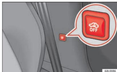
Fig. 125 Tasto dell'antifurto volumetrico e per il controllo del dispositivo antitraino.
