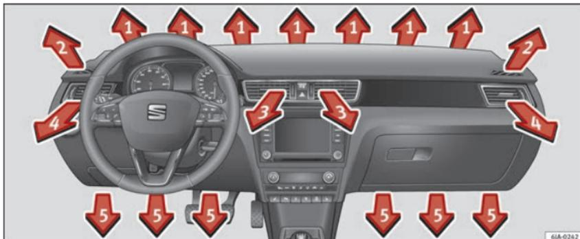
Fig. 168 Diffuseurs d'air.
