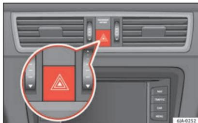
**Fig. 133** Combiné d'instruments : commande des feux de détresse.
