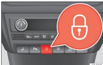
Fig. 2 Console centrale : commande de verrouillage centralisé.
