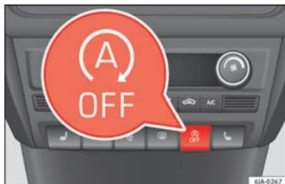
**Fig. 193** Combiné d'instruments : touche du système Start-Stop.
