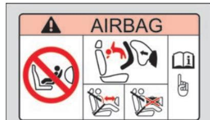
Fig. 22 Pare-soleil du côté du passager avant : autocollant de l'airbag.
