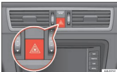
**Fig. 29** Planche de bord : commande des feux de détresse.
