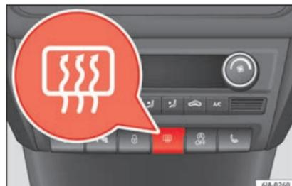
Fig. 137 Commande de dégivrage de la lunette arrière.
