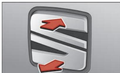
Fig. 5 Hayon : ouverture de l'extérieur.
