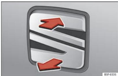
Fig. 126 Hayon : ouverture de l'extérieur.
