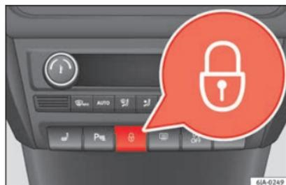
**Fig. 121** Touche de verrouillage centralisé.
