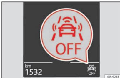
Fig. 190 Sur l'écran du combiné d'instruments : indication de Front Assist désactivé.
