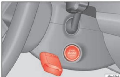
**Fig. 174** Démarrage d'urgence sur les véhicules équipés de Keyless Access.
