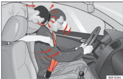
**Fig. 77** L'occupant de la banquette arrière non attaché est projeté en avant et vient heurter le conducteur attaché.
