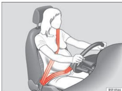
**Fig. 79** Ajustement recommandé de la sangle de ceinture de sécurité dans la zone des épaules et du bassin pour les femmes enceintes.
