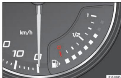
Fig. 112 Indicateur de carburant.
