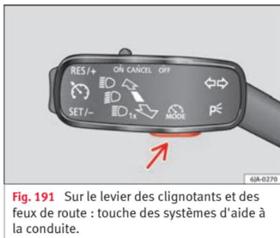
Fig. 191 Sur le levier des clignotants et des feux de route : touche des systèmes d'aide à la conduite.
