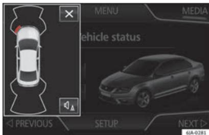
Fig. 183 Indication en miniature de l'activation automatique
