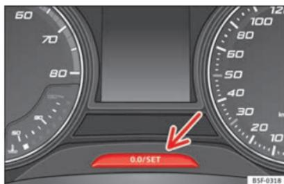
**Fig. 111** Combiné d'instruments : compteur kilométrique et touche de remise à zéro.
