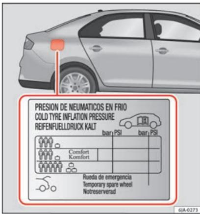
**Fig. 214** Emplacement de l'adhésif de gonflage des pneus.
