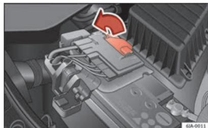
Fig. 211 Batterie : ouverture du cache.
