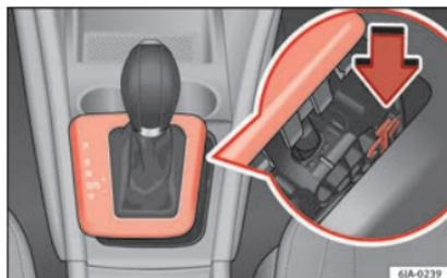
**Fig. 44** Déverrouillage d'urgence du levier sélecteur.
