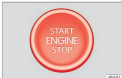
**Fig. 173** Sur la colonne de direction : bouton de démarrage du système de fermeture et de démarrage sans clé Keyless Access. Sur les véhicules avec le volant à droite, le réglage est symétrique.
