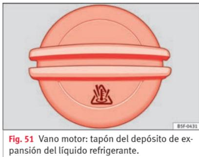
Fig. 51 Vano motor: tapón del depósito de expansión del líquido refrigerante.
