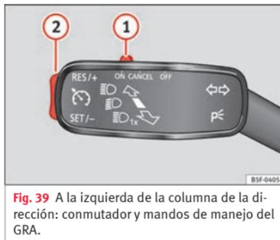
**Fig. 39** A la izquierda de la columna de la dirección: conmutador y mandos de manejo del GRA.
