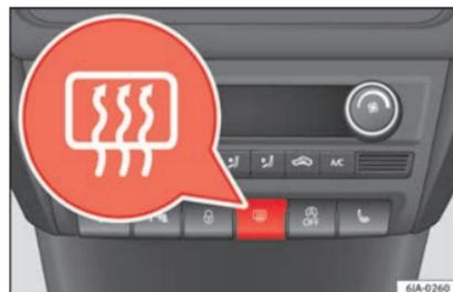
Fig. 137 Commutador de la luneta térmica.
