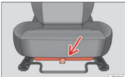
**Fig. 149** Asiento del conductor: portaobjetos.
