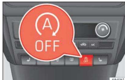
**Fig. 193** Cuadro de instrumentos: tecla del sistema Start-Stop.
