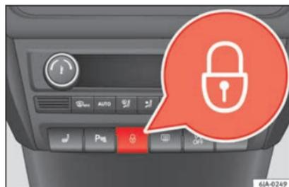
**Fig. 121** Pulsador del cierre centralizado.
