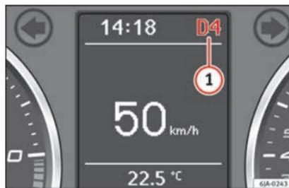
Fig. 178 Pantalla informativa: posiciones de la palanca selectora.
