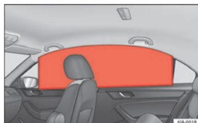
**Fig. 21** Airbags para la cabeza inflados.
