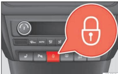
Fig. 2 Consola central: conmutador del cierre centralizado.
