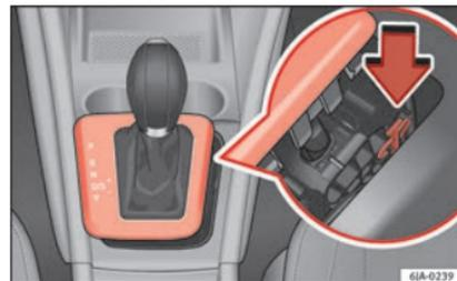
**Fig. 44** Desbloqueo de emergencia de la palanca selectora.
