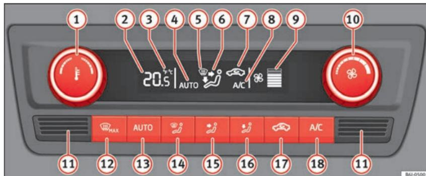
Fig. 45 En la consola central: mandos del Climatronic.
