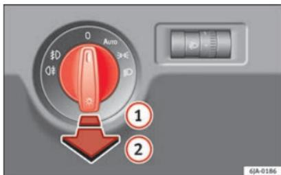
**Fig. 134** Quadro strumenti: interruttore delle luci.
