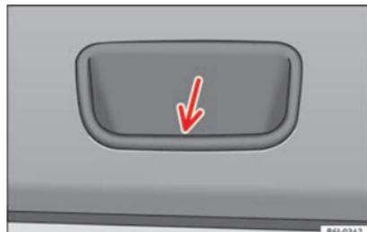
**Fig. 129** Dettaglio del rivestimento interno del portellone posteriore: maniglia di presa ad incavo.
