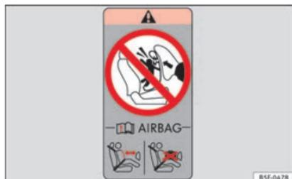
Fig. 23 Nella parte posteriore della porta del passeggero: adesivo relativo all'airbag.
