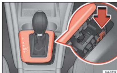
**Fig. 45** Sbloccaggio d'emergenza della leva selettoria.
