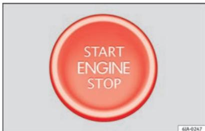
**Fig. 174** Sul piantone dello sterzo: pulsante di avviamento del sistema di chiusura e avviamento senza chiave Keyless Access. Nei veicoli con volante a destra, la disposizione è simmetrica.
