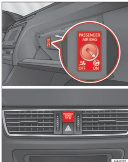
**Fig. 82** Commutatore dell'airbag frontale del passeggero anteriore/spia di disattivazione dell'airbag del passeggero anteriore.
