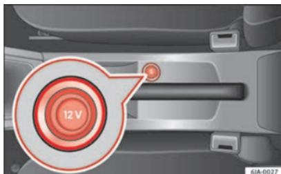
Fig. 156 Consolle centrale: presa di corrente da 12 V.
