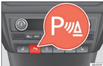
**Fig. 183** Consolle centrale: tasto dell'assistenza per il parcheggio.
