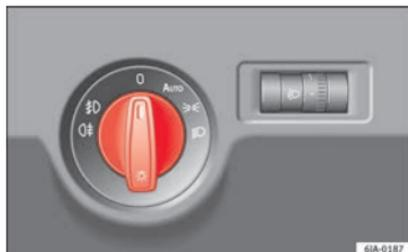
**Fig. 131** Quadro strumenti: interruttore delle luci.
