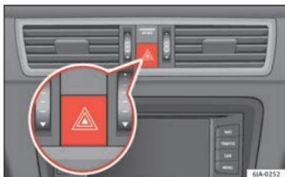
**Fig. 29** Plancia portastrumenti: interruttore lampeggio di emergenza.
