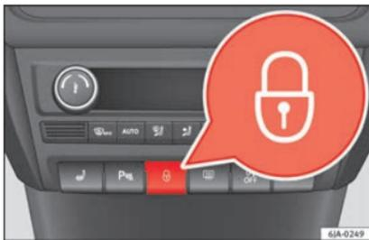
Fig. 2 Consolle centrale: interruttore della chiusura centralizzata.
