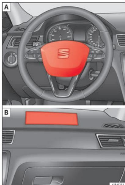
**Fig. 15** Airbag del conducente nel volante e airbag del passeggero nel cruscotto.
