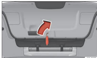
**Fig. 6** Particolare del bagagliaio: accesso al dispositivo di sblocco di emergenza.
