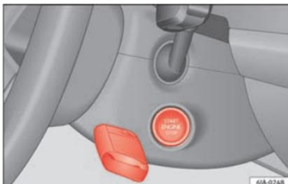
**Fig. 175** Avviamento di emergenza su veicoli con Keyless Access.
