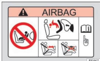
Fig. 22 Aletta parasole lato passeggero: adesivo dell'airbag.
