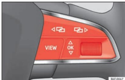
**Fig. 36** Lato destro del volante multifunzionale: tasti di controllo.
