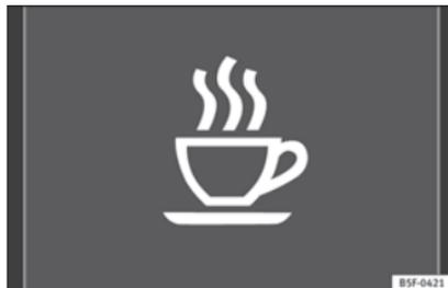
**Fig. 193** Sul display del quadro strumenti: simbolo del riconoscimento della stanchezza del conducente.
