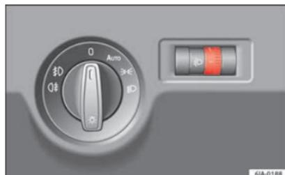
**Fig. 132** Quadro strumenti: regolazione della profondità dei fari.
