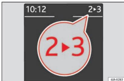
**Fig. 38** Quadro strumenti: Assistente cambio marce (cambio manuale).
