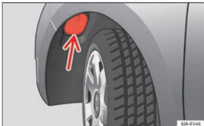
**Fig. 92** Sostituzione della lampadina delle luci anabbaglianti: passaruote.
