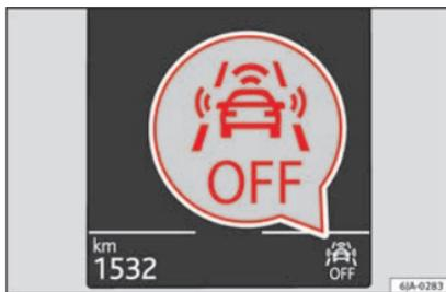
Fig. 191 Sul display del quadro strumenti: indicazione di Front Assist disattivato.
