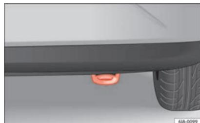
**Fig. 67** Paraurti posteriore destro: occhiello di traino.
