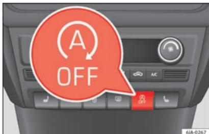
**Fig. 192** Quadro strumenti: tasto del sistema Start/Stop.
