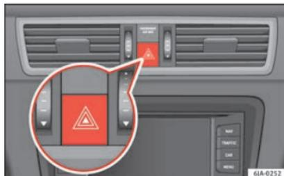
**Fig. 135** Quadro strumenti: interruttore lampeggio di emergenza.
