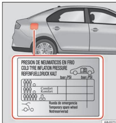
Fig. 213 Posizione dell'adesivo della pressione di gonfiaggio comfort degli pneumatici.
