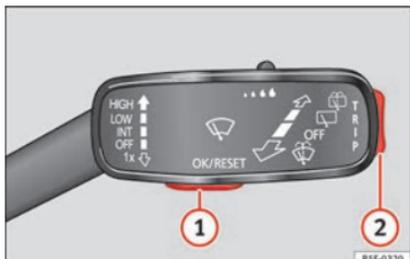
**Fig. 35** Leva dell'impianto tergicristalli tasti di controllo.
