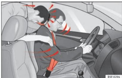
**Fig. 78** L'occupant de la banquette arrière non attaché est projeté en avant et vient heurter le conducteur attaché.
