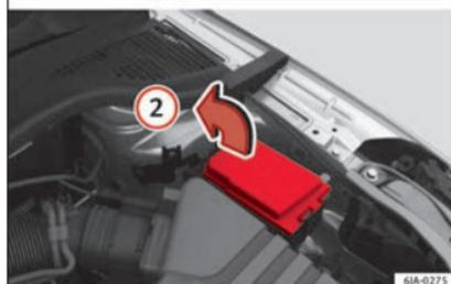
**Fig. 88** Dans le compartiment moteur : cache du boîtier de fusibles - Variante 2
