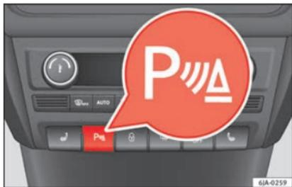
**Fig. 183** Console centrale : touche de l'aide au stationnement.
