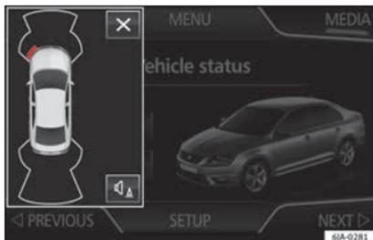
Fig. 184 Indication en miniature de l'activation automatique
