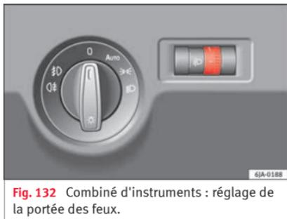
**Fig. 132** Combiné d'instruments : réglage de la portée des feux.
