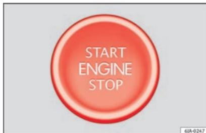
**Fig. 174** Sur la colonne de direction : bouton de démarrage du système de fermeture et de démarrage sans clé Keyless Access. Sur les véhicules avec le volant à droite, le réglage est symétrique.
