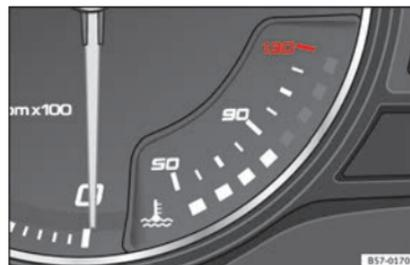
**Fig. 113** Combiné d'instruments : indicateur de température du liquide de refroidissement
