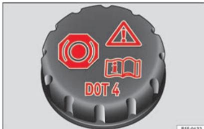
**Fig. 53** Compartiment-moteur : bouchon du réservoir du liquide de frein.
