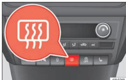
**Fig. 139** Commande de dégivrage de la lunette arrière.
