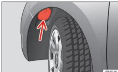
**Fig. 92** Remplacement de l'ampoule des feux de croisement : ailes des roues.
