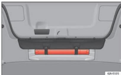
Fig. 83 Emplacement du triangle de signalisation.
