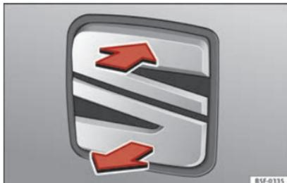
Fig. 128 Hayon : ouverture de l'extérieur.
