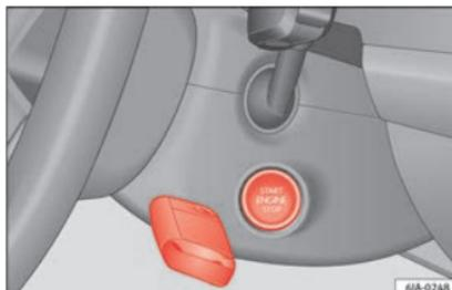
**Fig. 175** Démarrage d'urgence sur les véhicules équipés de Keyless Access.
