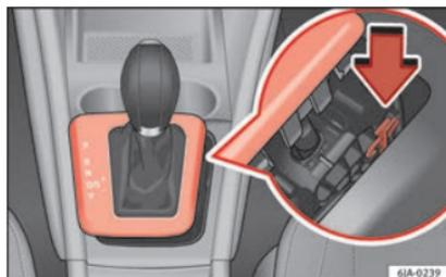
**Fig. 45** Déverrouillage d'urgence du levier sélecteur.
