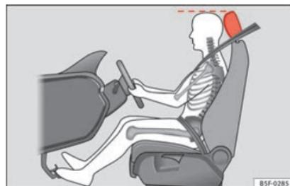
**Fig. 73** Position correcte de l'appuie-tête du conducteur
