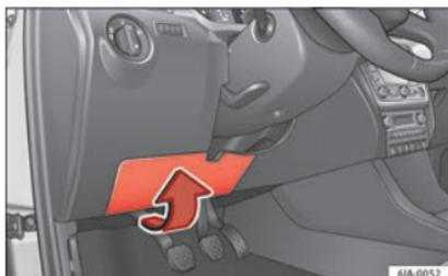
**Fig. 55** Sur le tableau de bord côté conducteur : cache du boîtier de fusibles.
