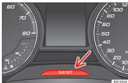
**Fig. 112** Combiné d'instruments : compteur kilométrique et touche de remise à zéro.
