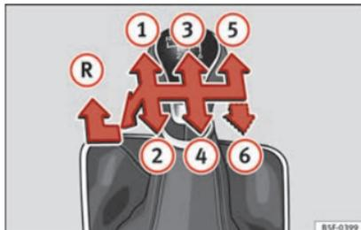
**Fig. 43** Schéma d'une boîte mécanique 5 vitesses ou 6 vitesses.
