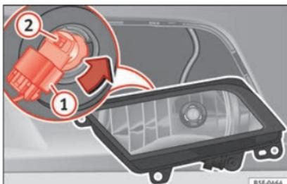
**Fig. 97** Phare antibrouillard : démonter le support d'ampoules.
