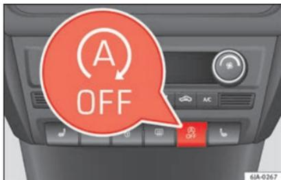
**Fig. 192** Combiné d'instruments : touche du système Start-Stop.
