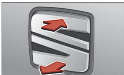
Fig. 5 Hayon : ouverture de l'extérieur.
