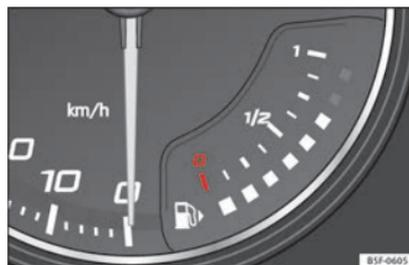
Fig. 114 Indicateur de carburant.
