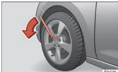
Fig. 63 Changement de roue : desserrer les vis de roue.
