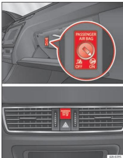
**Fig. 82** Commande de l'airbag frontal du passager avant/témoin de désactivation de l'airbag passager
