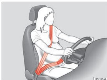
**Fig. 80** Ajustement recommandé de la sangle de ceinture de sécurité dans la zone des épaules et du bassin pour les femmes enceintes.
