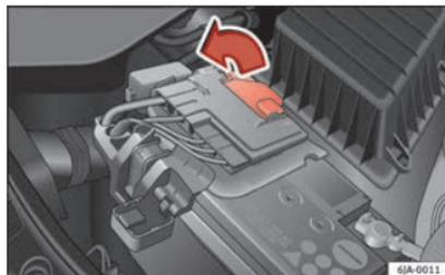
Fig. 210 Batería: apertura de la cubierta.
