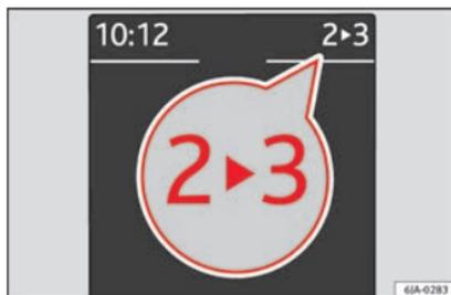
Fig. 38 Cuadro de instrumentos: indicación de las marchas (cambio manual).
