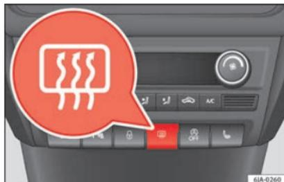
Fig. 139 Conmutador de la luneta térmica.
