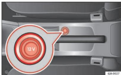
**Fig. 156** Consola central: toma de corriente 12 V.
