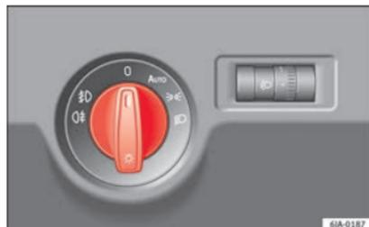
**Fig. 131** Cuadro de instrumentos: mando de las luces.
