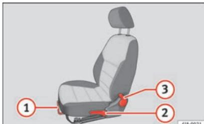
**Fig. 9** Asientos delanteros: ajuste manual del asiento.
