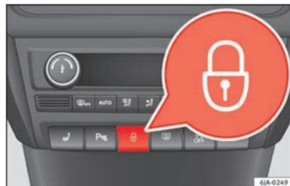
Fig. 123 Pulsador del cierre centralizado.
