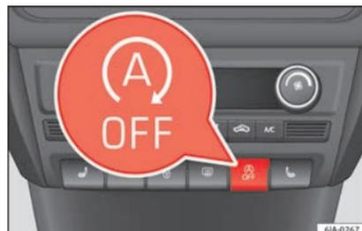
**Fig. 192** Cuadro de instrumentos: tecla del sistema Start-Stop.
