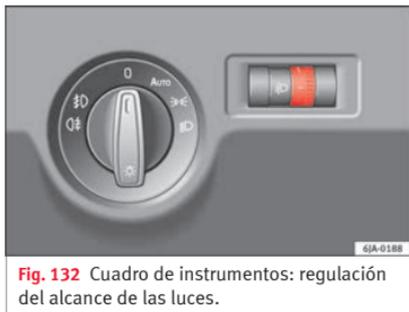
**Fig. 132** Cuadro de instrumentos: regulación del alcance de las luces.
