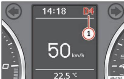
Fig. 179 Pantalla informativa: posiciones de la palanca selector.
