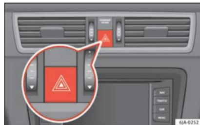
**Fig. 135** Cuadro de instrumentos: conmutador de los intermitentes de emergencia.
