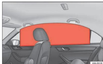
Fig. 21 Airbags para la cabeza inflados.
