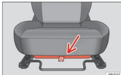
Fig. 151 Asiento del conductor: portaobjetos. »
