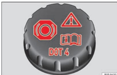
Fig. 53 Vano motor: tapón del depósito del líquido de frenos.
