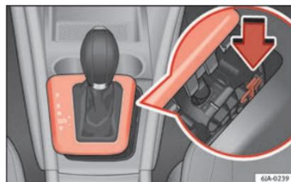
**Fig. 45** Desbloqueo de emergencia de la palanca selectora.
