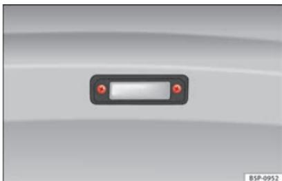
**Abb. 107** Ausbau der Kennzeichenleuchte
