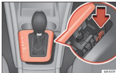
Abb. 45 Notentriegeln der Wählhebelsperre
