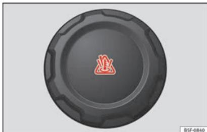
**Abb. 52** Motorraum: Deckel des Motorkühlmittelausgleichsbehälters
