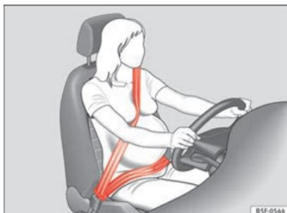
**Abb. 80** Gurtbandverlauf im Brust- und Beckenbereich und bei schwangeren Frauen.
