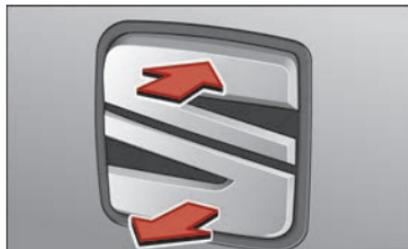
**Abb. 5** Heckklappe: Öffnen von außen
