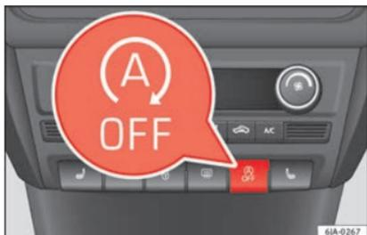
**Abb. 192** Kombiinstrument: Taste für Start-Stopp-System.
