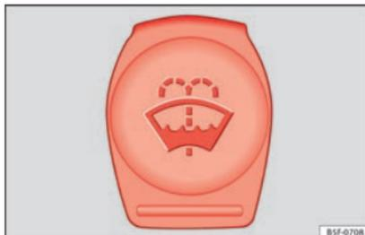
**Abb. 54** Im Motorraum: Deckel des Scheibenwaschbehälters.
