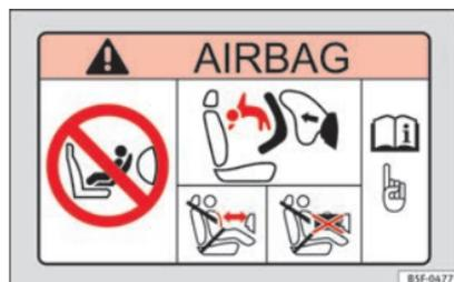
Abb. 22 Sonnenblende auf der Beifahrerseite: Airbagaufkleber.
