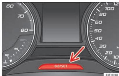
**Abb. 112** Kombi-Instrument: Kilometerzähler und Rücksteltaste.
