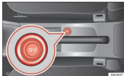
Abb. 156 Mittelkonsole: 12-Volt-Steckdose
