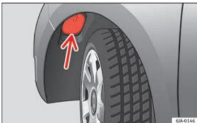
**Abb. 92** Lampe für Ablendlicht wechseln: Radkasten
