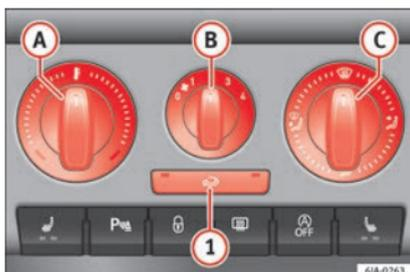
**Abb. 48** Mittelkonsole: Systembedienungen für Heiz- und Frischluft
