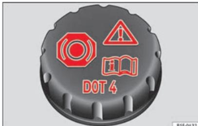
**Abb. 53** Motorraum: Deckel des Bremsflüssigkeitsbehälters
