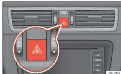
**Abb. 135** Kombiinstrument: Schalter für Warnblinkanlage
