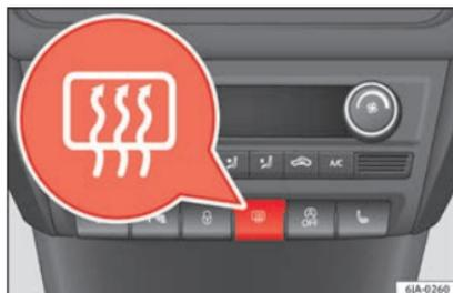
Abb. 139 Schalter für Heckscheibenbeheizung
