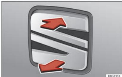
Abb. 128 Heckklappe: Öffnen von außen
