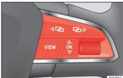
**Abb. 36** Rechte Seite Multifunktions-Lenkrad: Steuertasten.
