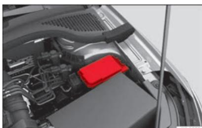
**Abb. 56** Im Motorraum: Abdeckung des Sicherungskastens.
