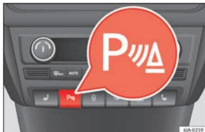
**Abb. 183** Mittelkonsole: Taste für Einparkhilfe.
