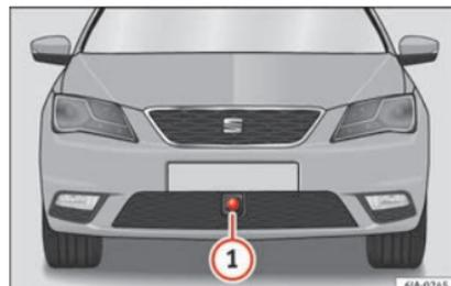
Abb. 190 Im vorderen Stoßfänger: Radarsensor.
