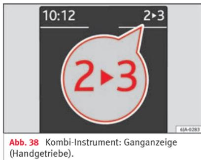
**Abb. 38** Kombi-Instrument: Ganganzeige (Handgetriebe).
