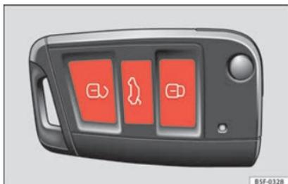
Abb. 1 Funkschlüssel: Tasten
