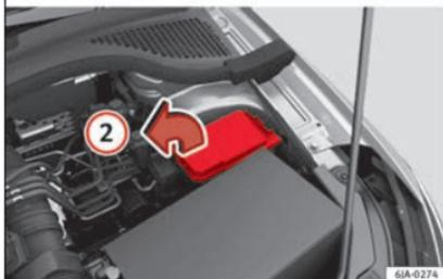
**Abb. 87** Im Motorraum: Abdeckung des Sicherungskastens - Variante 1
