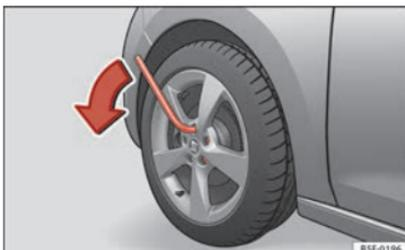
Abb. 63 Radwechsel: Radschrauben lockern
