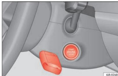
**Abb. 175** Notstart bei Fahrzeugen mit Keyless Access.
