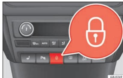
Abb. 123 Taster für Zentralverriegelung
