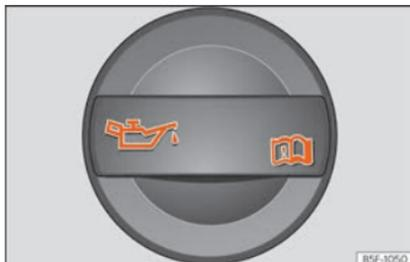
Fig. 51 Vano motore: tappo del bocchettone di rifornimento dell'olio motore.
