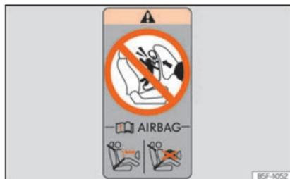
**Fig. 26** Nella parte posteriore della porta del passeggero: adesivo relativo all'airbag.
