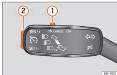
**Fig. 42** A sinistra del piantone dello sterzo: interruttori e comandi per l'uso del GRA.
