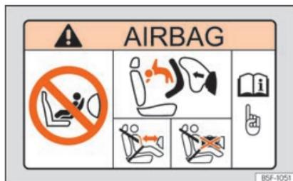
**Fig. 25** Aletta parasole lato passeggero: adesivo dell'airbag.
