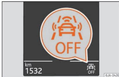
**Fig. 225** Sul display del quadro strumenti: indicazione di Front Assist disattivato.
