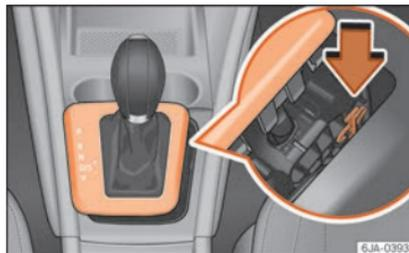
**Fig. 45** Sbloccaggio d'emergenza della leva selettoria.
