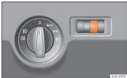
**Fig. 130** Quadro strumenti: regolazione della profondità dei fari.
