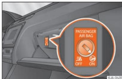
**Fig. 20** Commutatore dell'airbag frontale del passeggero.
