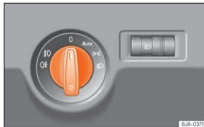
**Fig. 129** Quadro strumenti: interruttore delle luci.
