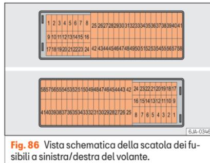
**Fig. 86** Vista schematica della scatola dei fusibili a sinistra/destra del volante.
