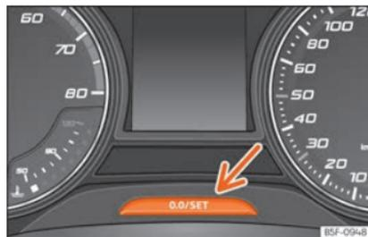
**Fig. 112** Quadro strumenti: contachilometri e tasto di azzeramento.
