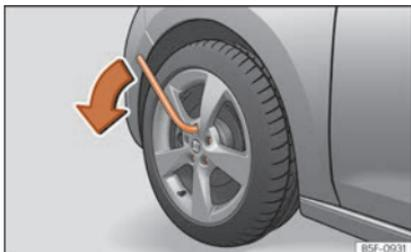
**Fig. 63** Cambio di una ruota: allentare le viti della ruota.
