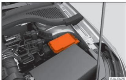
**Fig. 56** Nel vano motore: coperchio della scatola dei fusibili.
