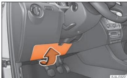
**Fig. 55** Sul cruscotto, lato del conducente: coperchio della scatola dei fusibili.
