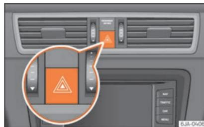
**Fig. 133** Quadro strumenti: interruttore lampeggio di emergenza.
