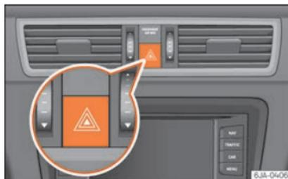
**Fig. 32** Plancia portastrumenti: interruttore lampeggio di emergenza.
