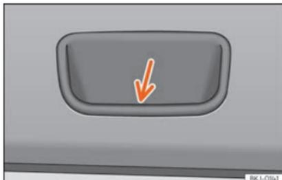
**Fig. 127** Dettaglio del rivestimento interno del portellone posteriore: maniglia di presa ad incavo.
