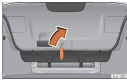
**Fig. 8** Particolare del bagagliaio: accesso al dispositivo di sblocco di emergenza.
