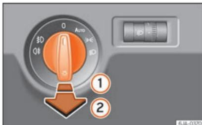
**Fig. 132** Quadro strumenti: interruttore delle luci.
