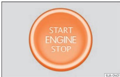
**Fig. 212** Sul piantone dello sterzo: pulsante di avviamento del sistema di chiusura e avviamento senza chiave Keyless Access. Nei veicoli con volante a destra, la disposizione è simmetrica.
