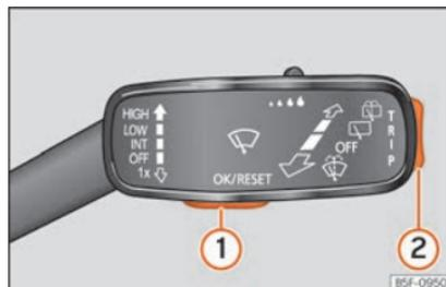
**Fig. 38** Leva dell'impianto tergicristalli tasti di controllo.
