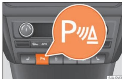
Fig. 227 Console centrale: tasto dell'assistenza per il parcheggio.
