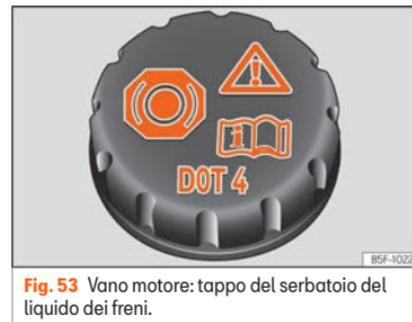
**Fig. 53** Vano motore: tappo del serbatoio del liquido dei freni.
