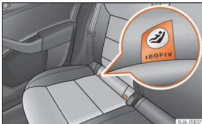
**Fig. 27** Occhielli di fissaggio del sistema ISO-FIX.
