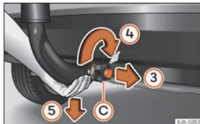
**Fig. 240** Sbloccare la barra a testa sferica.
