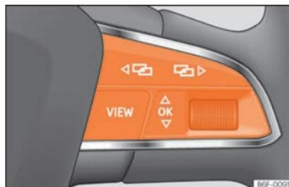
**Fig. 39** Lato destro del volante multifunzionale: tasti di controllo.
