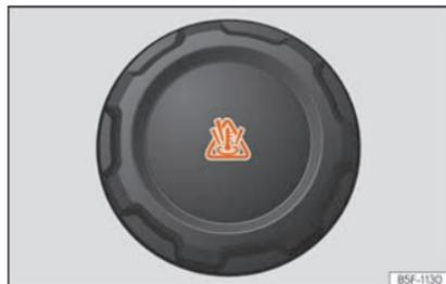
**Fig. 52** Vano motore: tappo del serbatoio di compensazione del liquido di raffreddamento.
