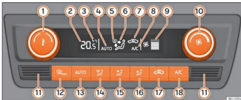
**Fig. 46** Sulla console centrale: comandi del Climatronic.
