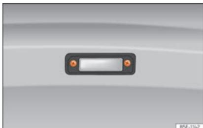
**Fig. 108** Smontare la luce della targa.
