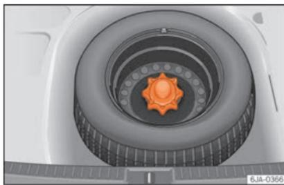
Fig. 253 Bagagliaio: ruota di scorta.
