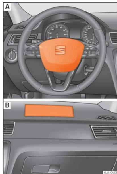
**Fig. 18** Airbag del conducente nel volante e airbag del passeggero nel cruscotto.
