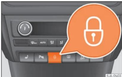
**Fig. 4** Console centrale: interruttore della chiusura centralizzata.
