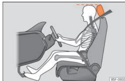
**Fig. 73** Corretto posizionamento del poggiatesta del conducente.
