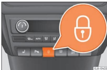
**Fig. 122** Interruttore della chiusura centralizzata.
