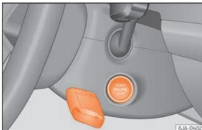
**Fig. 213** Avviamento di emergenza su veicoli con Keyless Access.
