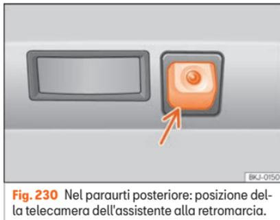
**Fig. 230** Nel paraurti posteriore; posizione della telecamera dell'assistente alla retromarcia.
