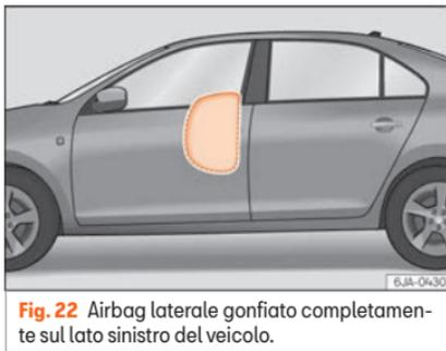
**Fig. 22** Airbag laterale gonfiato completamente sul lato sinistro del veicolo.
