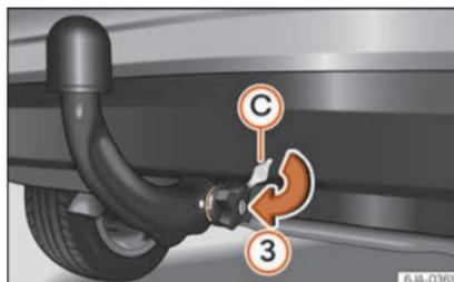
**Fig. 237** Posizionamento del coperchio della serratura.
