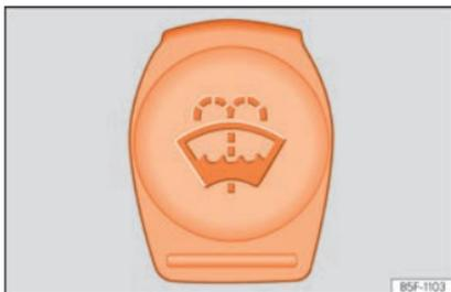
**Fig. 54** Nel vano motore: tappo del serbatoio del tergicristalli.
