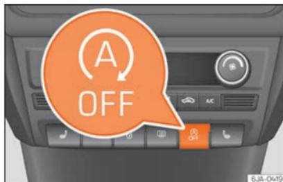
**Fig. 221** Quadro strumenti: tasto del sistema Start/Stop.
