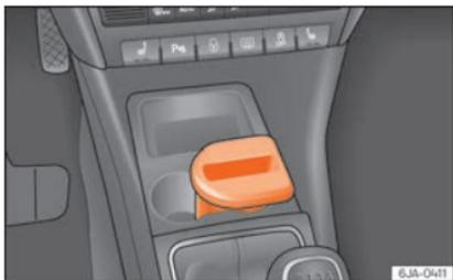
**Fig. 155** Console centrale anteriore: vano multimedia.
