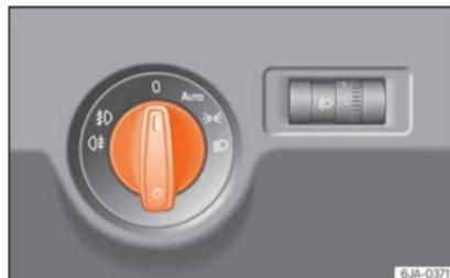
**Fig. 129** Cuadro de instrumentos: mando de las luces.
