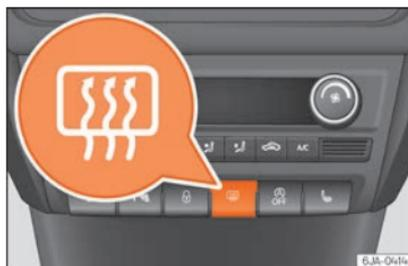
Fig. 137 Conmutador de la luneta térmica.
