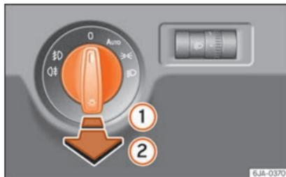
**Fig. 132** Cuadro de instrumentos: mando de luces.
