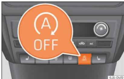
**Fig. 221** Cuadro de instrumentos: tecla del sistema Start-Stop.
