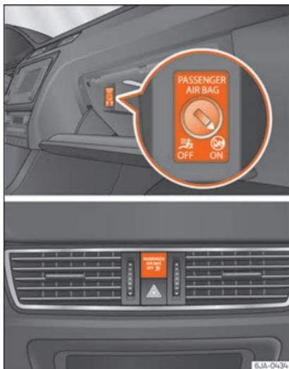
**Fig. 82** Comutador del airbag frontal del acompañante/testigo para desconexión de airbag del acompañante.
