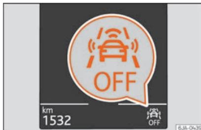
**Fig. 225** En la pantalla del cuadro de instrumentos: indicación de Front Assist desactivado.
