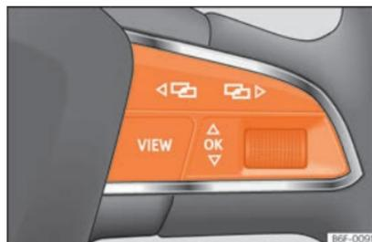
**Fig. 39** Lado derecho del volante multifunción: teclas de control.
