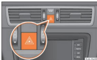
**Fig. 32** Tablero de instrumentos: conmutador de los intermitentes de emergencia.
