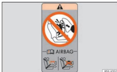
Fig. 26 En el marco posterior de la puerta del acompañante: adhesivo relativo al airbag.
