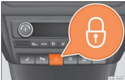
Fig. 4 Consola central: conmutador del cierre centralizado.
