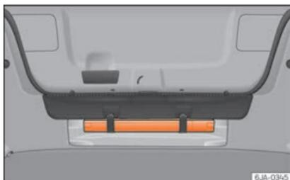
**Fig. 83** Emplazamiento del triángulo de preseñalización.
