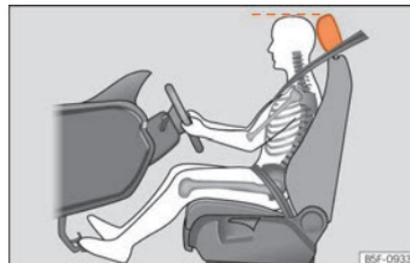
**Fig. 73** Posición correcta del apoyacabezas del conductor.
