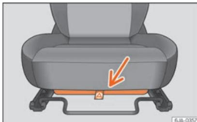
Fig. 149 Asiento del conductor: portaobjetos.
