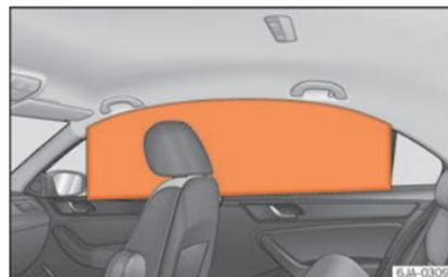
**Fig. 24** Airbags para la cabeza inflados.
