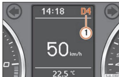
**Fig. 217** Pantalla informativa: posiciones de la palanca selectora.
