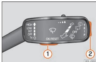
**Fig. 38** Palanca del limpiaparabrisas: teclas de control.
