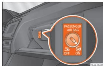
**Fig. 20** Conmutador del airbag frontal del acompañante.
