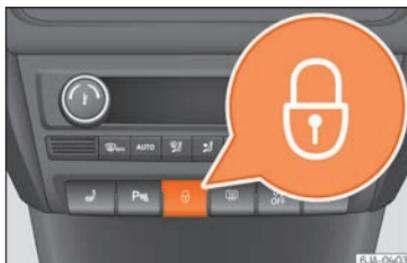
**Fig. 122** Pulsador del cierre centralizado.
