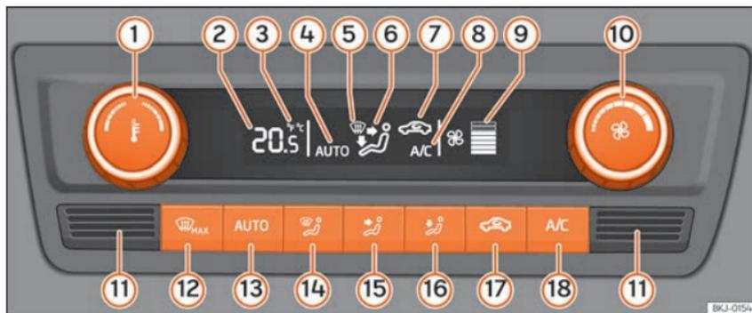
Fig. 170 Climatronic: elementos de manejo.
