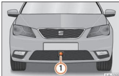
**Fig. 224** En el paragolpes delantero: sensor de radar.
