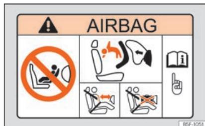
Fig. 25 Parasol del lado del acompañante: adhesivo del airbag.
