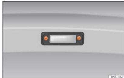
**Fig. 108** Desmontaje de la iluminación placa matrícula.
