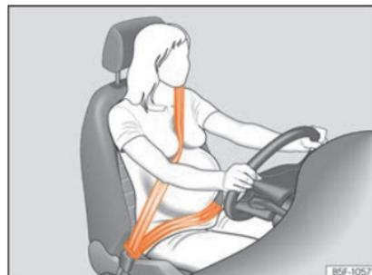
**Fig. 80** Colocación de la banda del cinturón en la zona de los hombros y la pelvis y en el caso de mujeres embarazadas.
