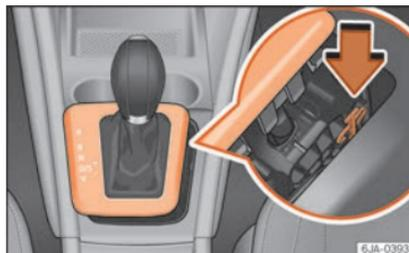
**Fig. 45** Desbloqueo de emergencia de la palanca selectora.
