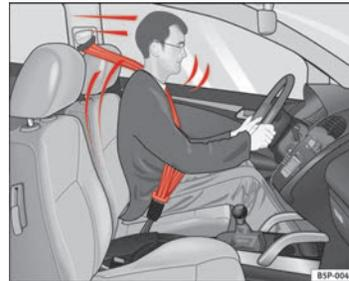
Fig. 41 I conducenti che hanno la cintura di sicurezza correttamente allacciata non saranno proiettati fuori dal veicolo in caso di frenate repentine.
