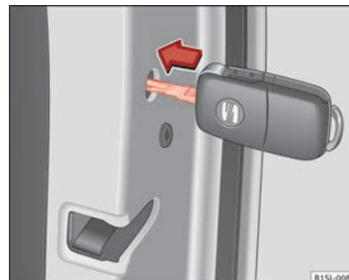
**Fig. 129** Blocco di emergenza del veicolo con la chiave.
