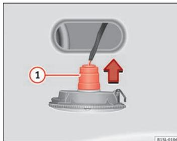
Fig. 153 Indicatore di direzione laterale: sostituzione delle lampadine
