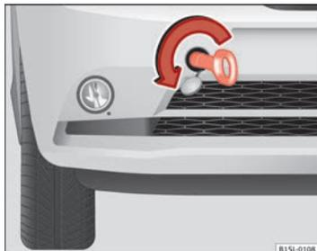
Fig. 157 Nella parte destra del paraurti anteriore: Avvitare l'occhiello di traino.
