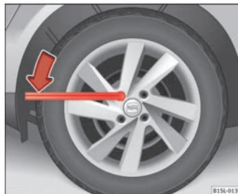
Fig. 136 Cambio di una ruota: allentare i bulloni della ruota.
