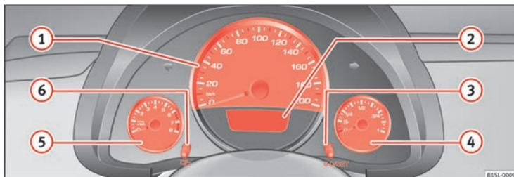
Fig. 10 Quadro strumenti, nella plancia: versione 2
