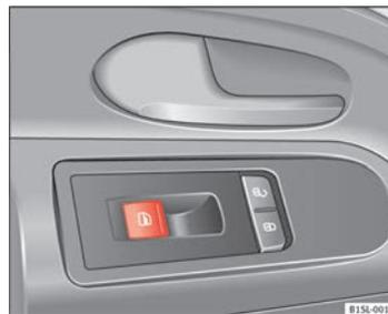
Fig. 24 Nella porta del conducente: tasti per gli alzacristalli elettrici
