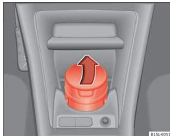
Fig. 80 Nella parte anteriore della console centrale: Come aprire il posacenere
