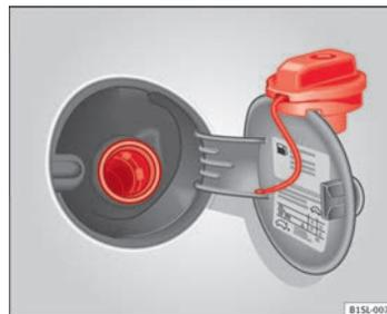
**Fig. 103 Sportellino del serbatoio del carburante aperto e utilizzato come supporto per il tappo.**
