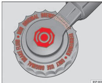
Fig. 87 Nel vano motore: tappo del serbatoio del liquido dei freni
