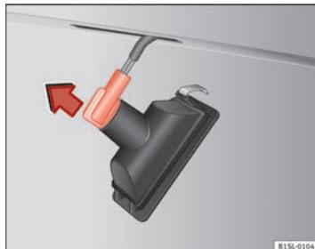
Fig. 151 Luce targa: Smontaggio del portalampana
