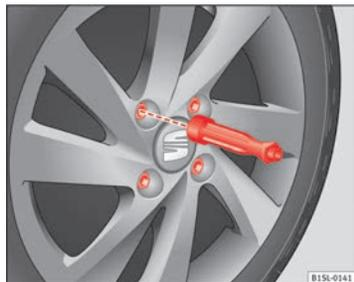
Fig. 140 Cambio di una ruota: allentare i bulloni della ruota con l'impugnatura del cacciavite.
