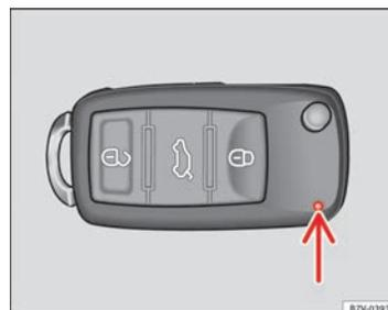
Fig. 14 Spia di controllo nella chiave del veicolo
