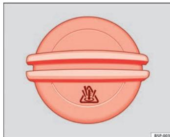
Fig. 109 Nel vano motore: Tappo del serbatoio di compensazione del liquido di raffreddamento
