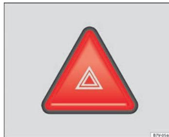
Fig. 125 Plancia porta-strumenti: Tasto di accensione e spegnimento del lampeggio d'emergenza
