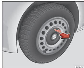
Fig. 133 Rimozione dei copricerchi del cerchio in acciaio
