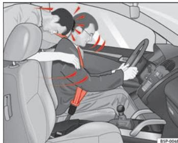
Fig. 40 Non indossando la cintura, il passeggero seduto sul sedile posteriore viene scagliato in avanti, colpendo il conducente (che invece indossa la cintura)
