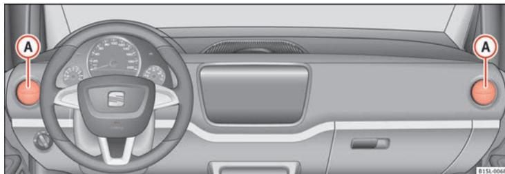
Fig. 100 Plancia portastrumenti: Bocchette di ventilazione
