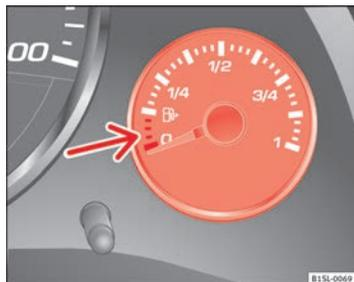
Fig. 101 Nel quadro strumenti: indicatore del livello del carburante per benzina.
