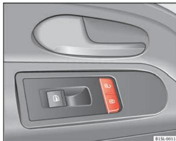
Fig. 19 Nella porta del conducente: pulsante della chiusura centralizzata
