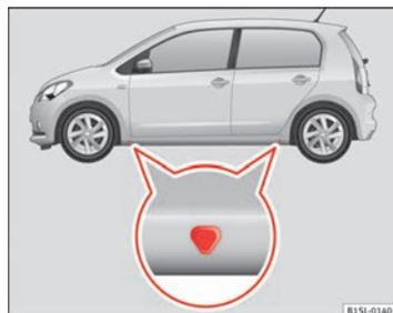
Fig. 138 Punti di appoggio per il cric.
