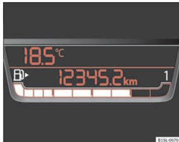
Fig. 102 Display del quadro strumenti: indicatore del livello del carburante per benzina.
