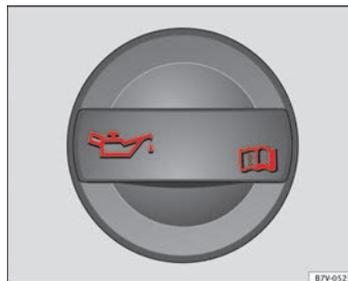
Fig. 107 Nel vano motore: Tappo di rabbocco dell'olio motore. ▶
