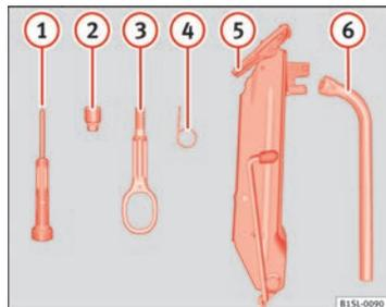
Fig. 132 Componenti del set degli attrezzi di bordo.
