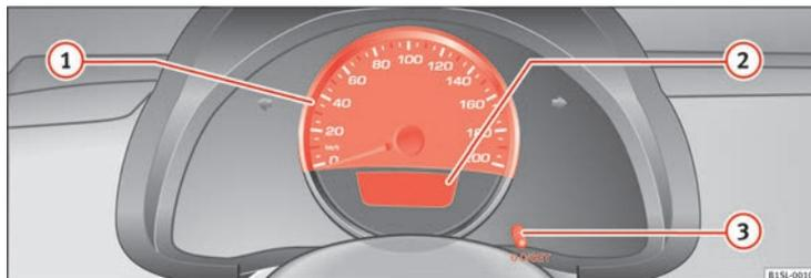
Fig. 9 Quadro strumenti, nella plancia: versione 1
