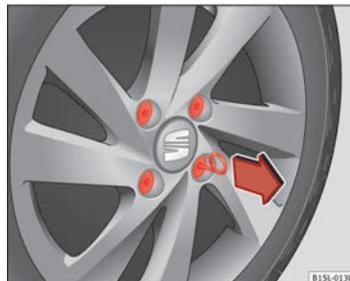
Fig. 135 Rimuovere i cappucci dai bulloni della ruota.
