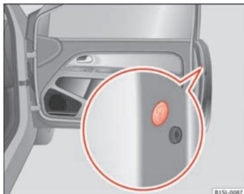
**Fig. 128** Nella parte anteriore della porta del passeggero: Blocco di emergenza, nascosto da una guarnizione di gomma.
