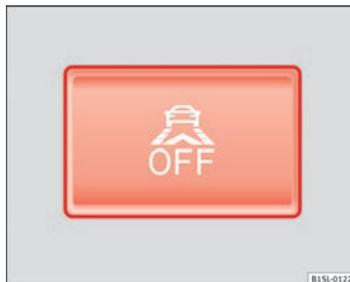
Fig. 94 Nella parte inferiore della console centrale: tasto per la funzione di frenata di emergenza City
