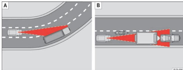
Fig. 95 A: Vehículo en una curva. B: Motociclista circulando por delante fuera del radio de acción del sensor de láser.
