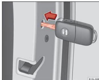
**Fig. 129** Bloqueo de emergencia del vehículo con la llave del vehículo.
