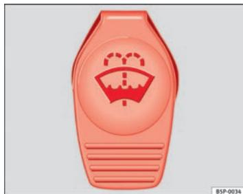
Fig. 63 En el vano motor: tapón del depósito del lavacrystales.
