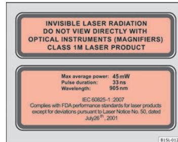
Fig. 124 Advertencias relativas al manejo del sensor de láser de la función de Asistencia de frenada en ciudad.
