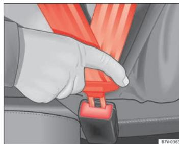
Fig. 42 Inserte la lengüeta del cinturón de seguridad en el cierre.
