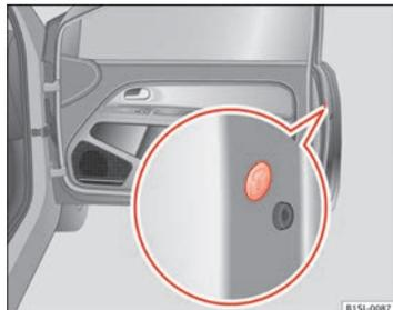
**Fig. 128** En la parte frontal de la puerta del acompañante: Bloqueo de emergencia, oculto por una junta de goma.
