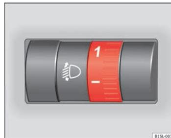
Fig. 57 Al lado del volante: Regulador del alcance de las luces.
