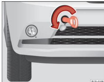
Fig. 157 En la parte derecha del parachoques delantero: Enroscar la argolla de remolque.
