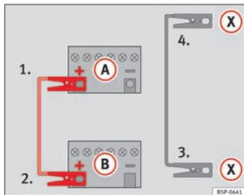
Fig. 155 Esquema para conectar los cables de emergencia en el caso de que el vehículo que suministra la corriente disponga del sistema Start-Stop: batería descargada (A) y batería que suministra la corriente (B).
