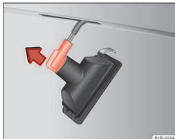
Fig. 151 Luz de la matrícula: Desmontar el portalámparas.
