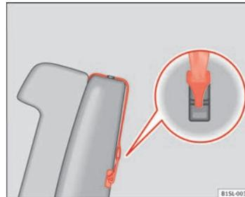
Fig. 54 Ejemplo de un cinturón de fijación superior enganchado.
