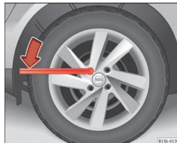
Fig. 136 Cambio de rueda: afloje los tornillos de la rueda.
