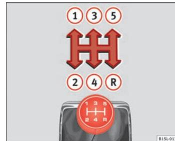
Fig. 85 Esquema de un cambio manual de 5 marchas.
