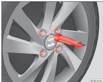
Fig. 140 Cambio de rueda: aflojar los tornillos de la rueda con el mango del destornillador.
