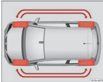
Fig. 115 Esquema para el cambio de ruedas.
