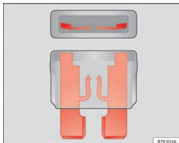
Fig. 144 Representación de un fusible fundido.
