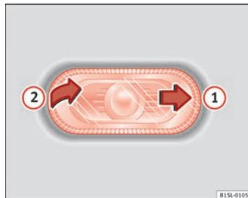
Fig. 152 Desmonte el intermitente lateral.
