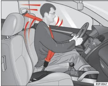
**Fig. 41** Los conductores que lleven el cinturón de seguridad correctamente abrochado no saldrán despedidos en caso de frenazos repentinos.
