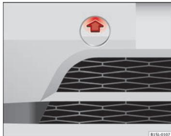
Fig. 156 En la parte derecha del parachoques delantero: Quitar la cubierta.
