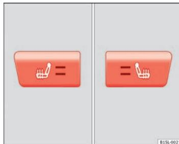
Fig. 34 En la consola central: Mandos para la calefacción de los asientos delanteros.
