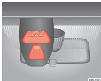
Fig. 92 En el parabrisas: Sensor de láser para la función de Asistencia de frenada en ciudad.
