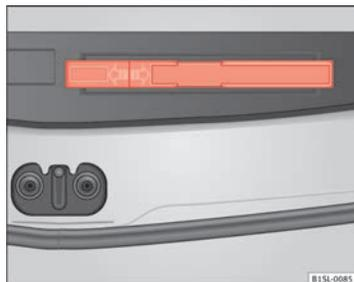
Fig. 126 En el maletero: portaobjetos para el triángulo de preseñalización.
