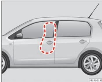
Fig. 51 En el lado izquierdo del vehículo: zona de despliegue del airbag lateral.
