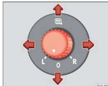
Fig. 66 En la puerta del conductor: mando giratorio para los retrovisores exteriores eléctricos.
