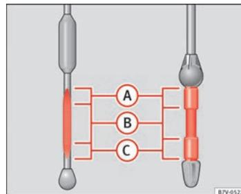
Fig. 106 Varilla de medición con marcas para el nivel del aceite.
