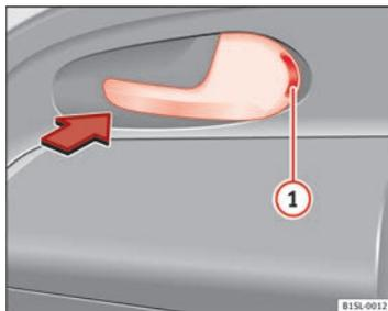
Fig. 20 En la puerta del acompañante: Maneta de la puerta para el bloqueo mecánico.
