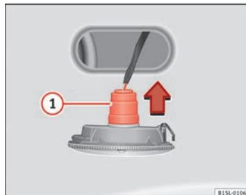
Fig. 153 Intermitente lateral: Cambio de las lámparas.
