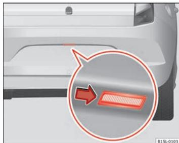
Fig. 150 En el parachoques trasero: Desmontar la luz de la matrícula.
