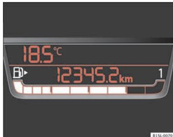
Fig. 102 Pantalla del cuadro de instrumentos: indicador del nivel de combustible para gasolina.
