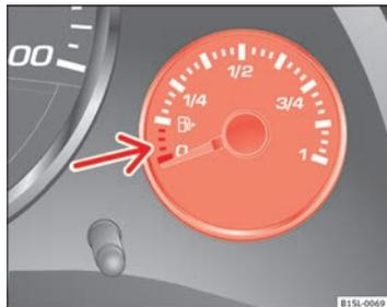
Fig. 101 En el cuadro de instrumentos: indicador del nivel de combustible para gasolina.
