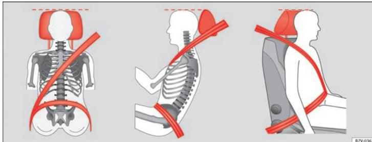
Fig. 44 Colocación correcta del cinturón.
