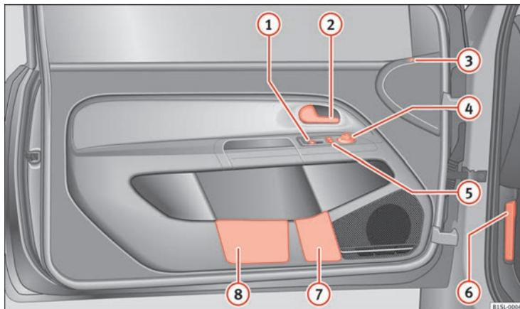
Fig. 4 Vista general de los mandos de la puerta del conductor.
