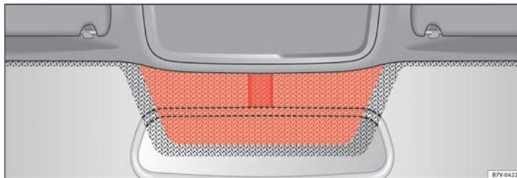
Fig. 59 Parabrisas con protección de infrarrojos con recubrimiento metálico y ventanilla (superficie roja).
