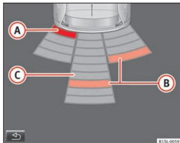
Fig. 90 Indicación del OPS en pantalla: (A) se ha detectado un obstáculo en la zona de colisión. (B) se ha detectado un obstáculo en el segmento. (C) zona registrada detrás del vehículo.
