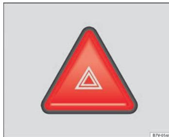
Fig. 125 Tablero de instrumentos: Tecla para encender y apagar los intermitentes de emergencia.
