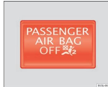
Fig. 46 Testigo de control en el tablero de instrumentos para la desactivación del airbag frontal del acompañante.
