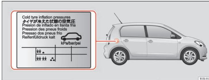
Fig. 116 Ubicación de la placa con la presión de inflado de los neumáticos.
