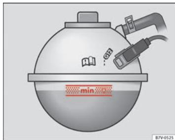
**Fig. 108** En el vano motor: Marca en el depósito de expansión del líquido refrigerante.
