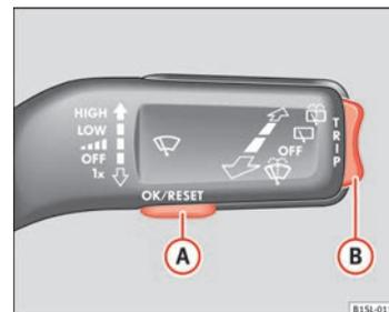
Fig. 11 Palanca del limpiaparabrisas: tecla (A) para confirmar puntos de la indicación y tecla basculante (B) para cambiar los puntos de la indicación.
