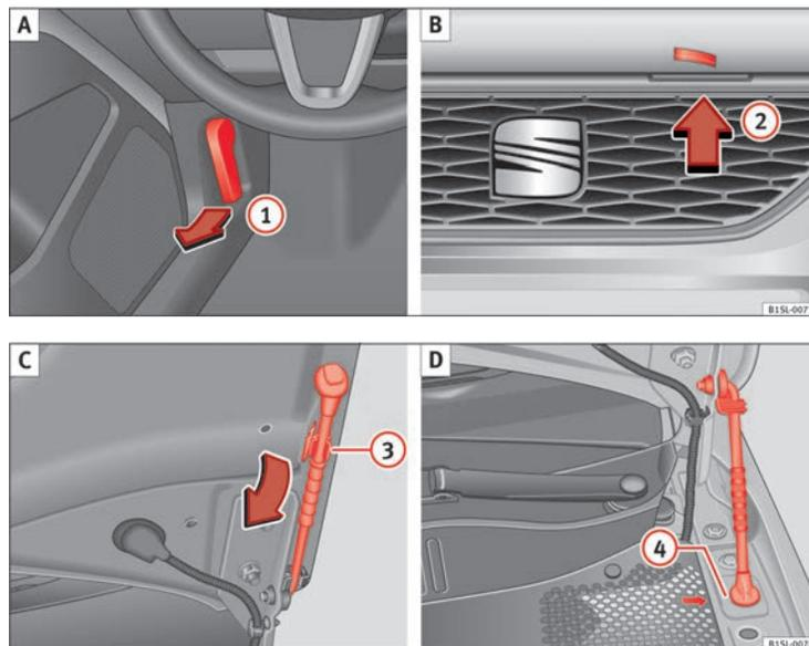
Fig. 104 A: Palanca de desbloqueo en la zona reposapiés, en el lado del conductor. B: Palanca de desbloqueo en el capó del motor.
