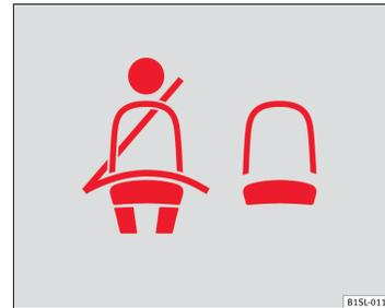
Fig. 36 Indicación del estado del cinturón para las plazas traseras en la pantalla del cuadro de instrumentos.
