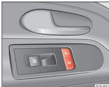
Fig. 19 En la puerta del conductor: botón del cierre centralizado.
