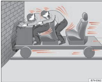
**Fig. 38** Un vehículo colisiona contra un muro con los ocupantes sin abrochar el cinturón.
