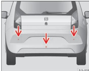
Fig. 89 Sensores del control de la distancia de aparcamiento en el parachoques trasero.
