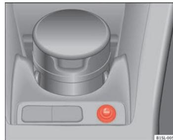
Fig. 81 En la parte delantera de la consola central: encendedor.
