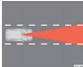
Fig. 93 Zona de detección del sensor de láser.
