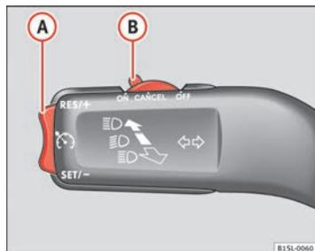
Fig. 91 Palanca de intermitentes y de luz de carretera a la izquierda en la columna de dirección: Teclas y mandos del GRA.
