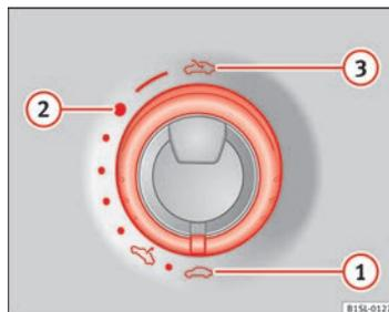
Fig. 26 En el techo interior: girar el mando para la apertura y el cierre.
