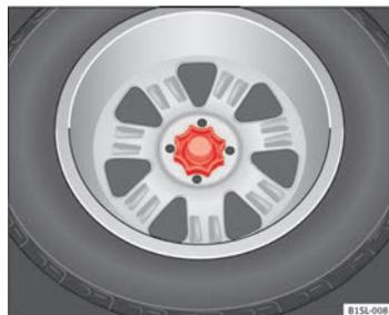
Fig. 118 En el maletero: rueda de mano para la fijación de la rueda de repuesto.
