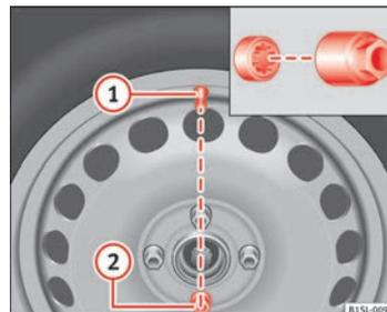
Fig. 137 Cambio de rueda: Válvula del neumático ① y ubicación del tornillo antirrobo de la rueda ②.
