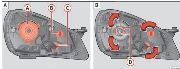
Fig. 145 En el vano motor: Vista posterior del faro de lantero izquierdo con cubierta de goma: (A) luces de cruce y luz de carretera, (B) luces de posición y luz diurna, (C) intermitente.
