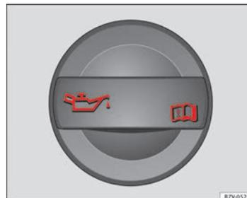
Fig. 107 En el vano motor: Tapón de la boca de llenado del aceite del motor. ▶
