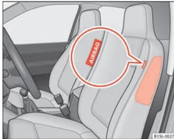
Fig. 50 En el lateral del asiento delantero: ubicación del airbag lateral.
