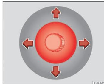
Fig. 65 En las puertas delanteras: botón de ajuste para el retrovisor exterior mecánico.
