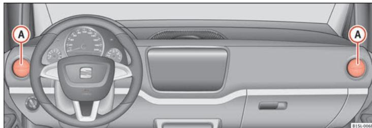
Fig. 100 Tablero de instrumentos: Difusores de aire.
