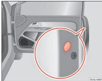
Abb. 128 In der Stirnseite der Beifahrertür: Notverriegelung, durch eine Gummidichtung abgedeckt.
