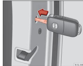
Abb. 129 Notverriegelung des Fahrzeugs mit dem Fahrzeugschlüssel.
