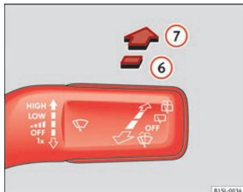
Abb. 61 Heckscheibenwischer bedienen.
