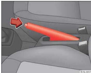
Abb. 86 Zwischen den Vordersitzen: Handbremse.
