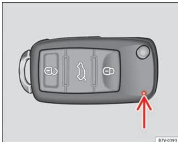
Abb. 14 Kontrollleuchte im Fahrzeugschlüssel.
