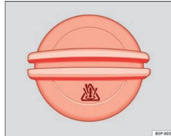
Abb. 109 Im Motorraum: Deckel des Motor Kühlmittelausgleichsbehälters.
