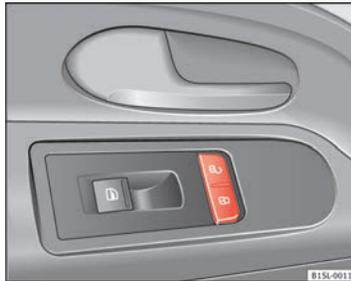
Abb. 19 In der Fahrertür: Zentralverriegelungstaste.
