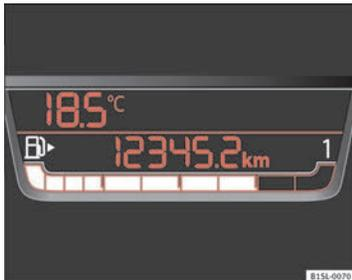
Abb. 102 Im Display des Kombiinstrument: Kraftstoffvorratsanzeige für Benzin.
