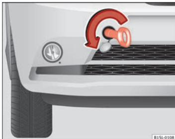
Abb. 157 Im Stoßfänger vorn rechts: Abschleppöse einschrauben.
