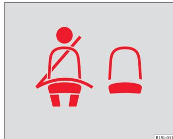
Abb. 36 Gurtstatusanzeige für die hinteren Sitzplätze im Display des Kombiinstrumentes.
