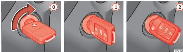
Abb. 83 Positionen des Fahrzeugschlüssels.
