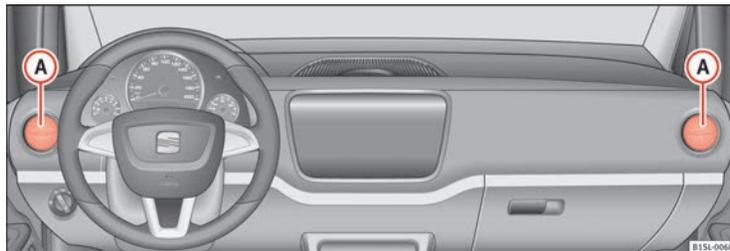
Abb. 100 In der Instrumententafel: Luftaustrittsdüsen.
