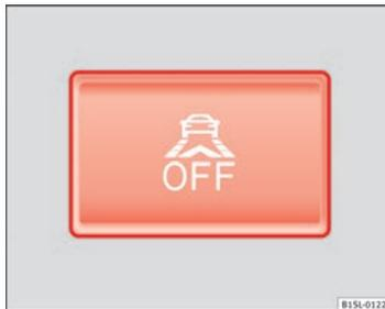
Abb. 94 Im unteren Teil der Mittelkonsole: Taste für den City-Safety-Assistent.
