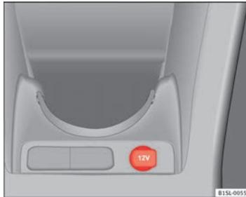
Abb. 82 Mittelkonsole vorn: 12-Volt-Steckdose im Ablagefach.
