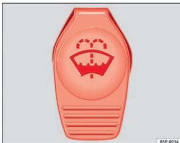
Abb. 63 Im Motorraum: Deckel des Scheibenwaschwasserbehälters.
