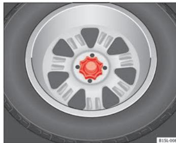
Abb. 118 Im Gepäckraum: Handrad zur Befestigung des Reserverads. ►
