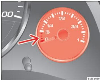
Abb. 101 Im Kombiinstrument: Kraftstoffvorratsanzeige für Benzin.
