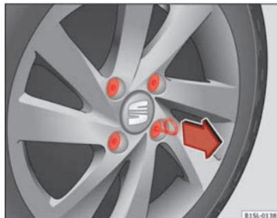
Fig. 142 Rimuovere i cappucci dai bulloni della ruota.
