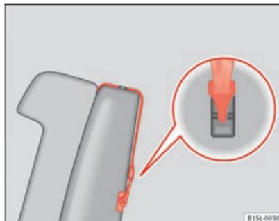
Fig. 54 Esempio di cintura di fissaggio superiore agganciata
