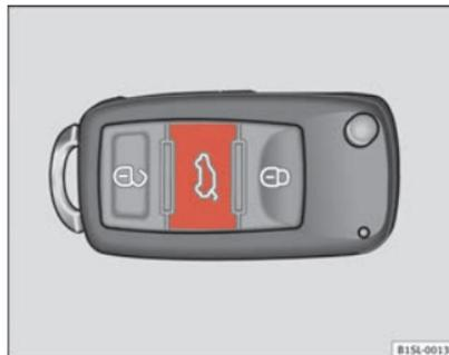
Fig. 22 Sulla chiave del veicolo: Pulsante per sbloccare ed aprire il portellone.
