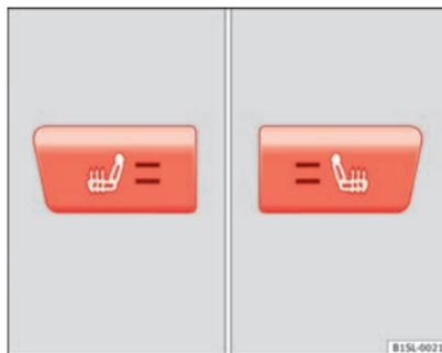
Fig. 34 Sulla console centrale: regolatore per il riscaldamento dei sedili anteriori
