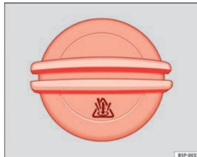
Fig. 116 Nel vano motore: Tappo del serbatoio di compensazione del liquido di raffreddamento.
