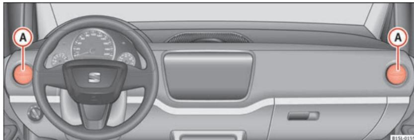
Fig. 106 Plancia portastrumenti: Bocchette di ventilazione
