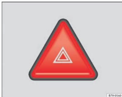
Fig. 132 Plancia portastrumenti: Tasto di accensione e spegnimento del lampeggio d'emergenza
