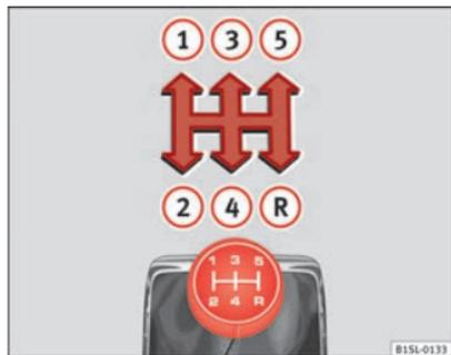
Fig. 88 Schema degli innesti del cambio manuale a 5 marce.
