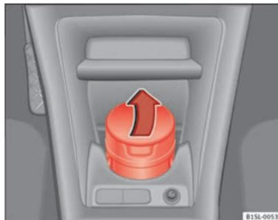
Fig. 82 Nella parte anteriore della console centrale: Come aprire il posacenere
