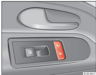
Fig. 19 Sulla porta del conducente: pulsante della chiusura centralizzata.
