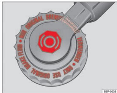
Fig. 93 Nel vano motore: tappo del serbatoio del liquido dei freni
