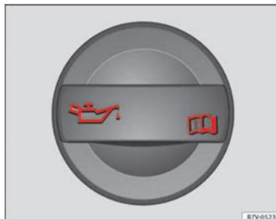
Fig. 114 Nel vano motore: Tappo di rabbocco dell'olio motore. ►
