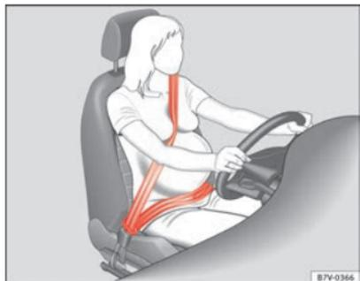
Fig. 45 Posizione corretta del nastro della cintura di sicurezza per donne in stato di gravidanza.
