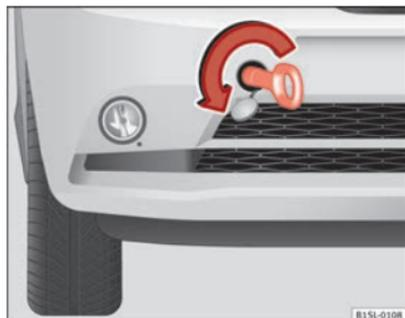
Fig. 164 Nella parte destra del paraurti anteriore: Avvitare l'occhiello di traino.
