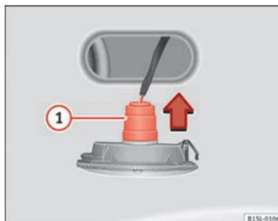
Fig. 160 Indicatore di direzione laterale: sostituzione delle lampadine ▶
