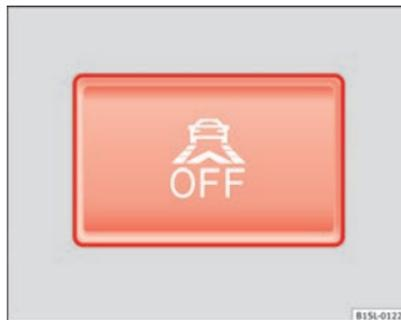
Fig. 100 Nella parte inferiore della console centrale: tasto per la funzione di frenata di emergenza City
