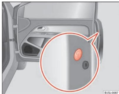
**Fig. 135** Nella parte anteriore della porta del passeggero: Blocco di emergenza, nascosto da una guarnizione di gomma.
