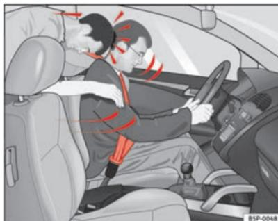
Fig. 40 Non indossando la cintura di sicurezza, il passeggero seduto sul sedile posteriore viene scagliato in avanti, colpendo il conducente (che invece indossa la cintura)
