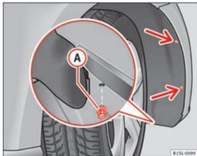
**Fig. 153** Nel passaruota anteriore destro: Estrarre le viti di fissaggio (freccie) e rimuovere il ribattino a espansione A.
