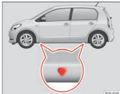
Fig. 145 Punti di appoggio per il cric.
