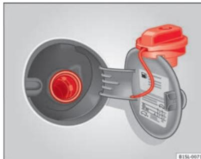
**Fig. 109 Sportellino del serbatoio del carburante aperto e utilizzato come supporto per il tappo.**
