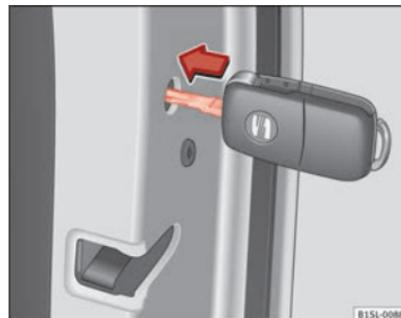
**Fig. 136** Blocco di emergenza del veicolo con la chiave.
