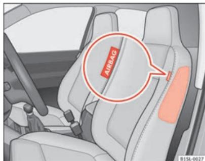
Fig. 50 Sul lato del sedile anteriore: posizione dell'airbag laterale.
