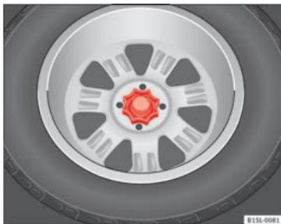
**Fig. 125** Net bagagliaio: ruota per il fissaggio della ruota di scorta.
