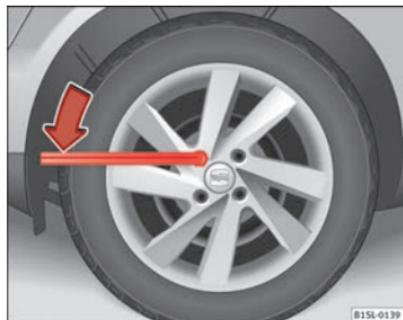
Fig. 143 Cambio di una ruota: allentare i bulloni della ruota.
