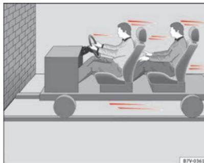
**Fig. 37** Il veicolo è in procinto di entrare in collisione con un muro: i passeggeri non indossano le cinture di sicurezza.
