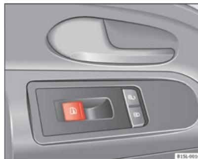
Fig. 24 Sulla porta del conducente: tasti per gli alzacristalli elettrici
