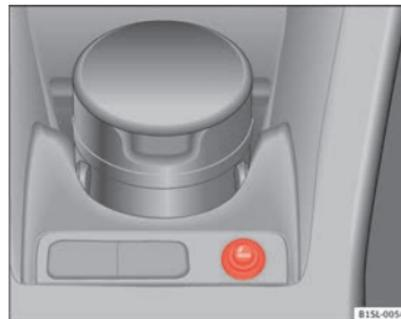
Fig. 83 Nella parte anteriore della console centrale: accendisigari.
