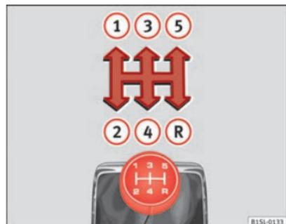
Fig. 88 Esquema de un cambio manual de 5 marchas.
