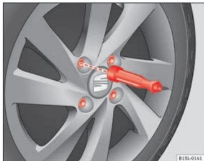
Fig. 147 Cambio de rueda: aflojar los tornillos de la rueda con el mango del destornillador.
