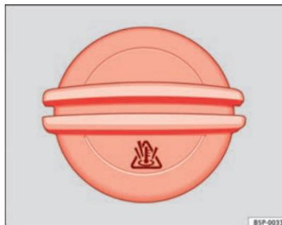
Fig. 116 En el vano motor: Tapón del depósito de expansión del líquido refrigerante.
