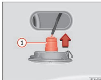
Fig. 160 Intermitente lateral: Cambio de las lámparas. ▶
