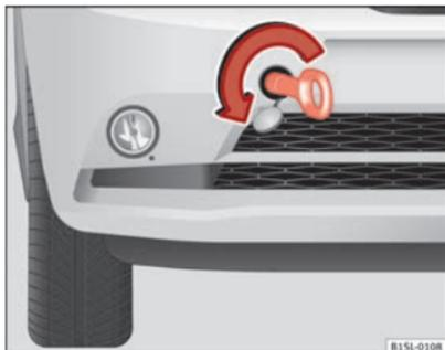
Fig. 164 En la parte derecha del parachoques delantero: Enroscar la argolla de remolque.
