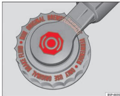
Fig. 93 En el vano motor: tapón del depósito del líquido de frenos
