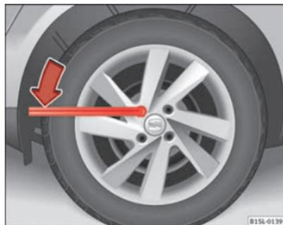
Fig. 143 Cambio de rueda: afloje los tornillos de la rueda.
