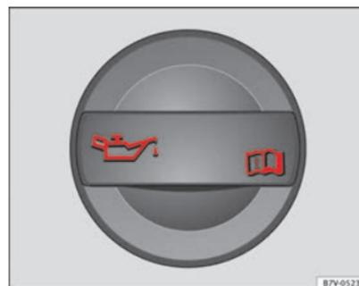
Fig. 114 En el vano motor: Tapón de la boca de llenado del aceite del motor. ▶
