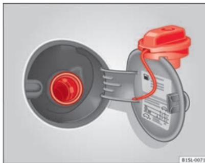
Fig. 109 Tapa del depósito abierta con el tapón enganchado en ella.
