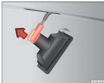
Fig. 158 Luz de la matrícula: Desmontar el portalámparas. ▶
