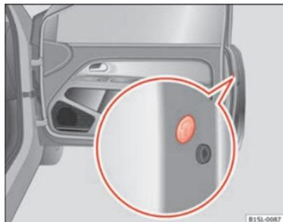
Fig. 135 En la parte frontal de la puerta del acompañante: Bloqueo de emergencia, oculto por una junta de goma.
