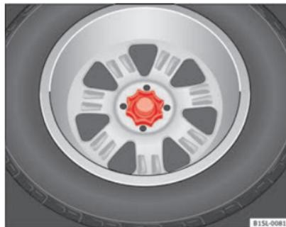
**Fig. 125** En el maletero: rueda de mano para la fijación de la rueda de repuesto.
