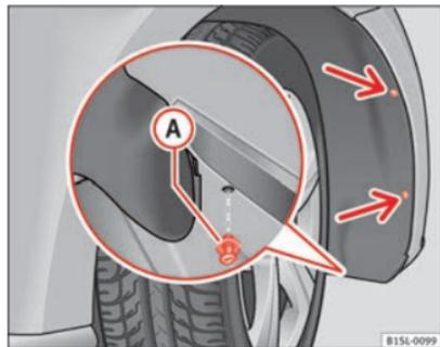
**Fig. 153** En el pasarruedas delantero derecho: Extraiga los tornillos de fijación (flechas) y retire el remache expansivo (A).
