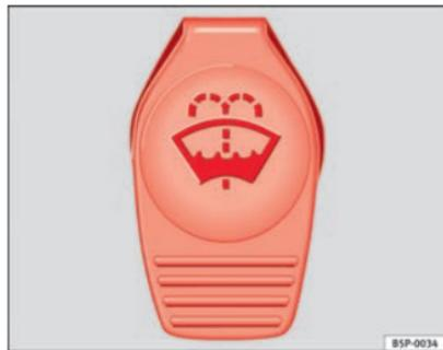
Fig. 63 En el vano motor: tapón del depósito del lavacristales.
