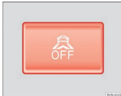
Fig. 100 En la parte inferior de la consola central: Tecla para la función de Asistencia de frenada en ciudad.
