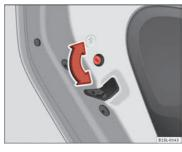
Fig. 21 Childproof lock on the left hand side door
