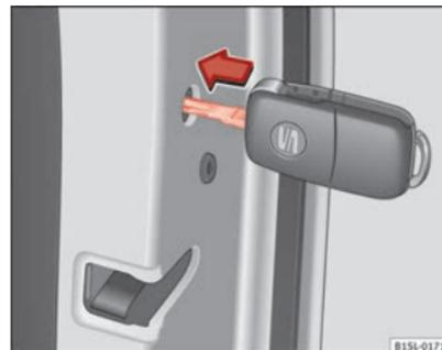
Abb. 137 Notverriegelung des Fahrzeugs mit dem Fahrzeugschlüssel.
