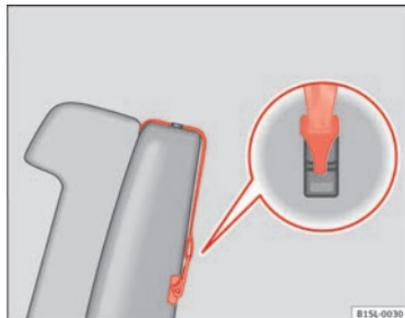
Abb. 54 Beispiel eines eingehängten oberen Befestigungsgurts.
