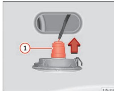
Abb. 161 Seitliche Blinkleuchte: Glühlampe austauschen.
