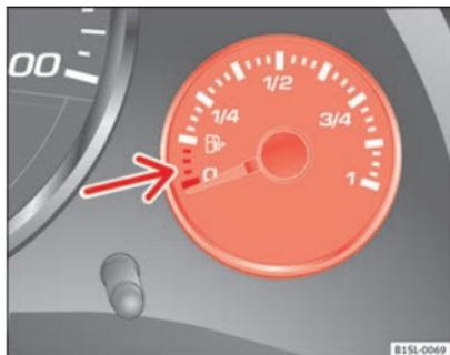
Abb. 108 Im Kombiinstrument: Kraftstoffvorratsanzeige für Benzin.
