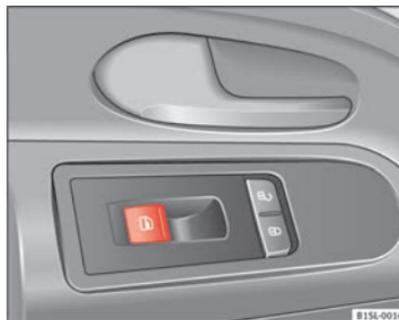
Abb. 24 An der Fahrertür: Taste für den Fensterheber.
