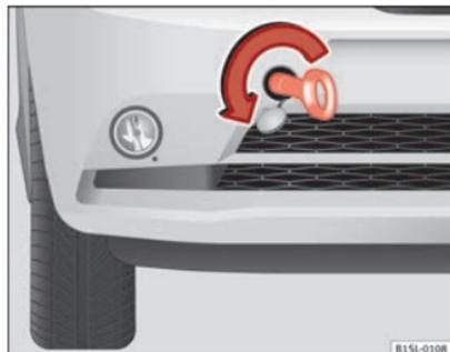
Abb. 165 Im Stoßfänger vorn rechts: Abschleppöse einschrauben.
