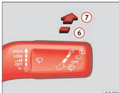
Abb. 61 Heckscheibenwischer bedienen.
