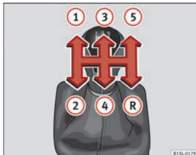
Abb. 89 Schaltschema des 5-Gang-Schaltgetriebes.
