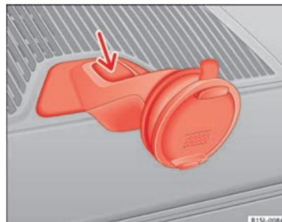
Abb. 129 Aufnahme des Navigationsgeräts ausbauen.
