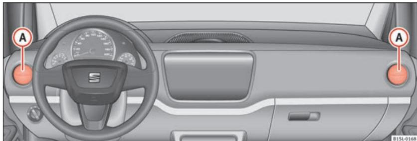
Abb. 107 In der Instrumententafel: Luftaustrittsdüsen.
