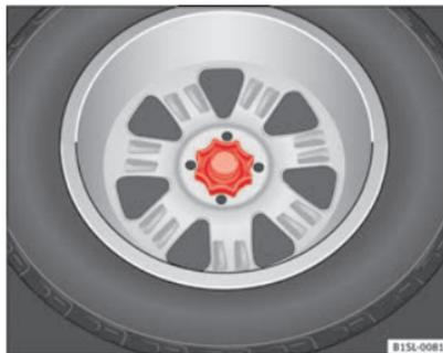
Abb. 126 Im Gepäckraum: Handrad zur Befestigung des Reserverads. ▶
