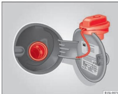
**Abb. 110** Geöffnete Tankklappe mit eingehängtem Tankverschluss.
