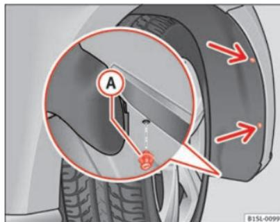
Abb. 154 Im Radhaus vorn rechts: Befestigungsschrauben (Pfeile) herausdrehen und Spreizniet (A) entfernen.
