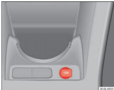
Abb. 85 Mittelkonsole vorn: 12-Volt-Steckdose im Ablagefach.
