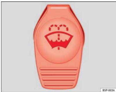
Abb. 63 Im Motorraum: Deckel des Scheibenwaschwasserbehälters.
