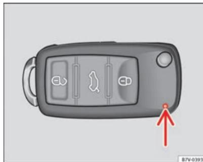
Abb. 14 Kontrollleuchte im Fahrzeugschlüssel. ►
