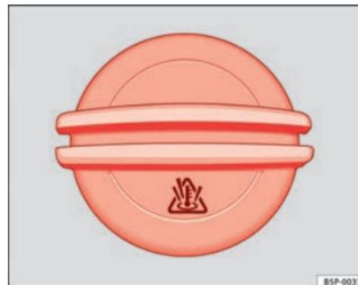
Abb. 117 Im Motorraum: Deckel des Motorkühlmittelausgleichsbehälters.
