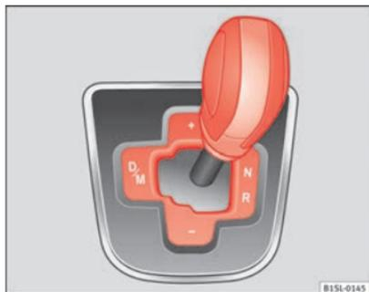
Abb. 90 Wählhebel für das Automatikgetriebe.
