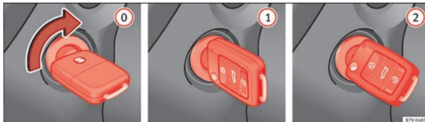
Abb. 86 Positionen des Fahrzeugschlüssels.
