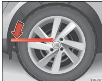
Abb. 144 Radwechsel: Radschrauben lockern.
