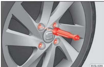
Abb. 131 Radwechsel: Radschrauben mit dem Schraubendrehergriff abschrauben.
