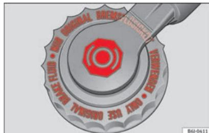
**Abb. 111** Im Motorraum: Deckel des Bremsflüssigkeitsbehälters
