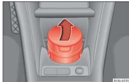
**Abb. 66** In der Mittelkonsole vorn: Öffnen des Aschenbechers.
