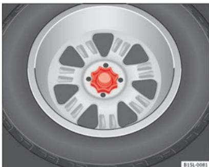
**Abb. 118** Im Gepäckraum: Handrad zur Befestigung des Reserverads.
