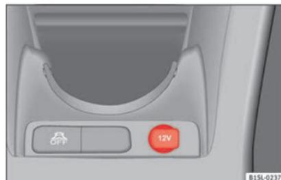
Abb. 68 Mittelkonsole vorn: 12-Volt-Steckdose im Ablagefach.
