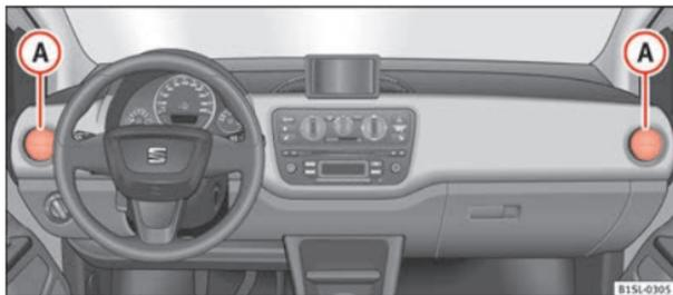
**Abb. 78** In der Instrumententafel: Luftaustrittsdüsen.
