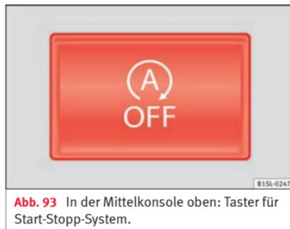
Abb. 93 In der Mittelkonsole oben: Taster für Start-Stopp-System.
