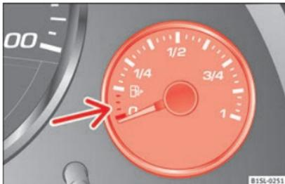
**Abb. 101** Im Kombiinstrument: Kraftstoffvorratsanzeige für Benzin.
