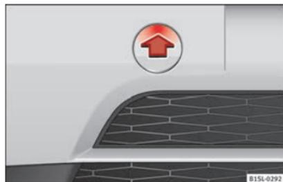
Abb. 135 Im Stoßfänger vorn rechts: Abdeckung abnehmen.
