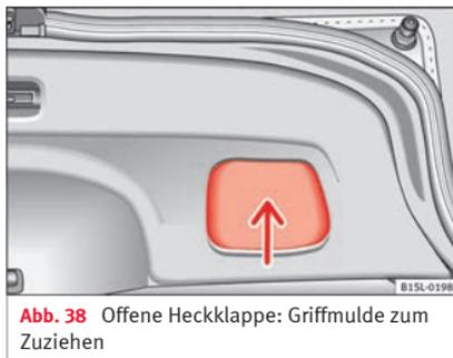
Abb. 38 Offene Heckklappe: Griffmulde zum Zuziehen
