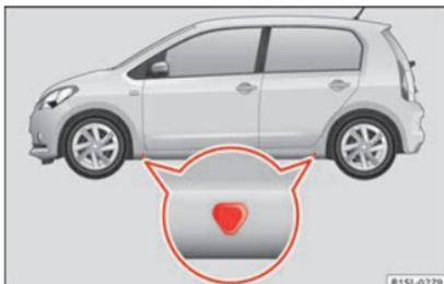
**Abb. 129** Aufnahmepunkte für den Wagenheber.
