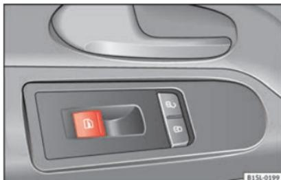
**Abb. 39** An der Fahrertür: Taste für den Fensterheber.
