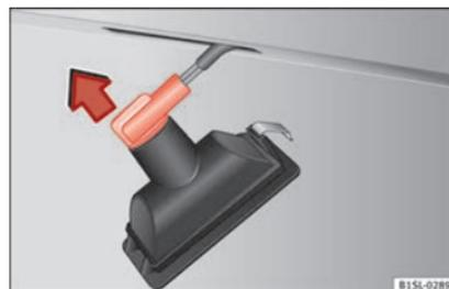
**Abb. 152** Kennzeichenleuchte: Lampenträger ausbauen. »
