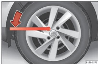
**Abb. 127** Radwechsel: Radschrauben lockern.
