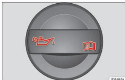
Abb. 108 Im Motorraum: Deckel der Motoröleinfüllöffnung.
