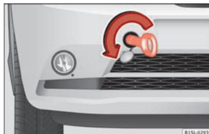
Abb. 136 Im Stoßfänger vorn rechts: Abschleppöse einschrauben.
