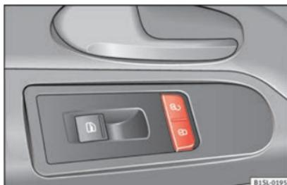
Abb. 34 An der Fahrertür: Zentralverriegelungstaster.
