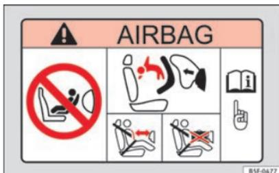
**Abb. 18** Sonnenblende auf der Beifahrerseite: Airbagaufkleber
