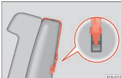
**Abb. 22** Beispiel eines eingehängten oberen Befestigungsgurtes.
