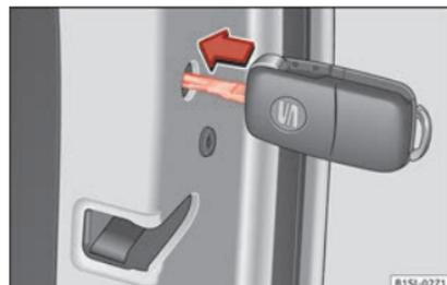
Abb. 139 Notverriegelung des Fahrzeugs mit dem Fahrzeugschlüssel.
