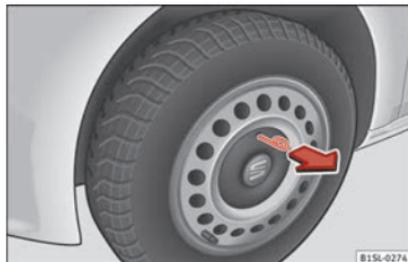
**Abb. 124** Radmittenblende an der Stahlfelge abziehen.
