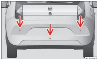
**Abb. 85** Sensoren der Parkdistanzkontrolle im hinteren Stoßfänger.
