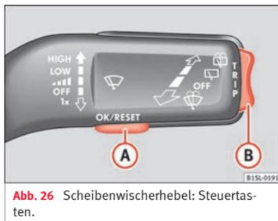
Abb. 26 Scheibenwischerhebel: Steuertasten.
