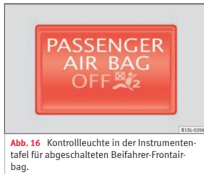
Abb. 16 Kontrollleuchte in der Instrumententafel für abgeschalteten Beifahrer-Frontairbag.
