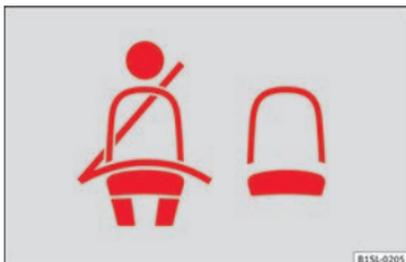
**Fig. 68** Indicação do estado do cinto de segurança para os lugares traseiros no ecrã do painel de instrumentos.
