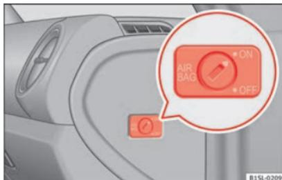
**Fig. 75** No lado do passageiro: interruptor de chave para ativar e desativar o airbag dianteiro do passageiro.
