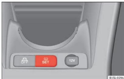
Fig. 176 Consola central: tecla do sistema de controlo dos pneus
