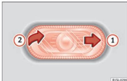
Fig. 92 Desmonte a luz indicadora de mudança de direção lateral.
