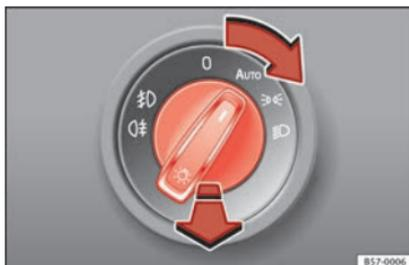
**Fig. 29** Painel de instrumentos: comando das luzes.
