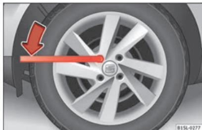
**Fig. 53** Substituição de uma roda: desapertar os parafusos das rodas
