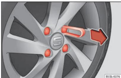
**Fig. 52** Retirar os protetores dos parafusos da roda.
