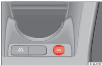
**Fig. 133** tomada de corrente de 12 volts no porta-objetos.
