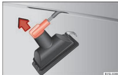
**Fig. 91** Luz da matrícula: desmontar o porta-lâmpadas.
