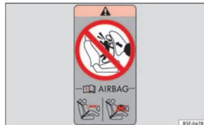
**Fig. 24** Na moldura posterior da porta do passageiro: adesivo relativo ao airbag.
