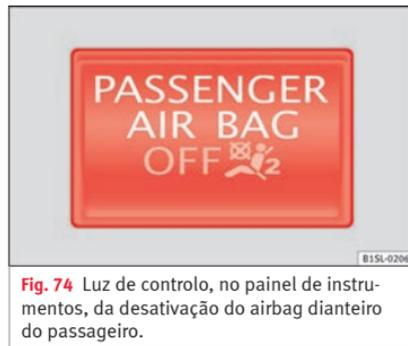
Fig. 74 Luz de controlo, no painel de instrumentos, da desativação do airbag dianteiro do passageiro.
