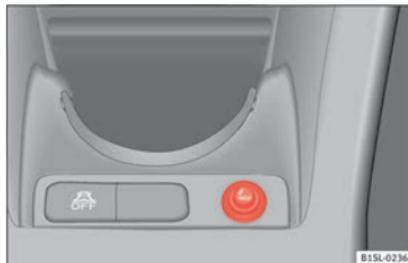
Fig. 132 Na parte dianteira da consola central: isqueiro.
