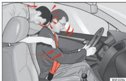
**Fig. 71** O passageiro do banco traseiro que não tiver colocado o cinto de segurança é projetado para a frente, para cima do condutor que tem o cinto colocado.
