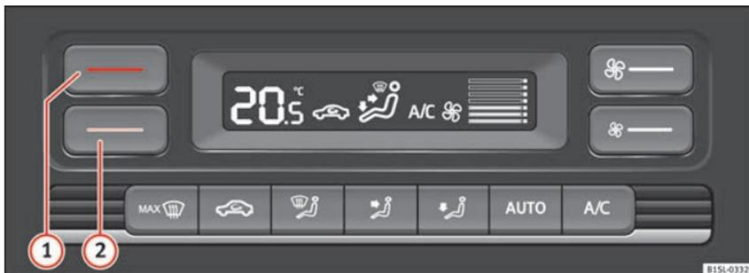
Fig. 144 Na parte superior da consola central: comandos do Climatronic
