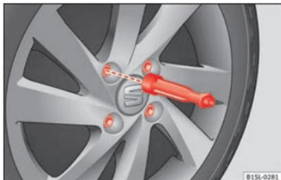
**Fig. 57** desapertar os parafusos da roda com o punho da chave de parafusos.
