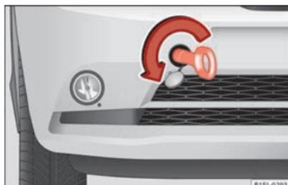
**Fig. 81** Na parte direita do para-choques dianteiro: enroscar a argola de reboque.
