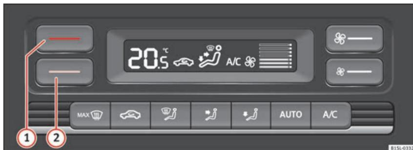
Fig. 37 Na parte superior da consola central: comandos do Climatronic
