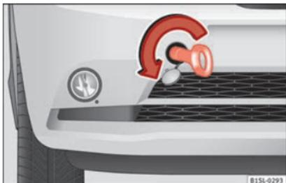
**Fig. 58** Na parte direita do para-choques dianteiro: argola de reboque enroscada.
