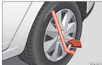
Fig. 51 Desmontar o tampão integral.
