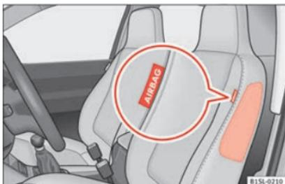
**Fig. 21** No painel lateral do banco dianteiro: localização do airbag lateral.
