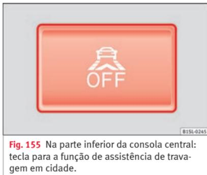
**Fig. 155** Na parte inferior da consola central: tecla para a função de assistência de travagem em cidade.
