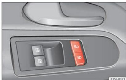
**Fig. 2** Na porta do condutor: botão do fecho centralizado.
