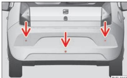
**Fig. 151** Sensores do controlo de estacionamento no para-choques traseiro.
