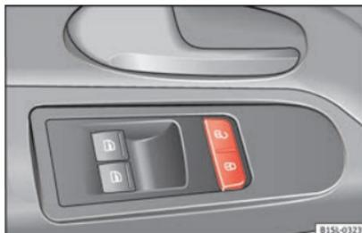
Fig. 103 Na porta do condutor: botão do fecho centralizado.
