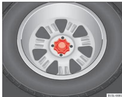
Fig. 177 Na bagageira: roda de mão para a fixação do pneu suplente.
