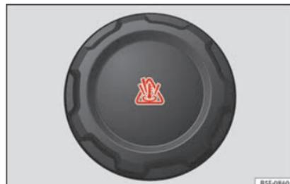
**Fig. 171** No compartimento do motor: Tampão do reservatório de expansão do líquido de refrigeração.
