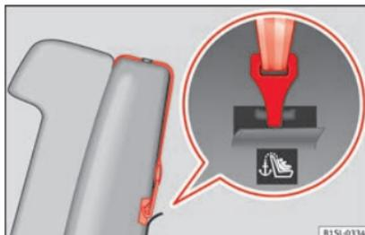
Fig. 27 Exemplo de um cinto de fixação superior encaixado.
