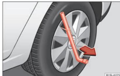
Fig. 51 Desmontar o tampão integral.
