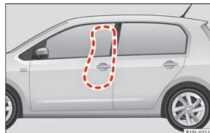
**Fig. 22** No lado esquerdo do veículo: raio de alcance do airbag lateral.
