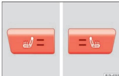
**Fig. 120** Na consola central: Comandos para o aquecimento dos bancos dianteiros.
