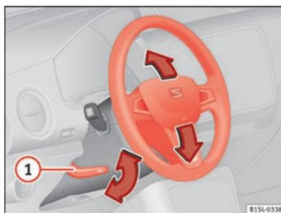
**Fig. 17** Ajuste mecânico do volante.
