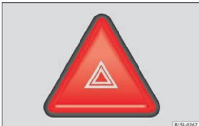
Fig. 110 Painel de instrumentos: botão para ligar e desligar as luzes de emergência.
