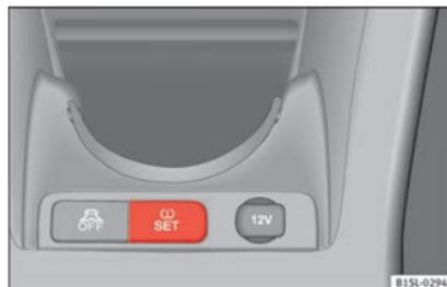
Fig. 176 Consola central: botão do sistema de controlo dos pneus
