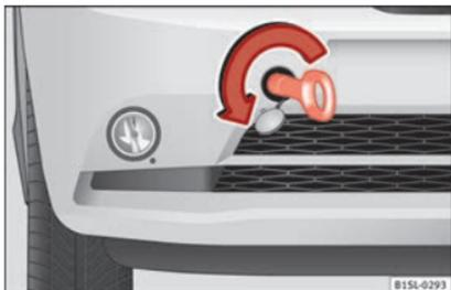
**Fig. 58** Para-choques dianteiro, direita: argola de reboque enroscada.
