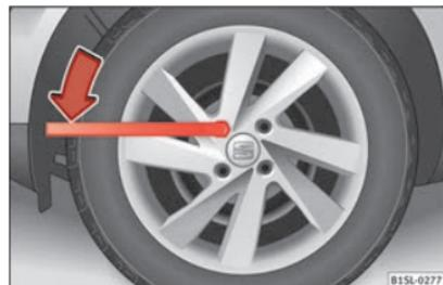
**Fig. 53** Substituição de roda: alivie os parafusos da roda.
