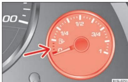
**Fig. 164** No painel de instrumentos: indicador do nível de combustível para gasolina.
