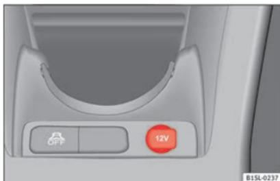
**Fig. 133** Consola central à frente: tomada de corrente de 12 volts no compartimento para objetos.
