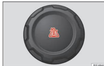
Fig. 42 Compartimento do motor: tampão do depósito de compensação do líquido de refrigeração.
