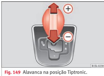
Fig. 149 Alavanca na posição Tiptronic.
