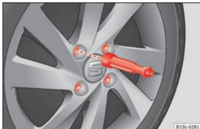
**Fig. 57** Substituição de roda: desapertar os parafusos da roda com o punho da chave de parafusos.
