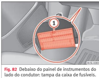
Fig. 82 Debaixo do painel de instrumentos do lado do condutor: tampa da caixa de fusíveis.
