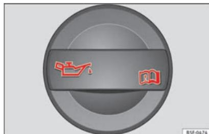
Fig. 169 No compartimento do motor: tampão do bocal de enchimento do óleo do motor.
