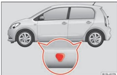
Fig. 55 Pontos de apoio do macaco.
