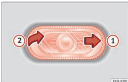
**Abb. 92** Seitliche Blinkleuchte ausbauen.
