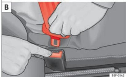
**Abb. 72** Schlosszunge des Sicherheitsgurts einstecken und lösen.
