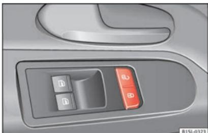
Abb. 2 An der Fahrertür: Zentralverriegelungstaster.
