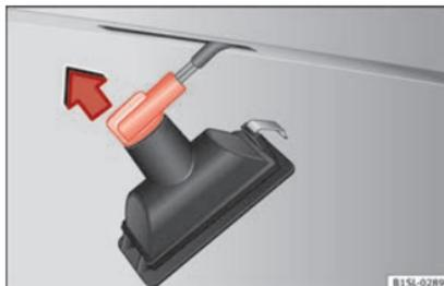
**Abb. 91** Kennzeichenleuchte: Lampenträger ausbauen.
