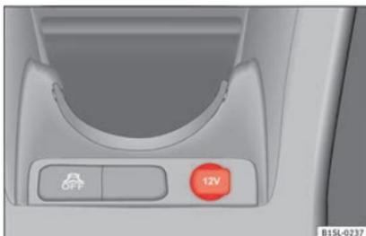
Abb. 133 Mittelkonsole vorn: 12-Volt-Steckdose im Ablagefach.
