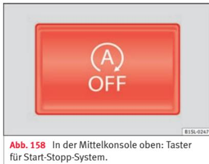
**Abb. 158** In der Mittelkonsole oben: Taster für Start-Stopp-System.
