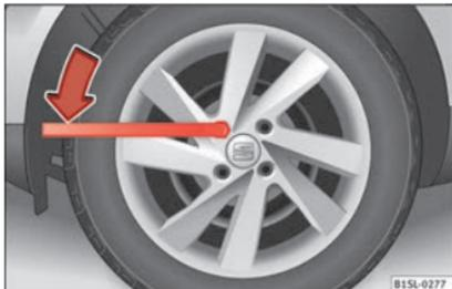
Abb. 53 Radwechsel: Radschrauben lockern.
