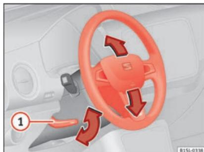
**Abb. 17** Lenkradposition mechanisch einstellen.
