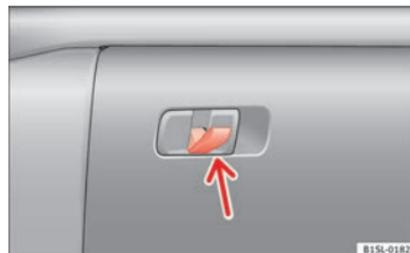
Abb. 124 Ablagefach auf der Beifahrerseite: klappbarer Haken.
