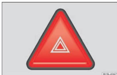
Abb. 31 Instrumententafel: Schalter für die Warnblinkanlage
