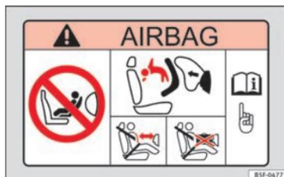
**Abb. 23** Sonnenblende auf der Beifahrerseite: Airbagaufkleber.
