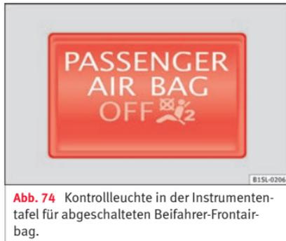
Abb. 74 Kontrollleuchte in der Instrumententafel für abgeschalteten Beifahrer-Frontairbag.
