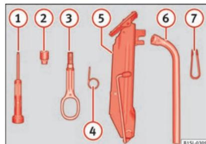
Abb. 49 Bestandteile des Bordwerkzeugs.
