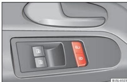
**Abb. 103** An der Fahrertür: Zentralverriegelungstaster.
