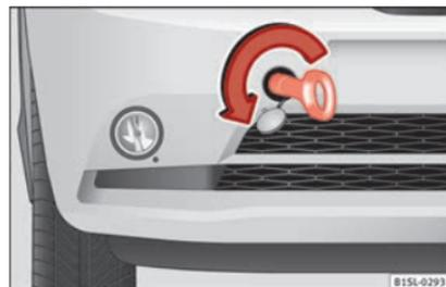
Abb. 58 Vorderer Stoßfänger rechts: Eingeschraubte Abschleppöse
