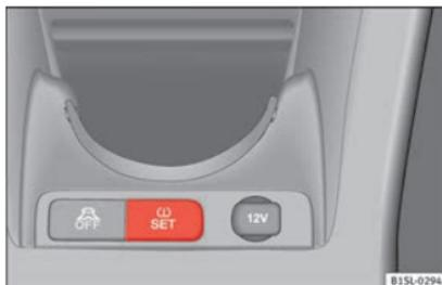
**Abb. 176** Mittelkonsole: Taste für die Reifenkontrollanzeige
