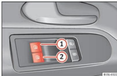
**Abb. 10** An der Fahrtür: Tasten für die vordere Fensterbedienung.
