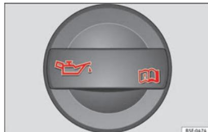
Abb. 169 Im Motorraum: Deckel der Motoröleinfüllöffnung.
