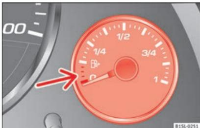
**Abb. 164** Im Kombiinstrument: Kraftstoffvorratsanzeige für Benzin.
