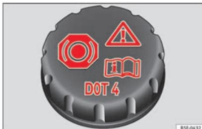
**Abb. 43** Motorraum: Deckel des Bremsflüssigkeitsbehälters
