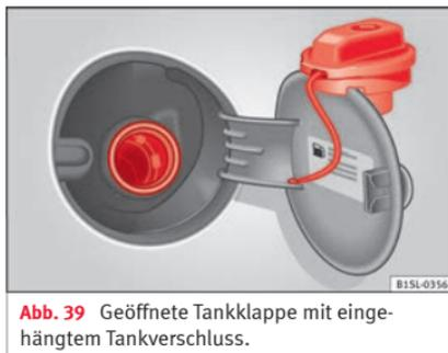
**Abb. 39** Geöffnete Tankklappe mit eingehängtem Tankverschluss.
