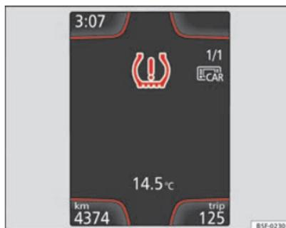
Fig. 146 Tableau de bord : avertissement de perte de pression des pneus
