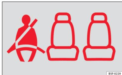
Fig. 7 Indication de l'état des ceintures de la banquette arrière sur l'écran du tableau de bord.
