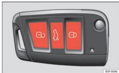
Fig. 50 Clé à radiocommande : affectation des touches
