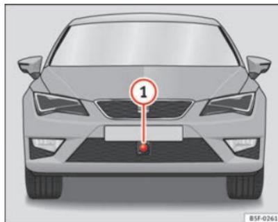
Fig. 139 Dans le pare-chocs avant : capteur radar.
