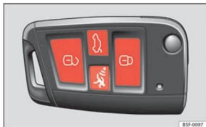
Fig. 51 Clé à radiocommande : affectation des touches
