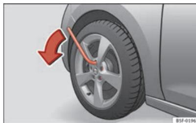
Fig. 168 Roue : desserrer les boulons de roue
