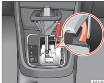
**Fig. 125** Levier sélecteur : déverrouillage d'urgence de la position de parking
