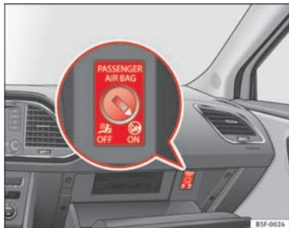
Fig. 28 Commande de l'airbag frontal du passager
