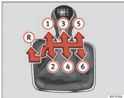
Fig. 121 Schéma d'une boîte mécanique 5 vitesses ou 6 vitesses.
