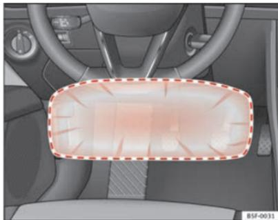
Fig. 24 Côté conducteur : rayon d'action de l'airbag de genoux.
