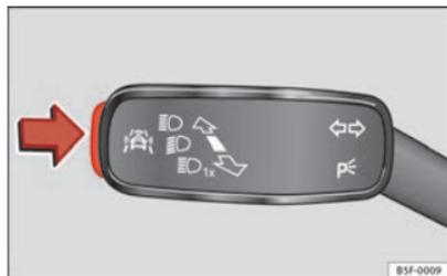
Fig. 44 Sur le levier des clignotants et des feux de route : touche des systèmes d'aide à la conduite.
