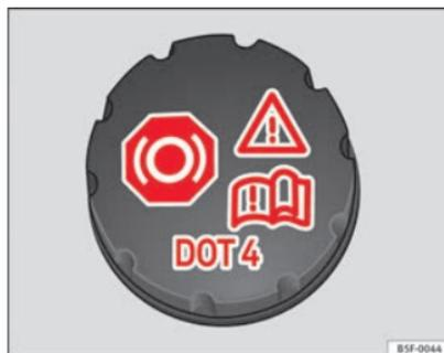
Fig. 157 Compartiment-moteur : bouchon du réservoir du liquide de frein
