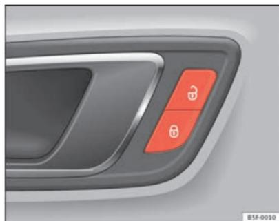
Fig. 52 Porte du conducteur : commande de verrouillage centralisé
