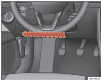
Fig. 23 Côté conducteur : emplacement de l'airbag de genoux.
