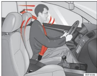
**Fig. 12 Conducteur avec ceinture de sécurité correctement bouclée : il est tenu par celle-ci en cas de freinage sec.**
