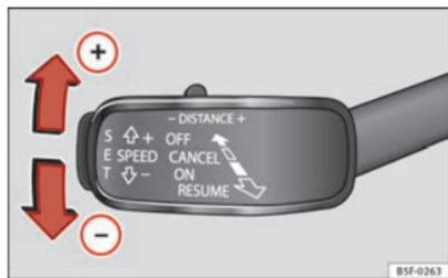
Fig. 133 À gauche de la colonne de direction : Troisième levier pour l'utilisation du régulateur de vitesse adaptatif.
