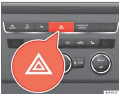
Fig. 66 Planche de bord : commande des feux de détresse
