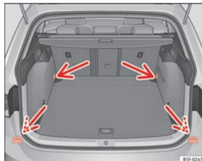
Fig. 105 Dans le coffre à bagages : œillets d'amarrage (modèle LEON ST).
