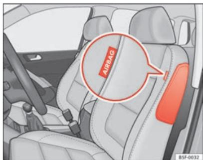
Fig. 25 Airbag latéral dans le siège du conducteur
