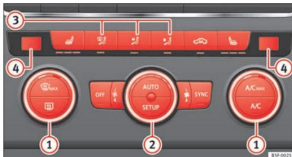
Fig. 113 Dans la console centrale : commandes du Climatronic.
