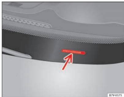
Fig. 201 Numéro de châssis.
