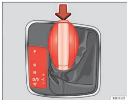
**Fig. 122 Verrouillage du levier sélecteur**
