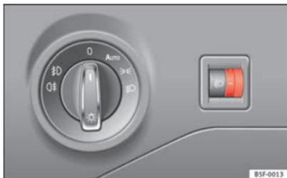
Fig. 67 Côté volant : dispositif de réglage du site des projecteurs.
