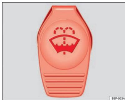
Fig. 158 Compartment-moteur : Bouchon du réservoir de lave-glace
