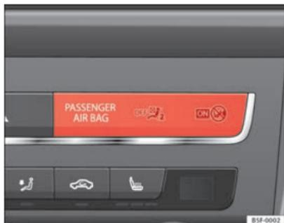
Fig. 29 Témoin de désactivation de l'airbag du passager
