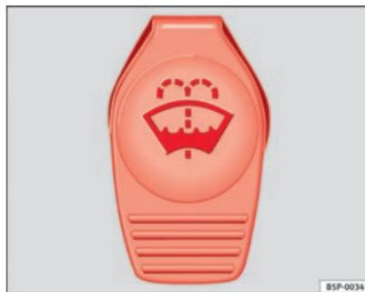
**Fig. 74** Dans le compartiment moteur : bouchon du réservoir du lave-glace.
