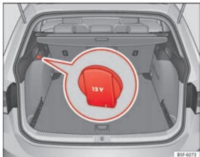
Fig. 88 Détail du revêtement latéral du coffre à bagages : Prise de courant 12 volts (valable uniquement sur le modèle LEON ST)
