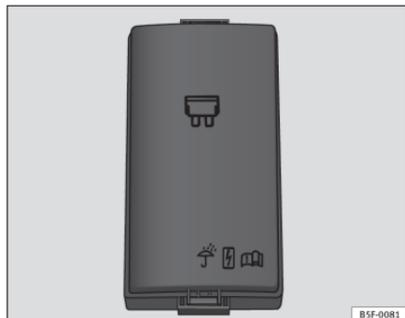
Fig. 178 Dans le compartiment moteur : cache du boîtier de fusibles.
