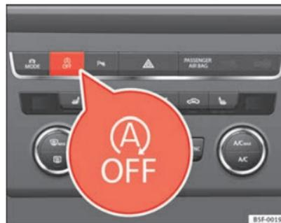
Fig. 120 Console centrale : touche du système Start-Stop
