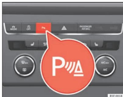
Fig. 149 Console centrale : touche de l'aide au stationnement
