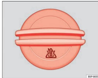
Fig. 156 Compartiment-moteur : Bouchon du vase d'expansion du liquide de refroidissement
