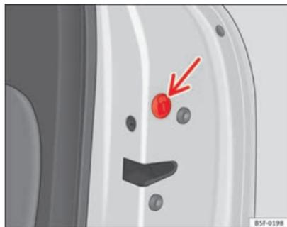
**Fig. 56 Verrouillage d'urgence de la porte**
