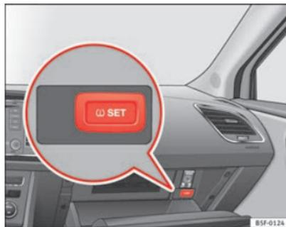
Fig. 147 Boîte à gants : interrupteur de contrôle de la pression des pneus
