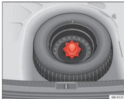
Fig. 171 Roue de secours : plancher de chargement soulevé
