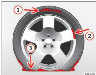
Fig. 163 Pneu : dommages irréparables
