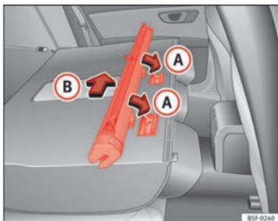
Fig. 100 Monter le filet de séparation sur le dossier de la banquette arrière.
