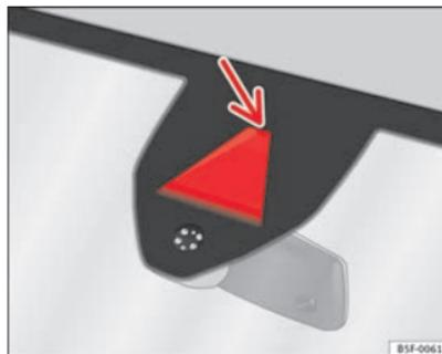
Fig. 143 Sur le pare-brise : Fenêtre de l'assistant de maintien de voie.
