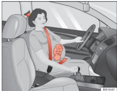
Fig. 16 Ajustement recommandé de la sangle de ceinture de sécurité pour les femmes enceintes
