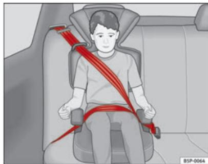
Fig. 32 Siège pour enfant monté face à la route sur la banquette arrière.
