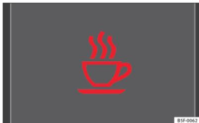
Fig. 145 Sur l'écran du tableau de bord : Symbole de détection de la fatigue.
