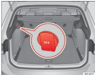
Abb. 88 Ausschnitt aus der Seitenverkleidung des Gepäckraums: 12-Volt-Steckdose (gilt nur für das Modell LEON ST)
