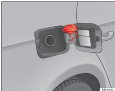
Abb. 151 Tankklappe mit aufgestecktem Tankverschluss
