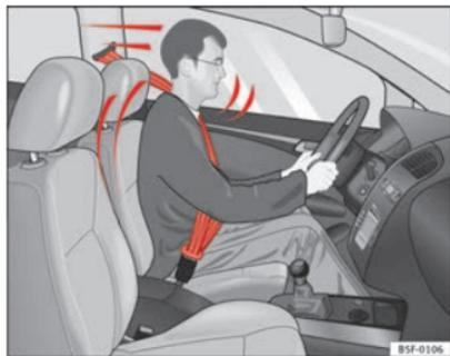
**Abb. 12** Angegurter Fahrer, der bei einem plötzlichen Bremsmanöver vom richtig angelegten Sicherheitsgurt aufgefangen wird
