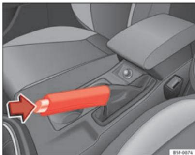
Abb. 119 Handbremse zwischen den Vordersitzen
