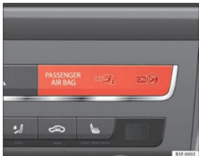
Abb. 29 Kontrollleuchte für Abschaltung des Beifahrerairbags
