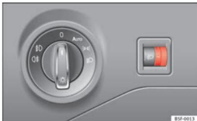
Abb. 67 Neben dem Lenkrad: Regler für die Leuchtweitenregulierung.
