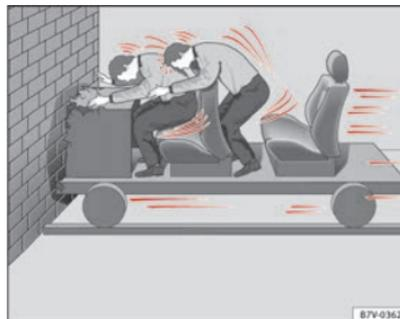
**Abb. 9** Prinzipdarstellung: Das Fahrzeug prallt mit nicht angegurten Insassen gegen die Mauer
