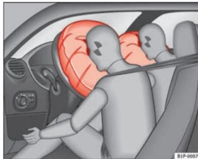
Abb. 21 Aufgeblasene Frontairbags
