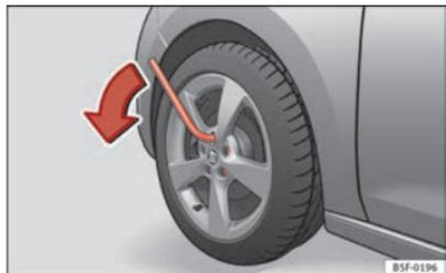
Abb. 168 Rad: Radschrauben lockern
