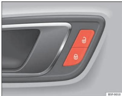
Abb. 52 Fahrertür: Zentralverriegelungsschalter
