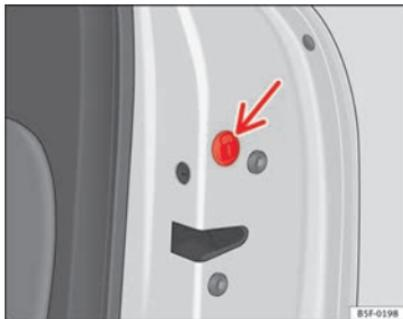
**Abb. 56 Tür notverriegeln**
