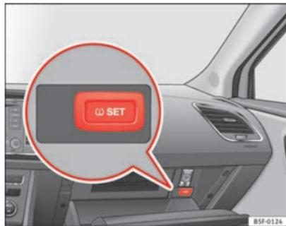
Abb. 147 Handschuhfach: Schalter Reifenkontrollanzeige
