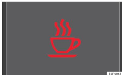
Abb. 145 Im Display des Kombi-Instruments: Symbol der Müdigkeitserkennung.
