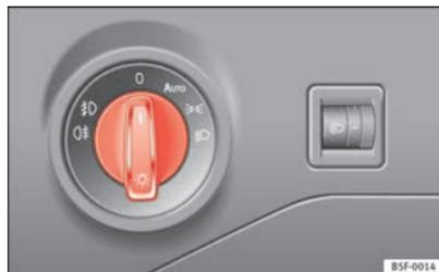
Abb. 65 In der Instrumententafel: Lichtschalter
