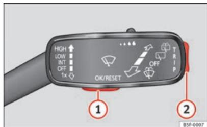
Abb. 42 Fahrzeuge ohne Multifunktionslenkrad: Taste ① im Scheibenwischerhebel zum Bestätigen von Menüpunkten und Wipptaste ② zum Wechseln der Menüs.
