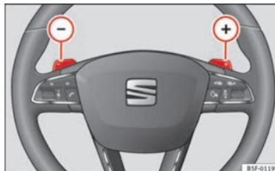
Abb. 124 Lenkrad: die Hebel für Automatikgetriebe
