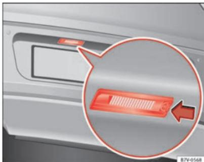
Abb. 198 Im Stoßfänger hinten: Kennzeichenbeleuchtung
