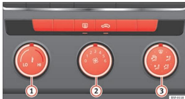
Abb. 115 Mittelkonsole: Systembedienungen für Heiz- und Frischluft
