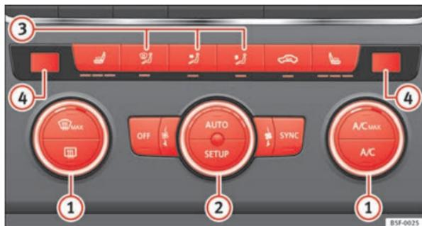
Abb. 113 In der Mittelkonsole: Bedienelemente der Climatronic.
