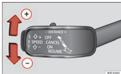
Abb. 133 Links an der Lenksäule: Dritter Hebel zur Bedienung der adaptiven Geschwindigkeitsregelung.
