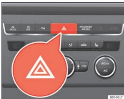
Abb. 66 Ausschnitt von der Instrumententafel: Schalter für die Warnblinkanlage
