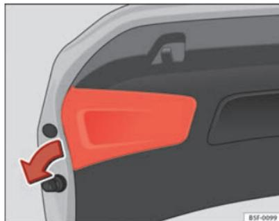
Abb. 195 Abdeckung der Gepäckraumklappe entfernen
