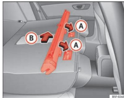
Abb. 100 Einbau der Netztrennwand an den Rücksitzlehnen
