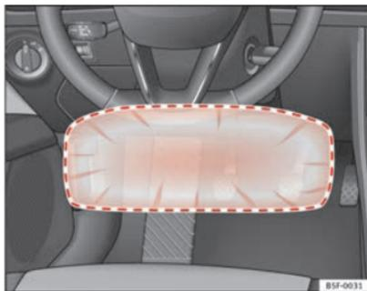
Abb. 24 Auf der Fahrerseite: Wirkungsbereich des Knieairbags.
