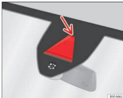
Abb. 143 An der Frontscheibe: Kamerasichtfenster des Spurhalteassistenten.
