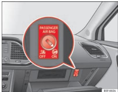
Abb. 28 Schalter für Beifahrer-Frontairbag
