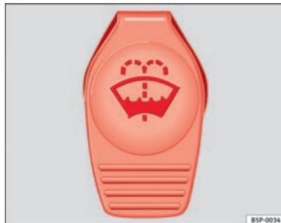
Abb. 74 Im Motorraum: Deckel des Scheibenwaschbehälters.
