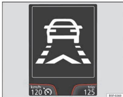
Abb. 140 Im Display des Kombiinstrumentes: Anzeige der Vorwarnung.
