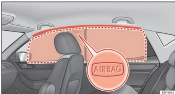
Abb. 27 Einbauort der Kopfairbags
