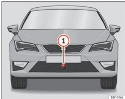
Abb. 131 Im vorderen Stoßfänger: Radarsensor.
