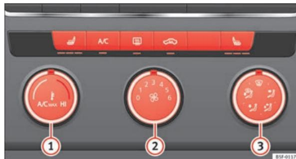
Abb. 114 In der Mittelkonsole: Bedienelemente der manuellen Klimaanlage.
