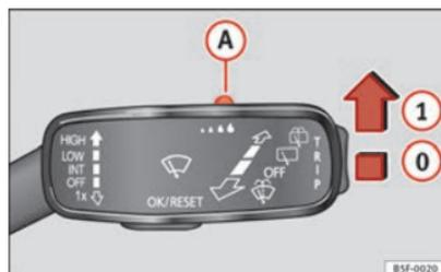
Abb. 72 Scheibenwischerhebel: Regensensor ① einstellen
