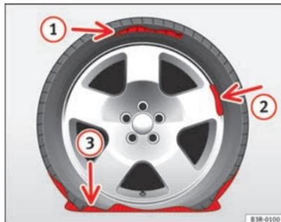
Abb. 163 Reifen: irreparable Schäden
