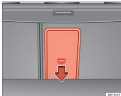
**Abb. 103** Im Gepäckraum: Öffnung der Durchladeeinrichtung.
