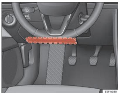
Abb. 23 Auf der Fahrerseite: Einbauort des Knieairbags.
