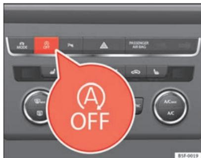
Abb. 120 Mittelkonsole: Systemtaste Start-Stopp
