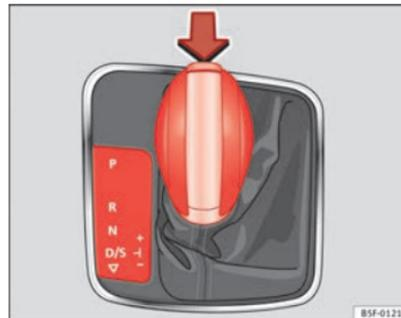
Abb. 122 Wählhebelsperre
