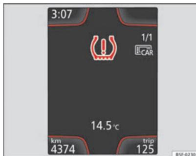
**Abb. 146 Kombiinstrument: Warnung Reifendruckverlust**
