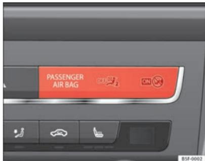
Abb. 18 Kontrollleuchte in der Instrumententafel für abgeschalteten Beifahrer-Frontairbag.
