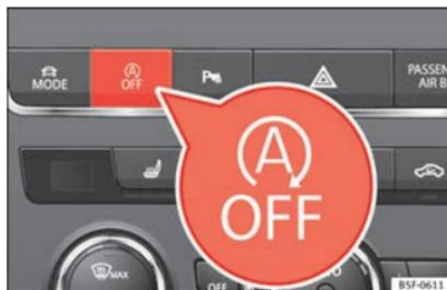
**Fig. 147** Consola central: tecla del sistema Start-Stop.
