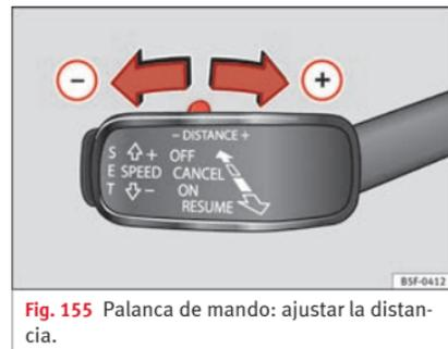
Fig. 155 Palanca de mando: ajustar la distancia.
