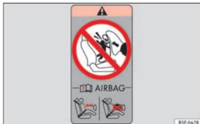
Fig. 77 En el marco posterior de la puerta del acompañante: adhesivo relativo al airbag.
