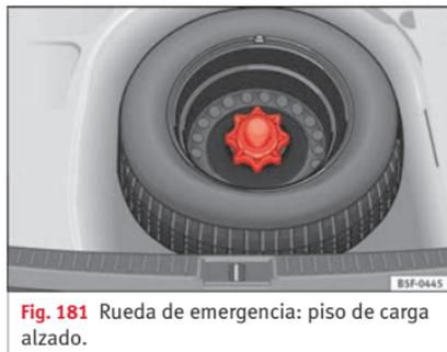
**Fig. 181** Rueda de emergencia: piso de carga alzado.
