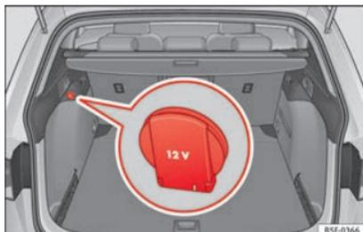
Fig. 118 Detalle del revestimiento lateral del maletero: toma de corriente de 12 voltios (válido sólo para el modelo LEON ST).
