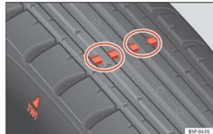
Fig. 177 Perfil del neumático: indicadores de desgaste.
