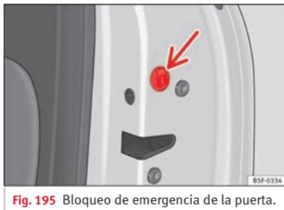
Fig. 195 Bloqueo de emergencia de la puerta.
