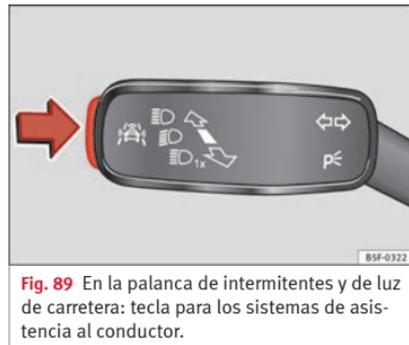
**Fig. 89** En la palanca de intermitentes y de luz de carretera: tecla para los sistemas de asistencia al conductor.
