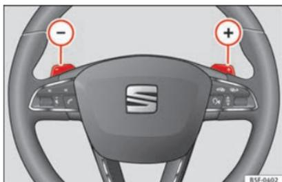
**Fig. 145** Volante: palancas para cambio automático.
