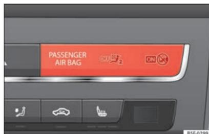
**Fig. 75** Testigo para desconexión de airbag del acompañante.
