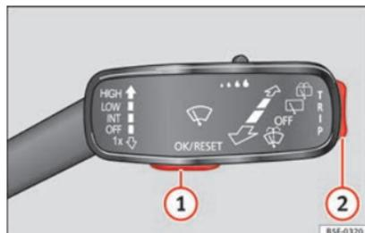
Fig. 87 Palanca del limpiaparabrisas: teclas de control.
