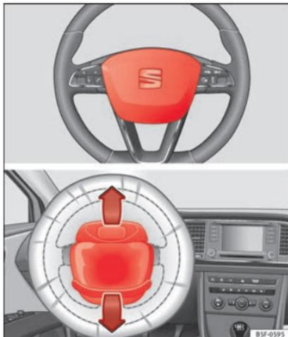
Fig. 66 Airbag del conductor en el volante.
