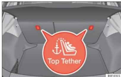
Fig. 79 Posición de las anillas Top Tether en la parte posterior del asiento trasero.
