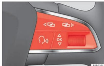
Fig. 88 Lado derecho del volante multifunción: teclas de control.
