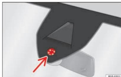
**Fig. 104** Superficie sensible del sensor de lluvia.
