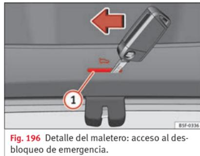
Fig. 196 Detalle del maletero: acceso al desbloqueo de emergencia.
