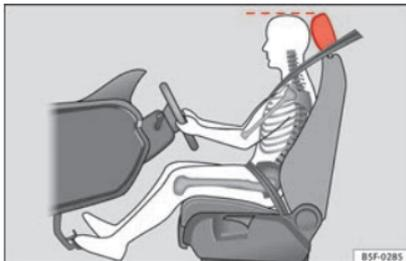
**Fig. 56** Posición correcta del apoyacabezas del conductor.
