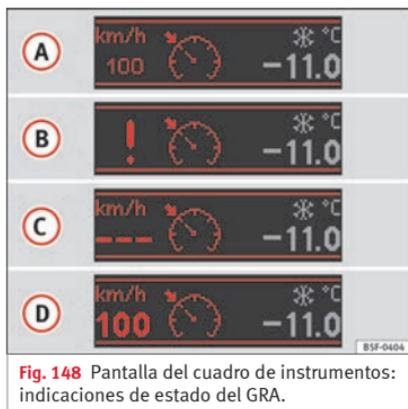
Fig. 148 Pantalla del cuadro de instrumentos: indicaciones de estado del GRA.
