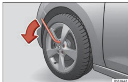
**Fig. 185** Rueda: aflojar los tornillos de rueda.
