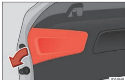
**Fig. 220** Retirar la cubierta del portón del maletero.
