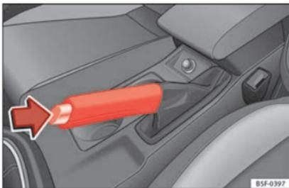
Abb. 142 Handbremse zwischen den Vordersitzen.
