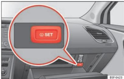
**Abb. 180** Handschuhfach: Schalter Reifenkontrollanzeige.
