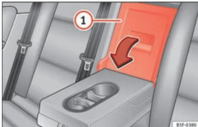
**Abb. 128** An der Rücksitzlehne: Öffnung der Durchladeeinrichtung.
