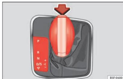
Abb. 143 Wählhebelsperre.
