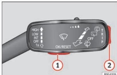
**Abb. 87** Scheibenwischerhebel: Steuertasten.
