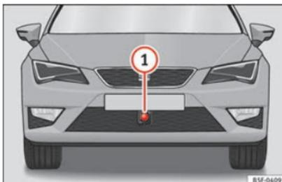
Abb. 151 Im vorderen Stoßfänger: Radarsensor.
