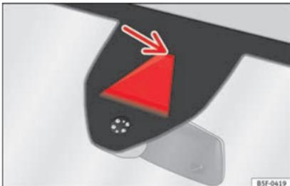
Abb. 164 Kameravisualisierung des Spurhalteassistenten.
