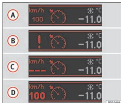
**Abb. 148** Display des Kombiinstruments: Zustandsanzeigen der GRA.
