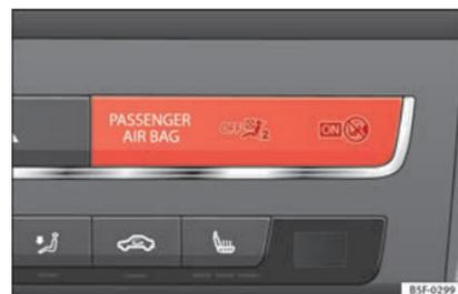
Abb. 73 Kontrollleuchte in der Instrumententafel für abgeschalteten Beifahrer-Frontairbag.
