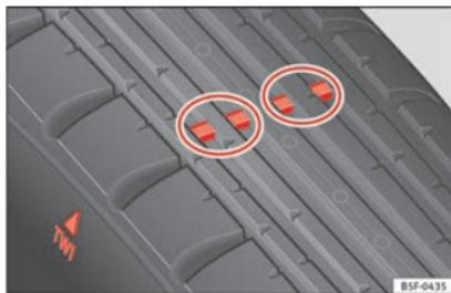
Abb. 177 Reifenprofil: Verschleißanzeiger.
