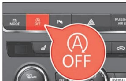
**Abb. 147** Mittelkonsole: Systemtaste Start-Stopp.
