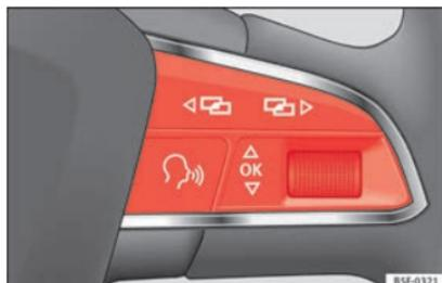
**Abb. 88** Rechte Seite Multifunktions-Lenkrad: Steuertasten.
