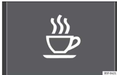
**Abb. 167** Im Display des Kombiinstrumentes: Symbol der Müdigkeitserkennung.
