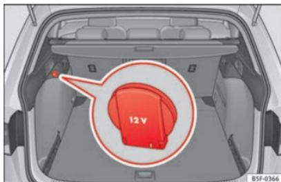
Abb. 118 Detail an der Seiteninnenverkleidung des Kofferraums: Steckdose 12 V (gilt nur für das Modell LEON ST).
