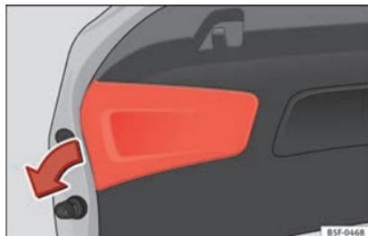
**Abb. 220** Abdeckung der Gepäckraumklappe entfernen
