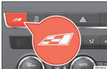
**Abb. 166** Mittelkonsole: Taste Cupra Drive Profile
