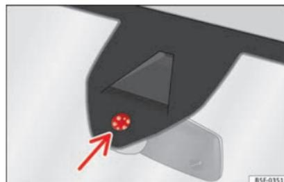
Abb. 104 Sensitive Fläche des Regensensors.
