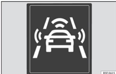
**Abb. 161** Im Display des Kombiinstrumentes: Anzeige der Vorwarnung.
