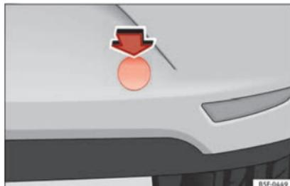
**Abb. 192** Hinterer Stoßfänger rechts: Abdeckkappe-Deckel.
