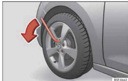
**Abb. 185** Rad: Radschrauben lockern.
