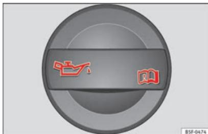
**Abb. 176** Deckel der Motoröl-Einfüllöffnung im Motorraum
