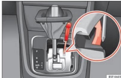
Bei einem Ausfall der Stromversorgung kann der Wählhebel notentriegelt werden.
