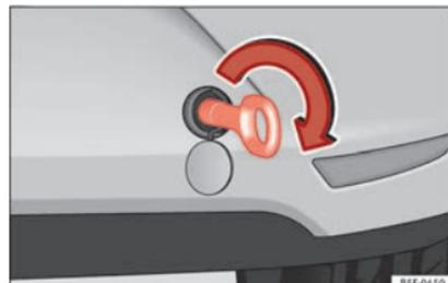
**Abb. 193** Hinterer Stoßfänger rechts: Eingeschraubte Abschleppöse
