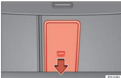
**Abb. 129** Im Gepäckraum: Öffnung der Durchladeeinrichtung.
