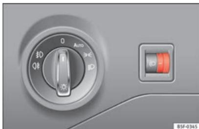
**Abb. 100** Neben dem Lenkrad: Regler für die Leuchtweitenregulierung.
