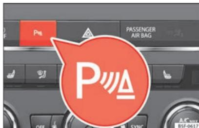
Abb. 169 Mittelkonsole: Taste für Einparkhilfe.
