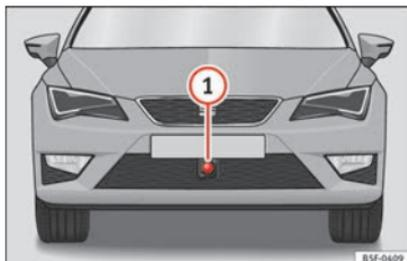
**Abb. 159** Im vorderen Stoßfänger: Radarsensor.
