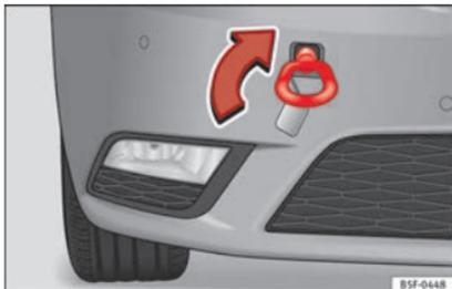
**Abb. 191** Vorderer Stoßfänger rechts: Eingeschraubte Abschleppöse
