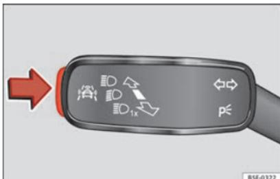
**Abb. 89** Am Blinker- und Fernlichthebel: Taste für die Fahrerassistenzsysteme.
