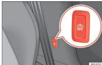
**Abb. 96** Taste für Innenraum-/Abschleppschutzüberwachung
