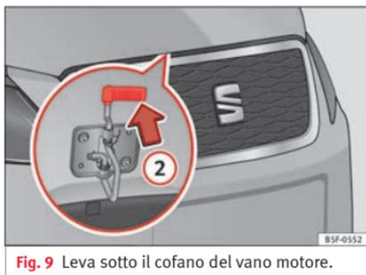
Fig. 9 Leva sotto il cofano del vano motore.
