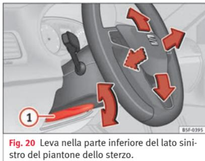
Fig. 20 Leva nella parte inferiore del lato sinistro del piantone dello sterzo.
