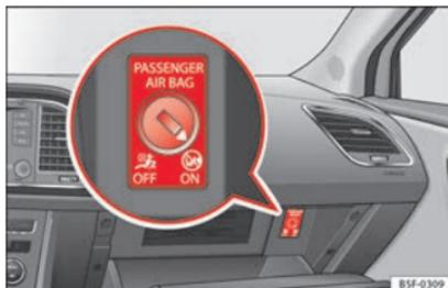
**Fig. 95** Commutatore dell'airbag frontale del passeggero.
