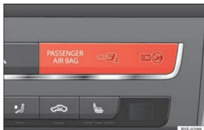
**Fig. 94** Spia di controllo sul cruscotto per la disattivazione dell'airbag frontale del passeggero.
