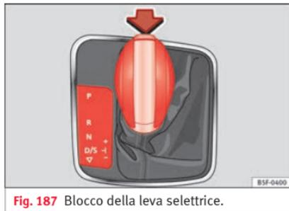
Fig. 187 Blocco della leva selettoria.
