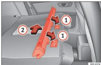
**Fig. 168** Montaggio della rete divisoria sugli schienali del sedile posteriore.
