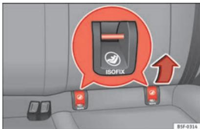
**Fig. 32** Occhielli di fissaggio del sistema ISOFIX.
