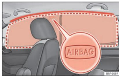
Fig. 28 Posizione degli airbag per la testa.
