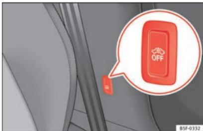
Fig. 136 Tasto dell'antifurto volumetrico/del dispositivo di controllo antiraino.
