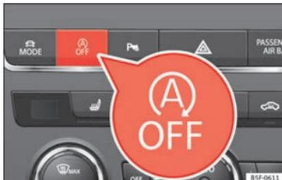
**Fig. 191** Console centrale: tasto del sistema Start/Stop.
