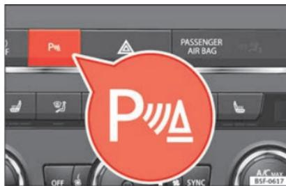
**Fig. 214** Console centrale: tasto dell'assistenza per il parcheggio.
