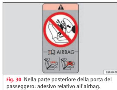
Fig. 30 Nella parte posteriore della porta del passeggero: adesivo relativo all'airbag.
