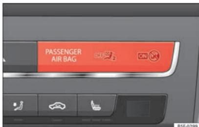
**Fig. 96** Spia per la disattivazione dell'airbag del passeggero.
