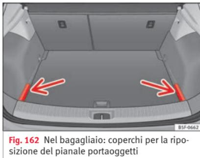
**Fig. 162** Nel bagagliaio: coperchi per la riposizione del pianale portaoggetti
