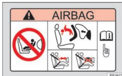
Fig. 29 Aletta parasole lato passeggero: adesivo dell'airbag.
