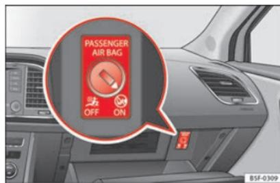
**Fig. 23** Commutatore dell'airbag frontale del passeggero.
