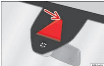
**Fig. 208** Nel parabrezza: area del campo visivo della telecamera del dispositivo di assistenza per il mantenimento della corsia.
