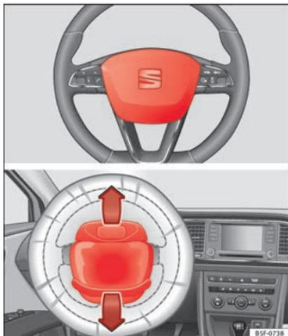
**Fig. 21** Airbag del conducente all'interno del volante.
