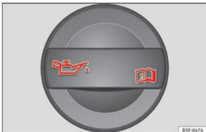
Fig. 236 Vano motore: tappo del bocchettone di rifornimento dell'olio motore.
