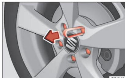
Fig. 71 Ruota: viti della ruota con tappi.
