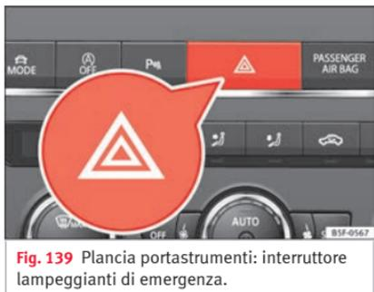
**Fig. 139** Plancia portastrumenti: interruttore lampeggianti di emergenza.
