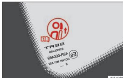
Fig. 87 Etichetta di avvertimento della posizione del poggiatesta.
