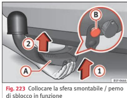
Fig. 223 Collocare la sfera smontabile / perno di sblocco in funzione
