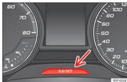
**Fig. 125** Quadro strumenti: contachilometri e tasto di azzeramento.
