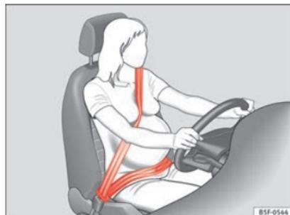
**Fig. 93** Posizione del nastro della cintura di sicurezza per donne in stato di gravidanza.
