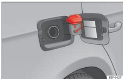
**Fig. 59** Sportellino del serbatoio con all'interno il tappo.
