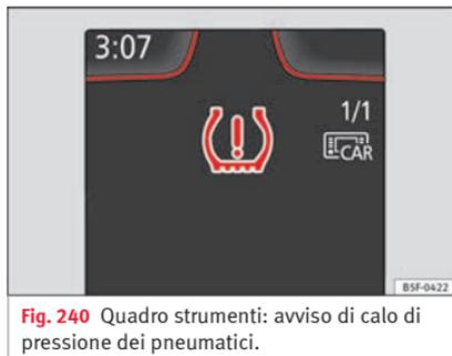
Fig. 240 Quadro strumenti: avviso di calo di pressione dei pneumatici.
