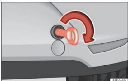
**Fig. 77** Paraurti posteriore destro: occhio di traino avvitato.
