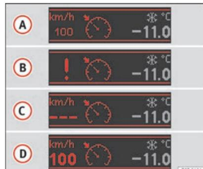
**Fig. 192** Display del quadro strumenti: indicazioni sullo stato del GRA.
