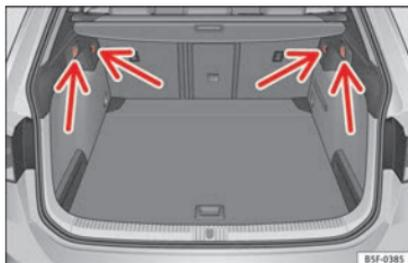
**Fig. 175** Nel bagagliaio: ganci per borse (modello LEON ST).
