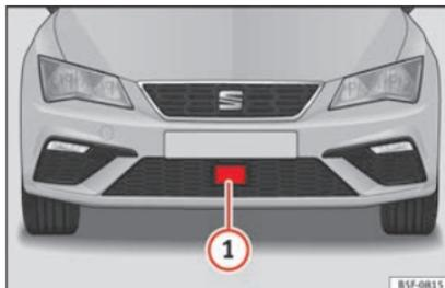
**Fig. 199** No para-choques à frente: sensor de radar.
