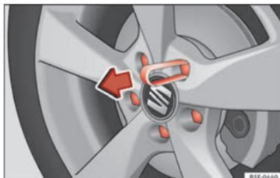
**Fig. 70** Roda: parafusos da roda com capas de proteção.
