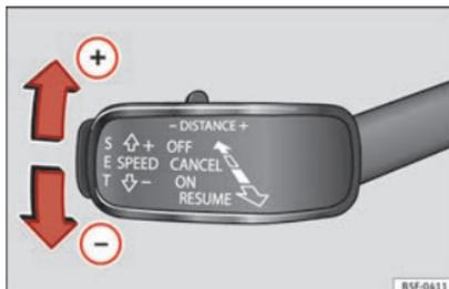
Fig. 201 À esquerda da coluna de direção: terceira alavanca para utilizar o controle adaptativo de velocidade.
