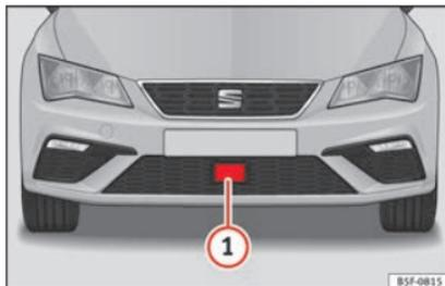
**Fig. 208** No para-choques à frente: sensor de radar.
