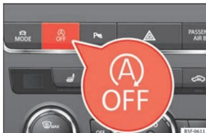
**Fig. 194** Consola central: botão do sistema Start/Stop.
