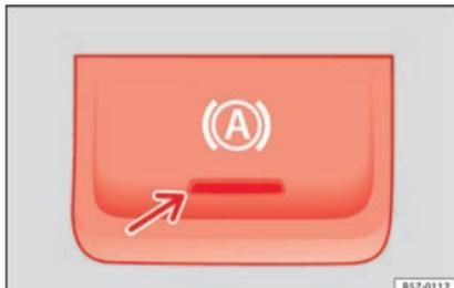
**Fig. 195** Na parte inferior da consola central: tecla da função Auto Hold.
