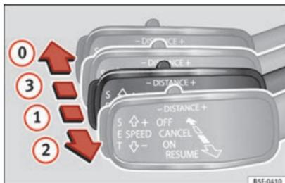
Fig. 200 À esquerda da coluna de direção: terceira alavanca para utilizar o controle adaptativo de velocidade.
