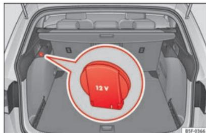
Fig. 158 Pormenor do revestimento lateral da bagageira: tomada de corrente de 12 Volts (válido apenas para o modelo LEON ST).
