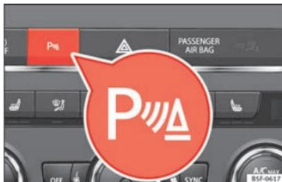
**Fig. 220** Consola central: botão de auxílio de estacionamento.
