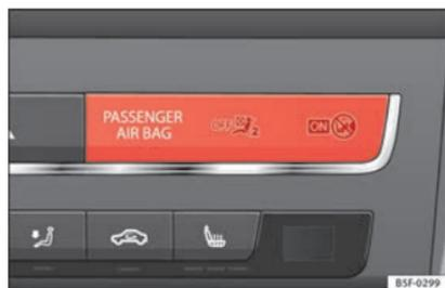
Fig. 51 Luz de controlo para desativação do airbag do passageiro.
