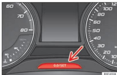
**Fig. 121** Painel de instrumentos: conta-quilómetros e botão de retrocesso.
