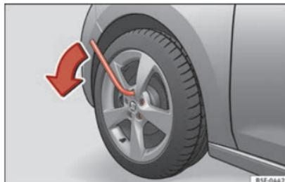
**Fig. 72** Roda: desapertar os parafusos da roda.
