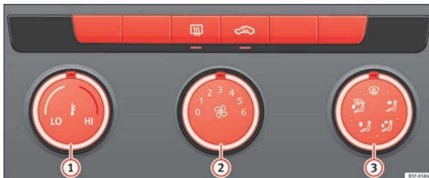
**Fig. 57** Na consola central: comandos do sistema de aquecimento e renovação do ar.
