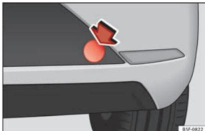
**Fig. 98** Para-choques traseiro, direita: tampa de cobertura.
