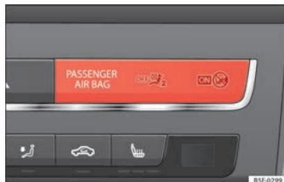
**Fig. 93** Luz de controlo, no painel de instrumentos, da desativação do airbag dianteiro do passageiro.
