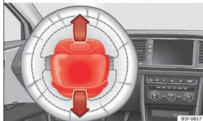
Fig. 20 Airbag do condutor no volante.
