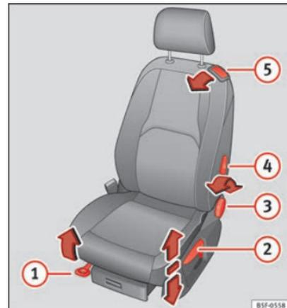
**Fig. 13** Bancos dianteiros: ajuste manual do banco.
