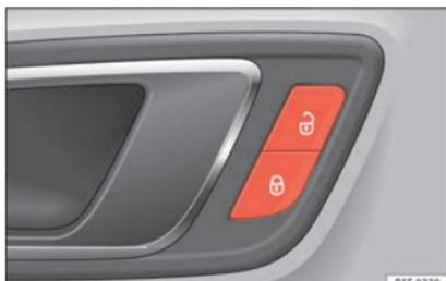
**Fig. 2** Porta do condutor: interruptor do fecho centralizado.
