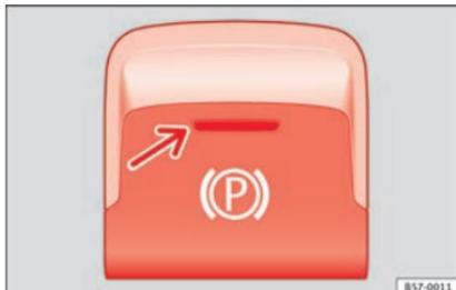
**Fig. 188** Na parte inferior da consola central: tecla do travão de estacionamento eletrónico.
