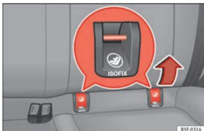
Fig. 31 Anéis de fixação ISOFIX.
