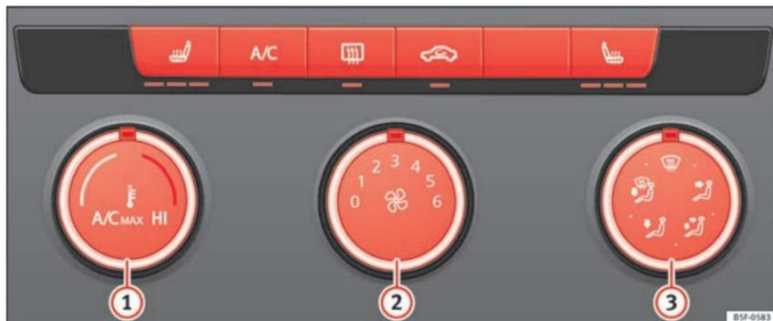
**Fig. 56** Na consola central: comandos do ar condicionado manual.
