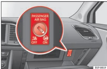
**Fig. 94** Interruptor do airbag frontal do passageiro.
