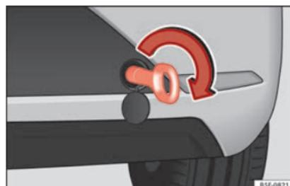
**Fig. 76** Para-choques traseiro, direita: argola de reboque enroscada.
