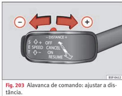
Fig. 203 Alavanca de comando: ajustar a distância.
