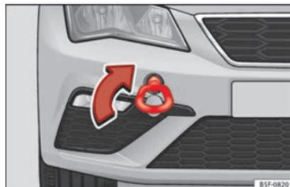
**Fig. 97** Para-choques dianteiro, direita: argola de reboque enroscada.
