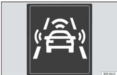
**Fig. 210** No ecrã do painel de instrumentos: indicação do pré-aviso.
