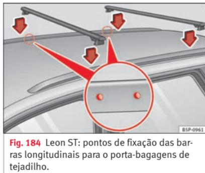
**Fig. 184** Leon ST: pontos de fixação das barras longitudinais para o porta-bagagens de tejadilho.
