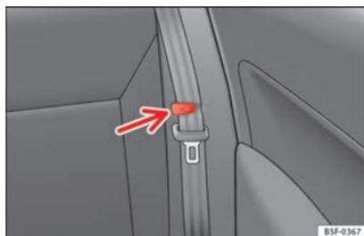
**Fig. 149** Morsetto per sostenere la cintura di sicurezza.
