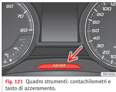
**Fig. 121** Quadro strumenti: contachilometri e tasto di azzeramento.
