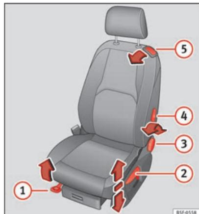
**Fig. 13** Sedili anteriori: regolazione manuale del sedile.
