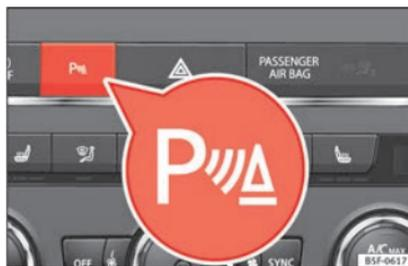
**Fig. 220** Consolle centrale: tasto dell'assistenza per il parcheggio.
