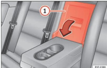
**Fig. 171** Sullo schienale del sedile posteriore: apertura della sponda.
