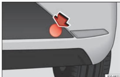
**Fig. 98** Paraurti posteriore destro: copertura.
