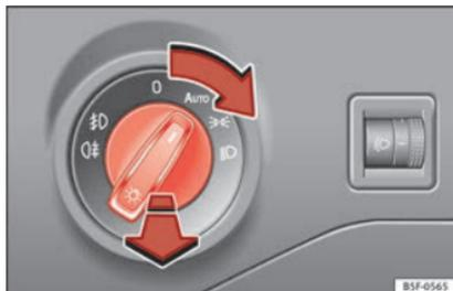
Fig. 35 Plancia portastrumenti: interruttore delle luci.
