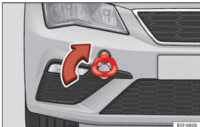
**Fig. 97** Paraurti anteriore destro: occhiello di traino avvitato.
