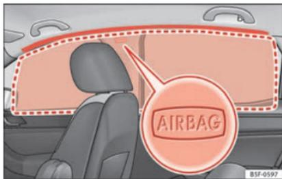
Fig. 27 Posizione degli airbag per la testa.
