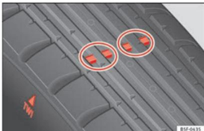
**Fig. 244** Spessore del battistrada dello pneumatico: indicatori di usura.
