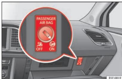
**Fig. 94** Commutatore dell'airbag frontale del passeggero.
