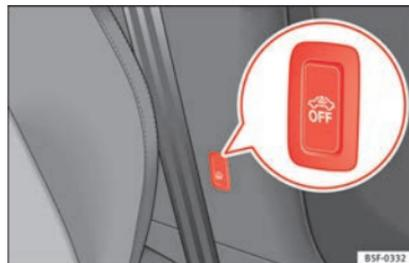
**Fig. 135** Tasto della protezione volumetrica dell'abitacolo/del dispositivo di controllo antitraino.
