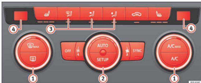
Fig. 55 Sulla consola centrale: comandi del Climatronic.
