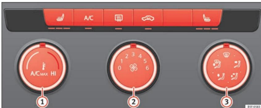
Fig. 56 Sulla console centrale: comandi manuali del climatizzatore.
