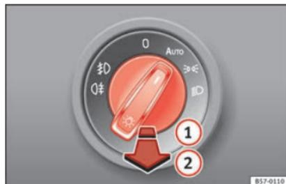
Fig. 138 Plancia portastrumenti: interruttore delle luci.
