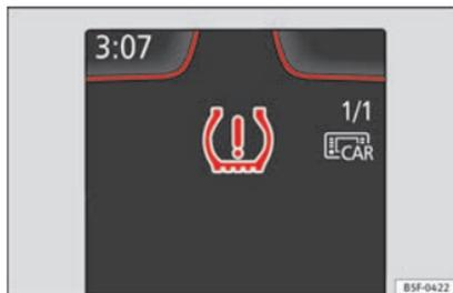
Fig. 246 Quadro strumenti: avviso di calo di pressione dei pneumatici.
