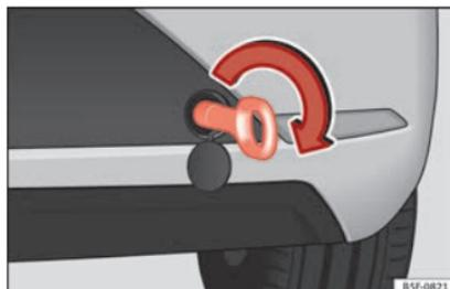
**Fig. 99** Paraurti posteriore destro: occhiello di traino avvitato.
