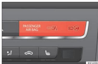
**Fig. 51** Spia per la disattivazione dell'airbag del passeggero.
