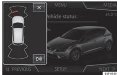
**Fig. 221** Indicazione in miniatura dell'attivazione automatica
