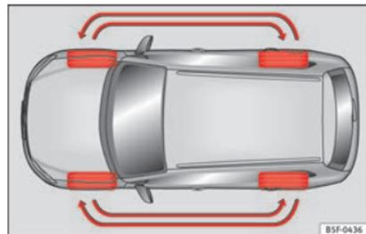
**Fig. 245** Scambio delle ruote.
