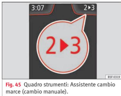
Fig. 45 Quadro strumenti: Assistente cambio marce (cambio manuale).
