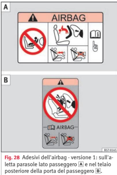
Fig. 28 Adesivi dell'airbag - versione 1: sull'alletta parasole lato passeggero **A** e nel telaio posteriore della porta del passeggero **B**.
