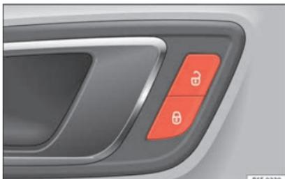
Fig. 2 Porta del conducente: interruttore della chiusura centralizzata.
