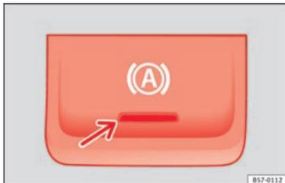
**Fig. 195** Nella parte inferiore della console centrale: tasto della funzione Auto Hold.
