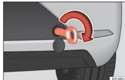
Fig. 76 Paraurti posteriore destro: occhio di traino avvitato.
