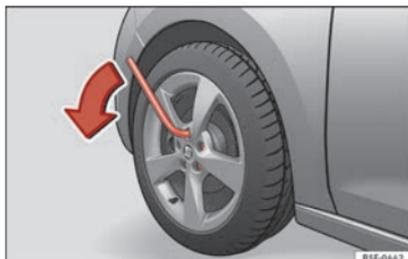
**Fig. 72** Ruota: allentare le viti della ruota.
