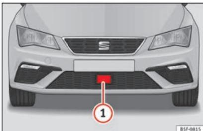
Fig. 199 Sul paraurti anteriore: sensore radar.
