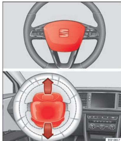
**Fig. 20** Airbag del conducente all'interno del volante.
