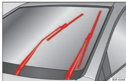
**Fig. 79** Tergicristalli in posizione di manutenzione.
