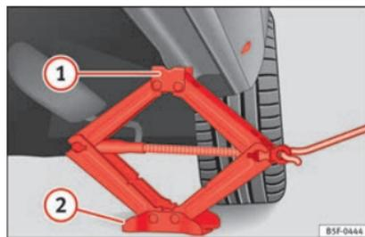
**Fig. 74** Longherone: posizionamento del cric del veicolo.
