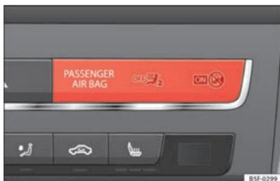
**Fig. 95** Spia per la disattivazione dell'airbag del passeggero.
