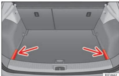
**Fig. 163** Nel bagagliaio: coperchi per la riposizione del pianale portaoggetti
