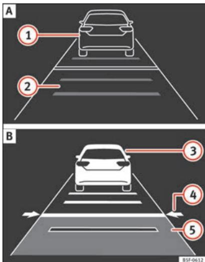
**Fig. 198** Sul display del quadro strumenti: (A) ACC temporaneamente inattivo, rilevamento veicolo precedente, distanza temporale regolata. (B) ACC attivo, rilevamento veicolo precedente, viene regolata una distanza temporale.
