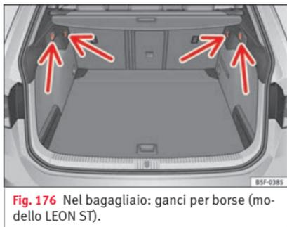
**Fig. 176** Nel bagagliaio: ganci per borse (modello LEON ST).
