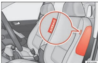
**Fig. 25** Airbag laterale all'interno del sedile del conducente.
