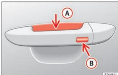
Fig. 131 Sistema di chiusura e avviamento senza chiave Keyless Access: superficie sensibile **A** di sblocco sulla parte interna della maniglia della porta e superficie sensibile **B** di blocco sulla parte esterna della maniglia.
