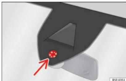
**Fig. 144** Superficie sensibile del sensore pioggia
