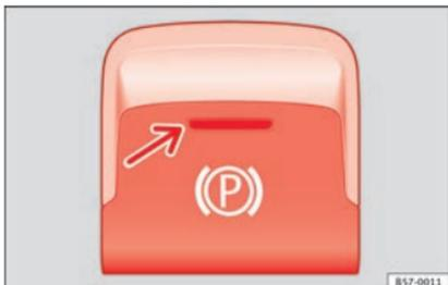
**Fig. 188** Nella parte inferiore della console centrale: tasto del freno di stazionamento elettronico.
