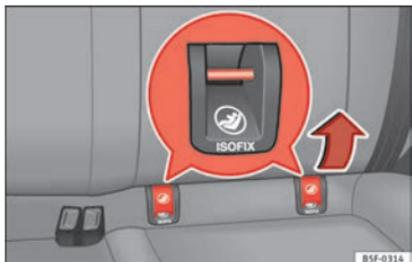
**Fig. 31** Occhielli di fissaggio del sistema ISOFIX.
