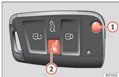
Fig. 129 Chiave del veicolo con pulsante di allarme.
