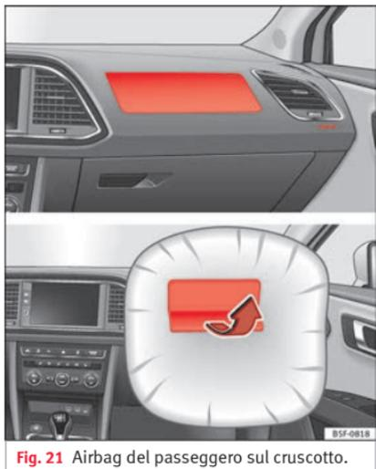
Fig. 21 Airbag del passeggero sul cruscotto.
