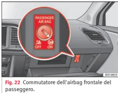
Fig. 22 Commutatore dell'airbag frontale del passeggero.
