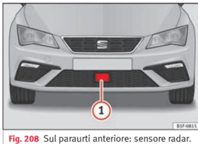
**Fig. 208** Sul paraurti anteriore: sensore radar.
