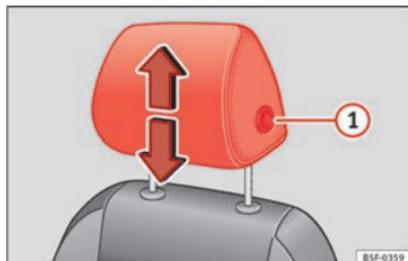
Fig. 15 Sedile anteriore regolazione del poggiatesta.
