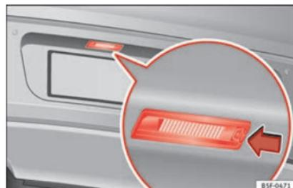
**Fig. 117** Nel paraurti posteriore: luce della targa.
