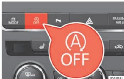
Fig. 194 Console centrale: tasto del sistema Start/Stop.
