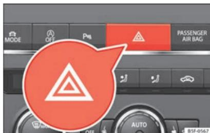
**Fig. 139** Plancia portastrumenti: interruttore lampeggio di emergenza.
