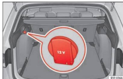
Fig. 158 Particolare del rivestimento laterale del bagagliaio: presa di corrente a 12 V (valido solo per il modello LEON ST).
