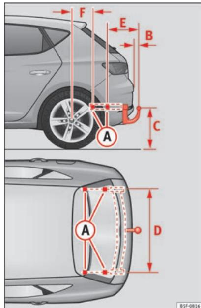
Fig. 238 Punti di ancoraggio per il dispositivo di traino.
