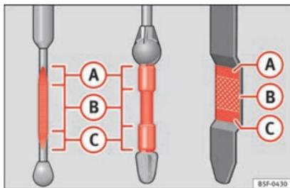
Fig. 59 Asta di misurazione livello olio motore
