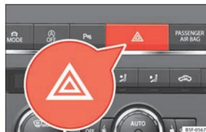
**Fig. 37** Plancia portastrumenti: interruttore lampeggio di emergenza.
