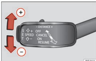
**Fig. 201** A sinistra del piantone dello sterzo: terza leva per utilizzare il sistema di regolazione automatica della velocità.
