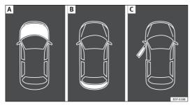
Fig. 39 A: bonnet open; B: rear lid open; C: front left door open.
