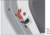
Fig. 53 Childproof lock on the left hand side door
