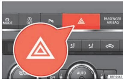
**Fig. 99** Plancia portastrumenti: interruttore lampeggianti di emergenza.
