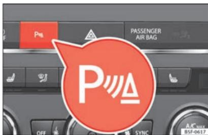
Fig. 169 Consolle centrale: tasto dell'assistenza per il parcheggio.
