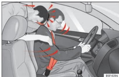
**Fig. 63** Se non indossa la cintura, il passeggero seduto sul sedile posteriore viene scagliato in avanti, colpendo il conducente (che invece indossa la cintura)
