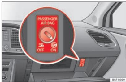
**Fig. 74** Commutatore dell'airbag frontale del passeggero.
