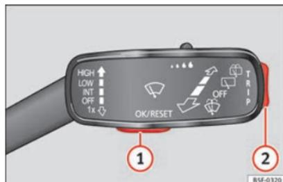
Fig. 87 Leva dell'impianto tergicristalli tasti di controllo.
