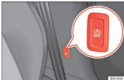
**Fig. 96** Tasto dell'antifurto volumetrico/del dispositivo di controllo antitraino.
