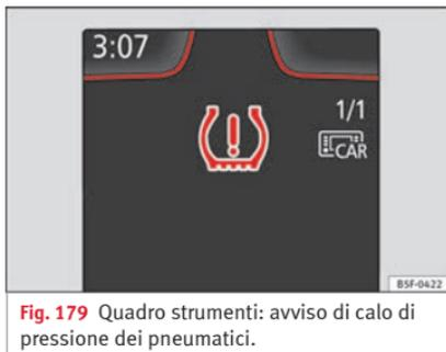
**Fig. 179** Quadro strumenti: avviso di calo di pressione dei pneumatici.
