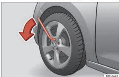
**Fig. 185** Ruota: allentare le viti della ruota.
