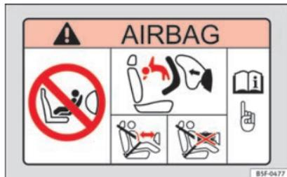
Fig. 76 Aletta parasole lato passeggero: adesivo dell'airbag.
