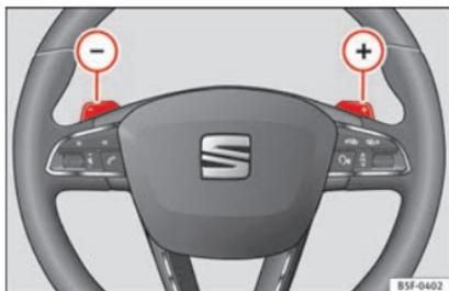
**Fig. 145** Volante: leve per il cambio automatico.
