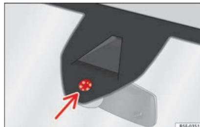
**Fig. 104** Superficie sensibile del sensore pioggia
