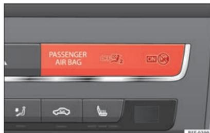
**Fig. 75** Spia per la disattivazione dell'airbag del passeggero.
