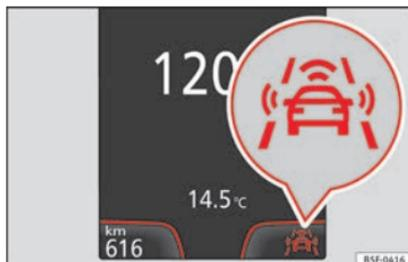
**Fig. 160** Sul display del quadro strumenti: indicazione di Front Assist disattivato.
