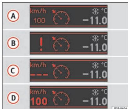
**Fig. 148** Display del quadro strumenti: indicazioni sullo stato del GRA.
