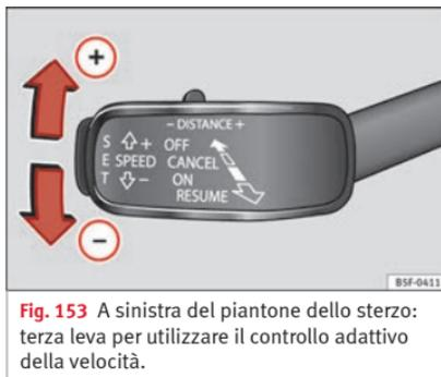
Fig. 153 A sinistra del piantone dello sterzo: terza leva per utilizzare il controllo adattivo della velocità.
