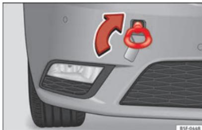
Fig. 191 Paraurti anteriore destro: occhiello di traino avvitato.
