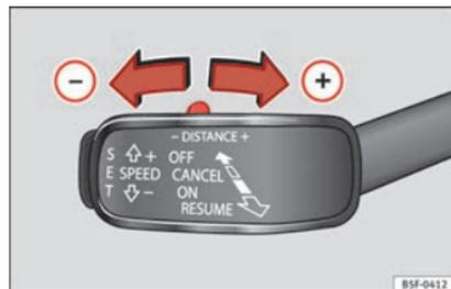
**Fig. 155** Leva di comando: regolare la distanza.
