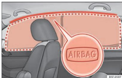
Fig. 72 Posizione degli airbag per la testa.
