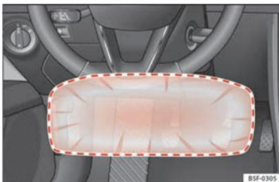
**Fig. 69** Sul lato del conducente: raggio d'azione dell'airbag per le ginocchia.
