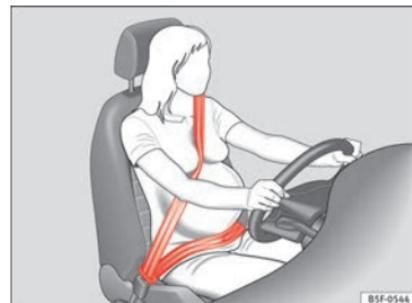
**Fig. 65** Posizione del nastro della cintura di sicurezza per donne in stato di gravidanza.
