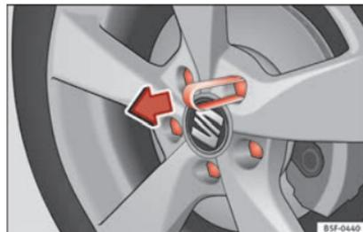
Fig. 183 Ruota: viti della ruota con tappi.
