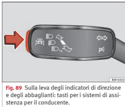
**Fig. 89** Sulla leva degli indicatori di direzione e degli abbaglianti: tasti per i sistemi di assistenza per il conducente.
