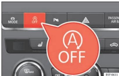
Fig. 147 Console centrale: tasto del sistema Start/Stop.
