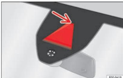
**Fig. 164** Nel parabrezza: area del campo visivo della telecamera del dispositivo di assistenza per il mantenimento della corsia.
