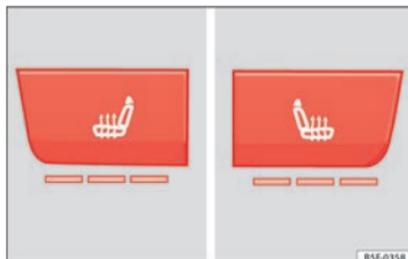
Fig. 107 Sulla console centrale: regolatore per il riscaldamento dei sedili anteriori.
