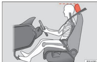
**Fig. 56** Corretto posizionamento del poggiatesta del conducente.
