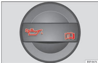
Fig. 176 Vano motore: tappo del bocchettone di rifornimento dell'olio motore.
