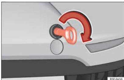
Fig. 193 Paraurti posteriore destro: occhio di traino avvitato.
