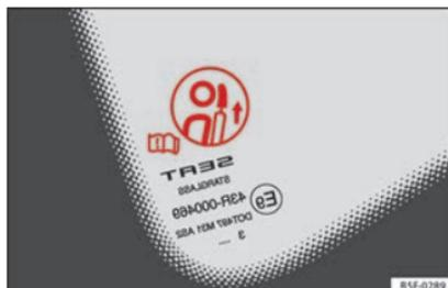
Fig. 59 Etichetta di avvertimento della posizione del poggiatesta.
