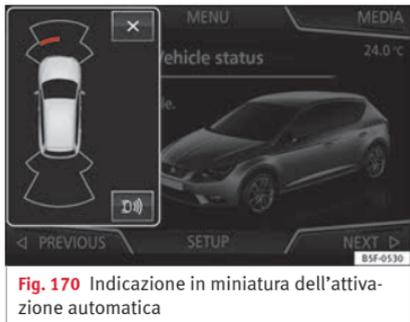
Fig. 170 Indicazione in miniatura dell'attivazione automatica
