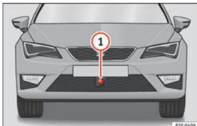
**Fig. 151** Sul paraurti anteriore: sensore radar.
