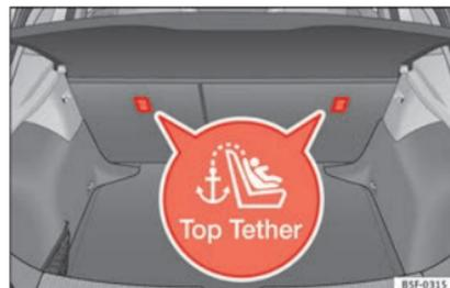
Fig. 79 Posizione degli occhielli Top Tether nella parte posteriore del sedile posteriore.
