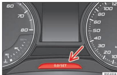
**Fig. 84** Quadro strumenti: contachilometri e tasto di azzeramento.
