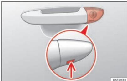
**Fig. 194** Maniglia della porta del conducente: serratura di chiusura nascosta.
