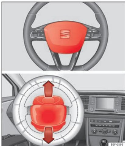
**Fig. 66** Airbag del conducente all'interno del volante.
