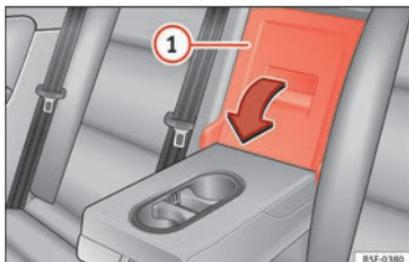
**Fig. 128** Sullo schienale del sedile posteriore: apertura della sponda.
