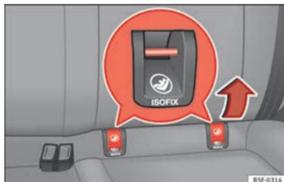
Fig. 78 Occhielli di fissaggio del sistema ISOFIX.
