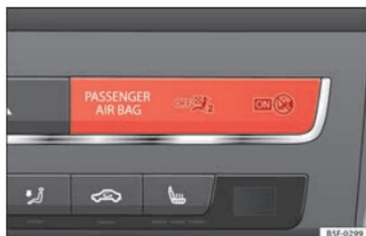
Fig. 73 Spia di controllo sul cruscotto per la disattivazione dell'airbag frontale del passeggero.
