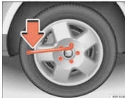
**Fig. 152** Substituição de uma roda: desapertar os parafusos das rodas
