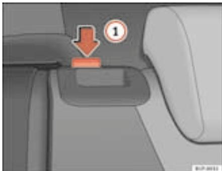
Fig. 93 Levantar o encosto do assento traseiro
