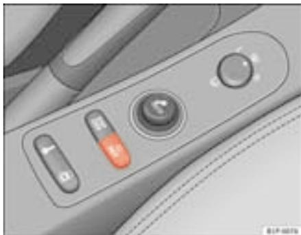
Fig. 47 Consola central: tecla do sistema de controlo dos pneus
