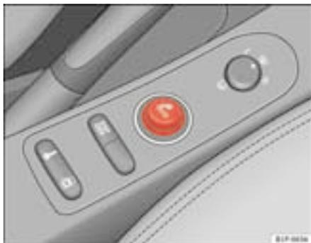
Fig. 99 Isqueiro alojado na tomada de corrente da consola central dianteira
