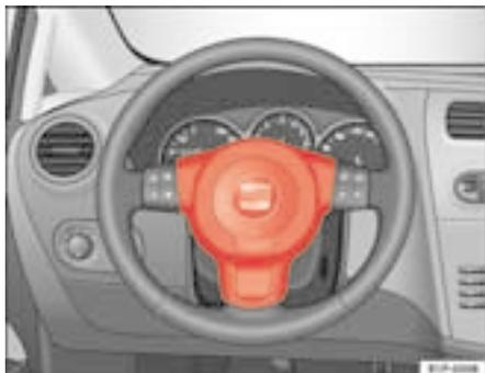
**Fig. 17** Airbag do condutor no volante
