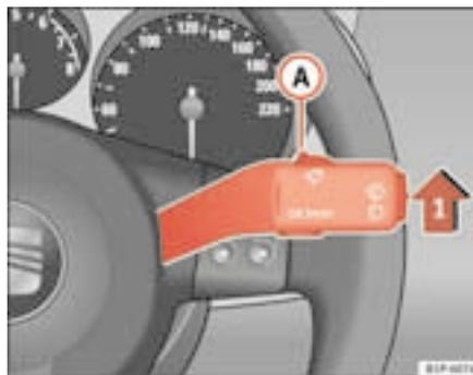
Fig. 83 Alavanca do limpa-vidros
