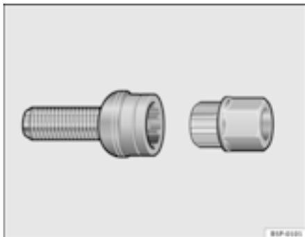
**Fig. 156 Parafusos anti-roubo das rodas**
