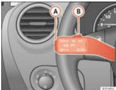
Fig. 122 Alavanca dos indicadores de direcção máximos: comando e interruptor basculante para o regulador de velocidade
