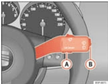
Fig. 40 Alavanca do limpa/lava-vidros: botão A e botão basculante B
