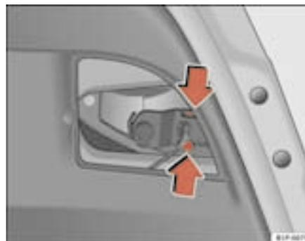
Fig. 169 Desmontagem do porta-lâmpadas
