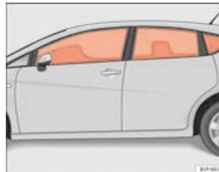
**Fig. 24 Airbags da cabeça activados**
