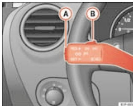
Fig. 125 Alavanca dos indicadores de direcção e máximos: comando e interruptor basculante para o regulador de velocidade
