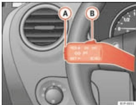
Fig. 124 Alavanca dos indicadores de direcção e máximos: comando e interruptor basculante para o regulador de velocidade
