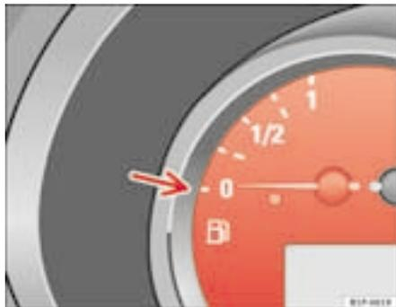
Fig. 33 Painel de instrumentos: indicador do nível do combustível
