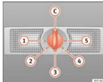
Fig. 79 Forro interior do tejadilho: iluminação interior e de leitura da parte traseira do habitáculo.
