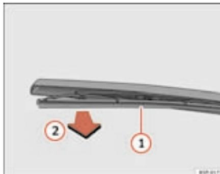
**Fig. 146** Substituir a escova do limpa-vidros traseiro
