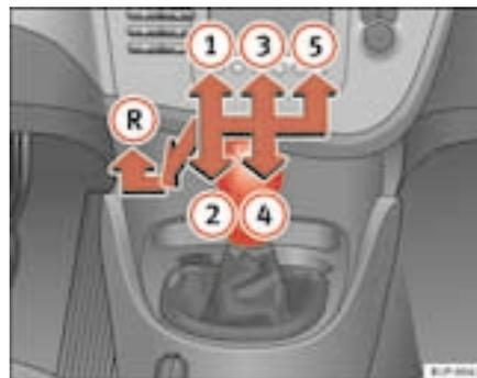
Fig. 114 Pormenor da consola central: esquema de uma caixa de manual com 5 velocidades
