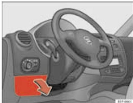
**Fig. 157** Tampa da caixa dos fusíveis no lado esquerdo do painel de instrumentos
