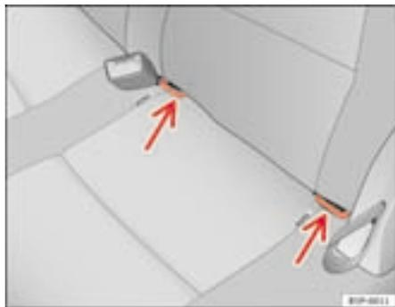
**Fig. 30 Anéis de fixação ISOFIX**
