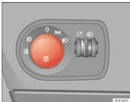
Fig. 72 Pormenor do painel de instrumentos: comando das luzes, faróis de nevoeiro e a luz traseira de nevoeiro
