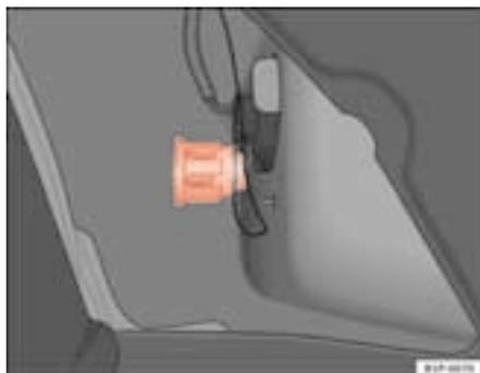
Fig. 167 Luz dos indicadores de direcção, presença e travagem na carroçaria
