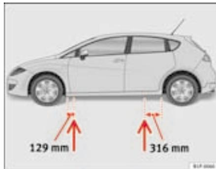
Fig. 153 Pontos de recepção do macaco
