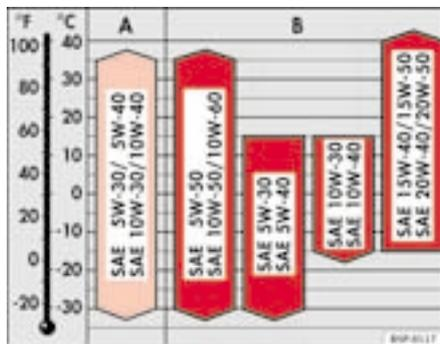
Fig. 140 Tipos de óleo de acordo com a temperatura
