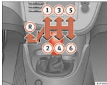
Fig. 115 Pormenor da consola central: esquema de uma caixa de manual com 6 velocidades ▶
