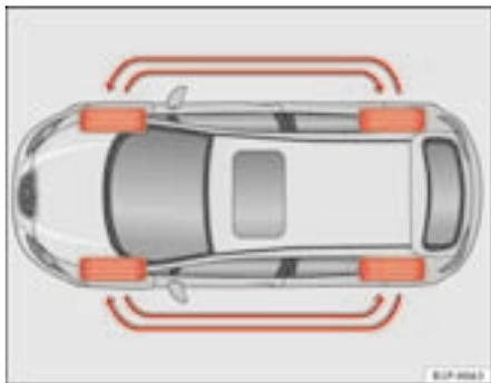
**Fig. 149** Esquema de troca dos pneus
