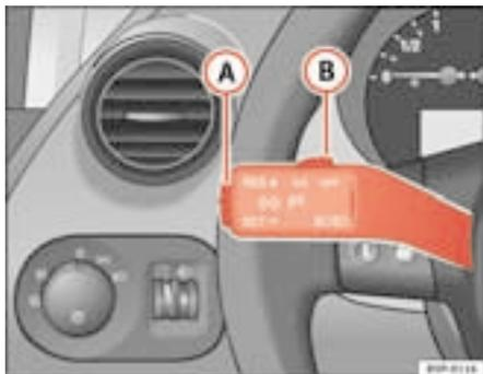
Fig. 126 Alavanca dos indicadores de direcção e máximos: comando e interruptor basculante para o regulador de velocidade
