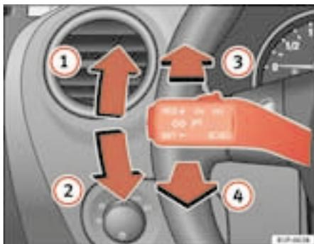
Fig. 76 Alavanca dos indicadores de direcção e dos máximos
