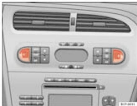
**Fig. 91** Rodas recartilhadas do aquecimento dos bancos dianteiros
