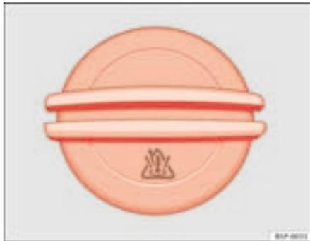
Fig. 143 Tampão do reservatório de expansão do líquido de refrigeração no compartimento do motor
