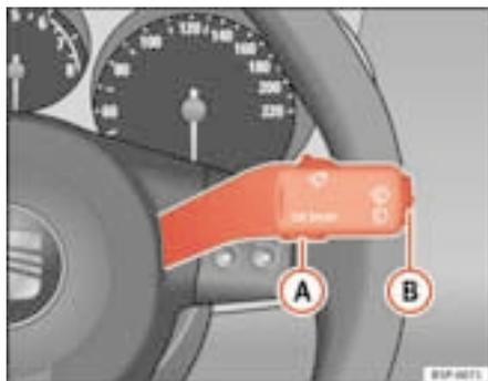
Fig. 44 Alavanca do limpavidros: tecla A para confirmar opções do menu e tecla basculante B para trocar de menu
