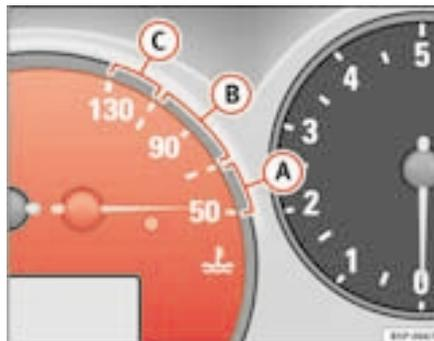
Fig. 34 Pormenor do painel de instrumentos: indicador da temperatura do líquido de refrigeração do motor
