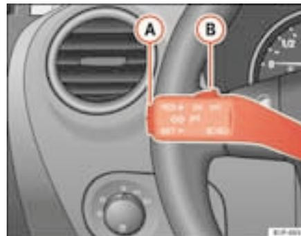
Fig. 123 Alavanca dos indicadores de direcção máximos: comando e interruptor basculante para o regulador de velocidade
