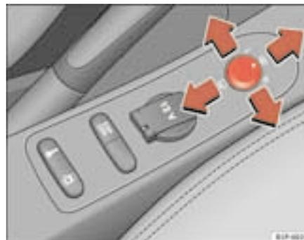
Fig. 86 Interruptor dos espelhos exteriores
