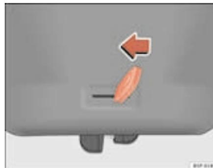
**Fig. 67** Tampa traseira: abertura de emergência
