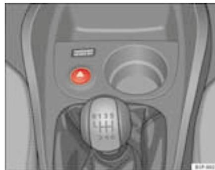
Fig. 75 Painel de instrumentos: interruptor das luzes de emergência
