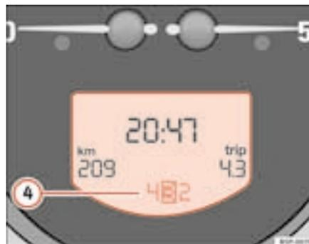
Fig. 36 Pormenor do painel de instrumentos: visor com indicador das velocidades do Tiptronic
