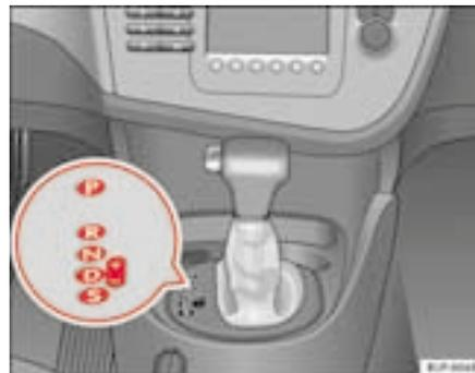
Fig. 116 Consola central: alavanca de selecção da caixa de velocidades automática / caixa de velocidades automática DSG
