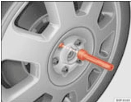
Fig. 155 Troca da roda: utensílio de sextavado interior para desapertar e apertar os parafusos
