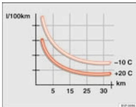
Fig. 135 Consumo de combustível em l/100km com dois níveis de temperatura ambiente
