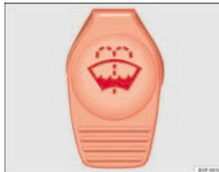
Fig. 144 Tampão do depósito do limpa-vidros no compartimento do motor.
