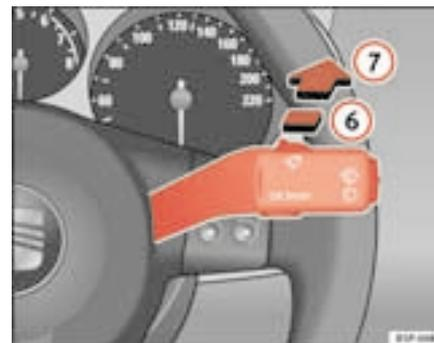
Fig. 84 Alavanca do limpa/lava-vidros: limpa-vidros traseiro
