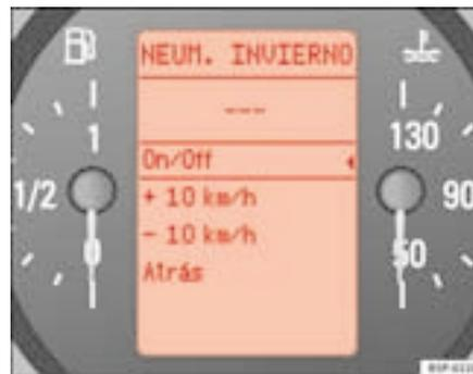
Fig. 45 Visor digital do painel de instrumentos: indicador de pneus Inverno
