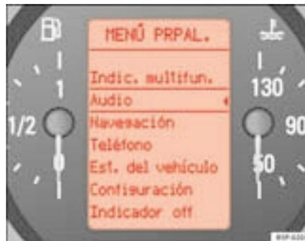
Fig. 43 Visor digital no painel de instrumentos: Menu principal
