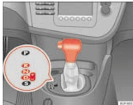
**Fig. 118** Desactivação do bloqueio
