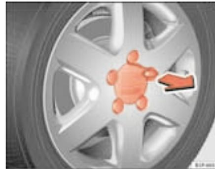
**Fig. 151** Trocar a roda: retirar os tampões das rodas
