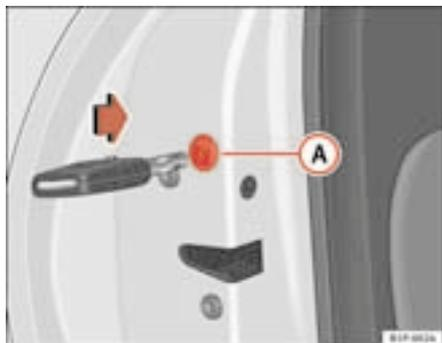
**Fig. 58** Fecho de emergência das portas
