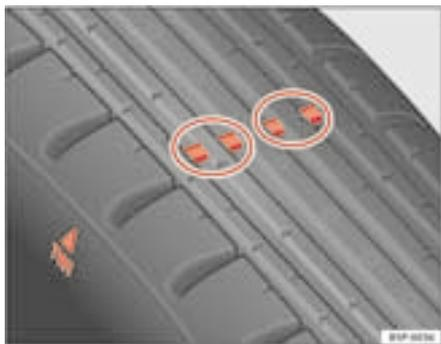
**Fig. 148** Perfil do pneu: indicador de desgaste
