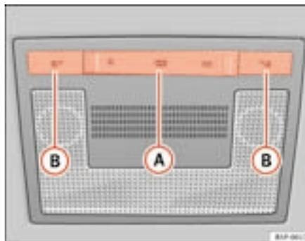
Fig. 77 Forro interior do tejadilho: iluminação dianteira do habitáculo
