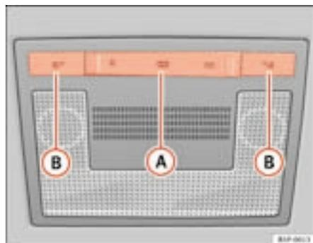
Fig. 78 Revestimento interior do tejadilho: luzes dianteiras
