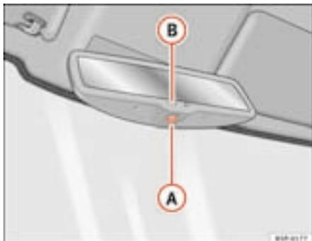
Fig. 85 Espelho interior com ajuste automático para posição de anti-encadeamento.
