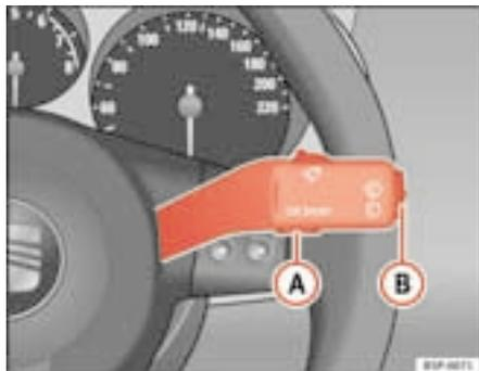
Fig. 38 Alavanca do limpa/lava-vidros: botão A e botão basculante B
