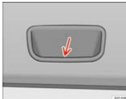
**Fig. 66** Pormenor do revestimento interior do porta-bagagens: reentrância para puxar
