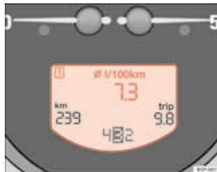
Fig. 41 Visor digital do painel de instrumentos: indicador do consumo médio de combustível.
