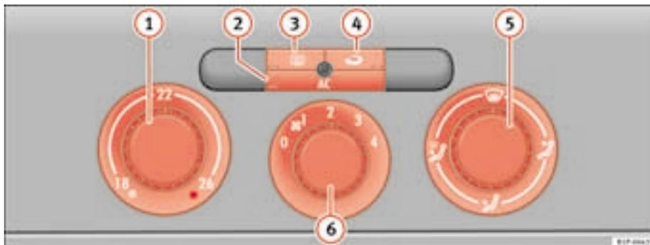
Fig. 107 Comandos do Climatic no painel de instrumentos
