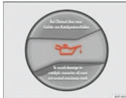
**Fig. 142** Tapón de la boca de llenado de aceite del motor en el vano motor
