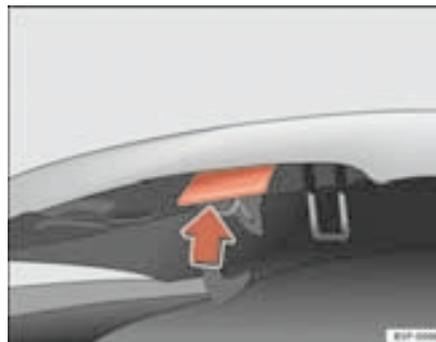
Fig. 139 Gancho apertura capó motor. ▶
