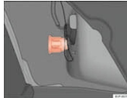
Fig. 167 Luz intermitente, población y freno en la carrocería ▶
