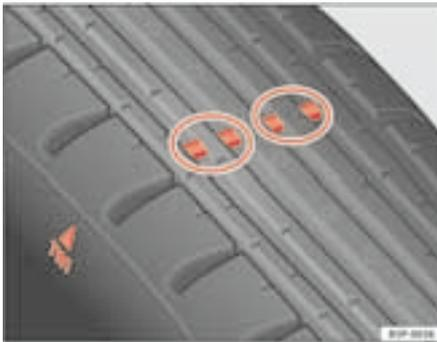
**Fig. 148** Indicadores de desgaste del perfil del neumático
