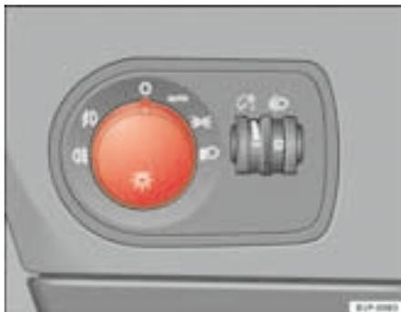
Fig. 73 Encendido automático de luces
