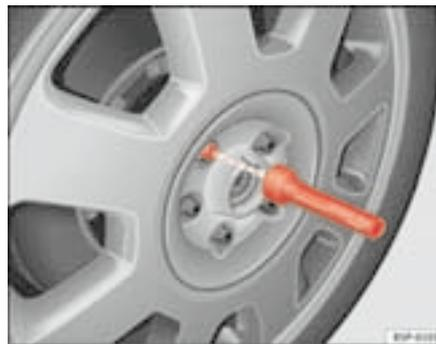
**Fig. 155 Cambio de rueda: Útil de hexágono interior para girar los tornillos**
