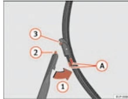
Fig. 145 Cambio de las escobillas del limpiaparabrisas
