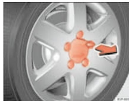
**Fig. 151** Cambio de rueda: Retirar el embellecedor de la rueda
