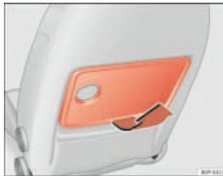
Fig. 96 Mesita plegable del asiento delantero izquierdo
