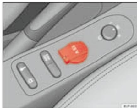
Fig. 100 Toma de corriente consola central delantera
