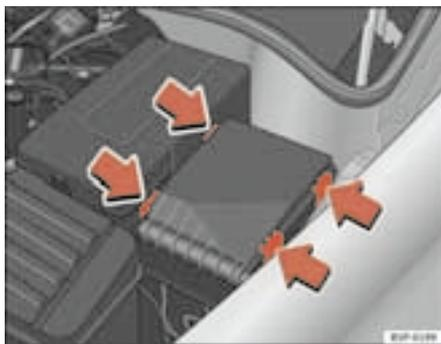
**Fig. 158** Tapa de la caja de fusibles en el compartimento motor
