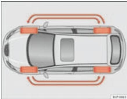
**Fig. 149** Esquema para el cambio de ruedas
