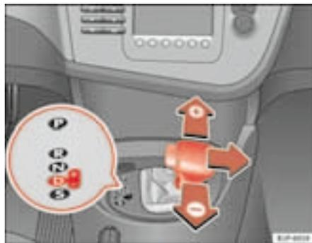
Fig. 120 Cambiar con tiptronic
