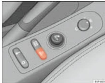
Fig. 47 Consola central: tecla del sistema de control de los neumáticos
