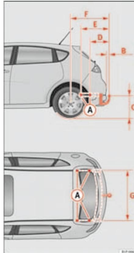
Fig. 136 Puntos de fijación del dispositivo de remolque
