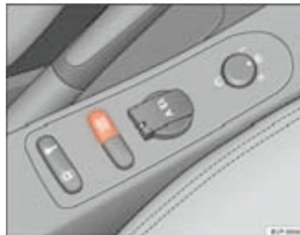
**Fig. 112** Detalle de la consola central: tecla ESP
