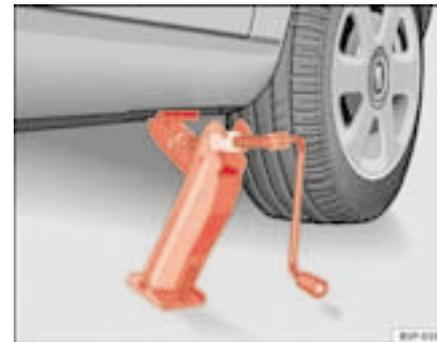
**Fig. 154** Colocación del gato
