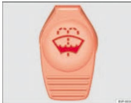
**Fig. 144** Tapón del depósito del lavacristales en el vano motor.
