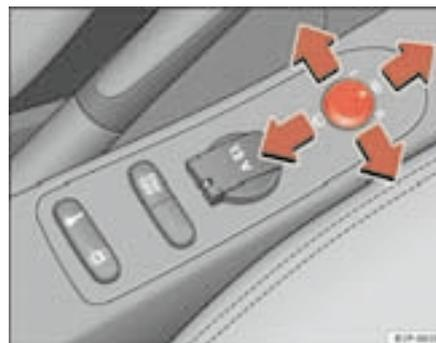
Fig. 86 Mando de los retrovisores exteriores ▶
