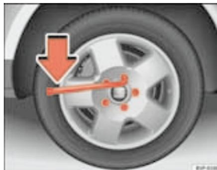
**Fig. 152** Cambio de rueda: aflojar los tornillos de rueda
