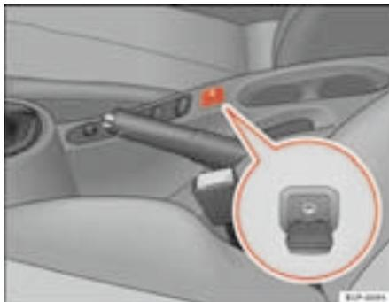
**Fig. 101** Conector para la entrada auxiliar de audio
