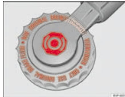
Fig. 147 Tapón del depósito del líquido de frenos en el vano motor
