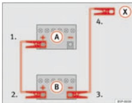
Fig. 177 Esquema de conexión de los cables de emergencia
