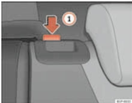
Fig. 93 Levantar el respaldo del asiento trasero
