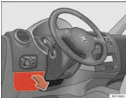
**Fig. 157** Tapa de la caja de fusibles en el lado izquierdo del tablero de instrumentos
