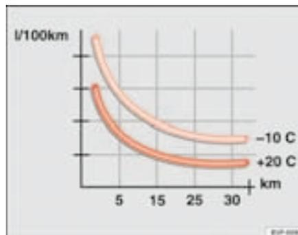
Fig. 135 Consumo de combustible (l/100 km) a dos temperaturas ambiente
