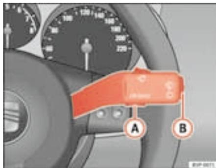
Fig. 42 Palanca del limpiacrystal: tecla A para confirmar opciones del menú y tecla basculante B para cambiar de menú
