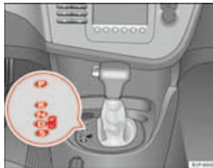
Fig. 116 Consola central: palanca selectora del cambio automático / cambio automático DSG
