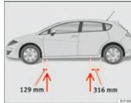
**Fig. 153** Puntos de apoyo del gato
