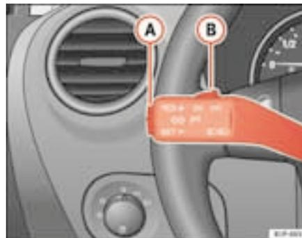
Abb. 124 Blinker- und Fernlichthebel: Schalter und Wippe für GRA
