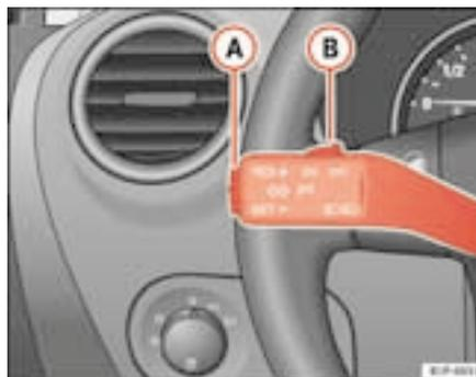
Abb. 122 Blinker- und Fernlichthebel: Schalter und Wippe für die GRA
