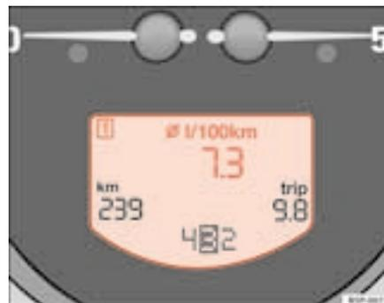
Abb. 39 Display im Kombiinstrument: Anzeige des durchschnittlichen Kraftstoffverbrauchs
