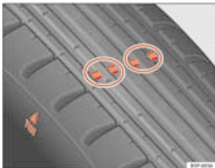
Abb. 148 Prinzipdarstellung Reifenprofil: Verschleißanzeiger
