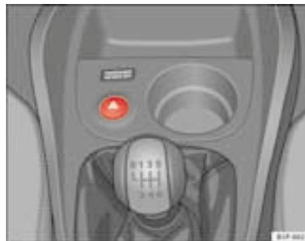
Abb. 75 Ausschnitt aus der Instrumententafel: Schalter für die Warnblinkanlage
