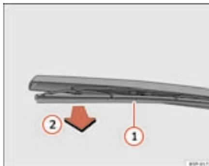
**Abb. 146** Scheibenwischerblatt hinten auswechseln
