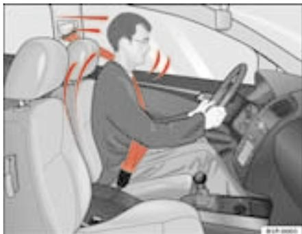
**Abb. 10** Angegurter Fahrer, der bei einem plötzlichen Bremsmanöver vom richtig angelegten Sicherheitsgurt aufgefangen wird
