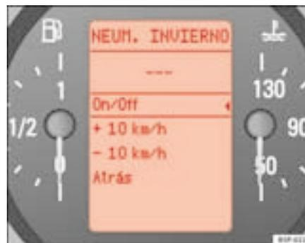
Abb. 45 Display im Kombiinstrument: Anzeige Winterreifen
