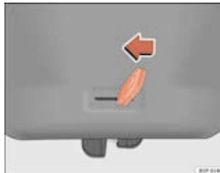
Abb. 67 Heckklappe: Notöffnung
