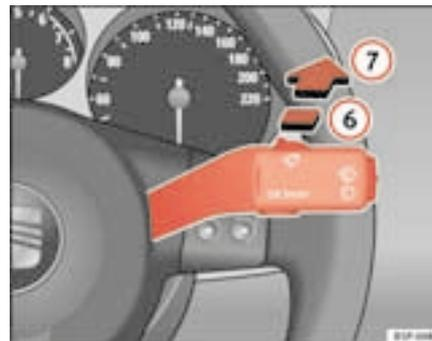
Abb. 84 Scheibenwischer- und Scheibenwascherhebel: Scheibenwischer für die Heckscheibe
