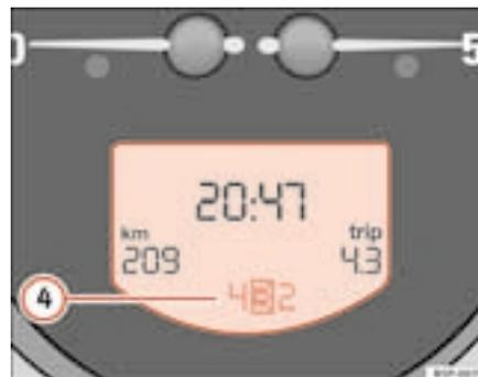
Abb. 36 Ausschnitt aus dem Kombiinstrument: Display mit Ganganzeige für Tiptronic
