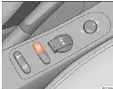
**Abb. 112** Ausschnitt aus der Mittelkonsole: ESP-Taste
