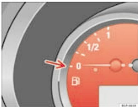
Abb. 33 Ausschnitt aus Kombiinstrument: Kraftstoffvorrats-Anzeige
