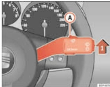
Abb. 83 Scheibenwischerhebel
