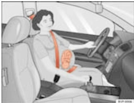
Abb. 14 Gurtbandverlauf bei schwangeren Frauen
