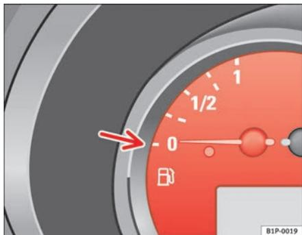
Fig. 33 Quadro strumenti: indicatore del livello del carburante
