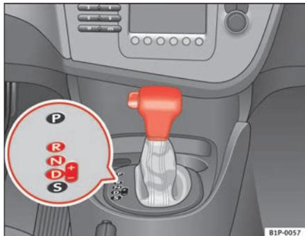
**Fig. 121** Disattivazione del bloccaggio della leva selettoria
