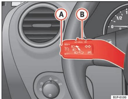
**Fig. 129** Leva degli indicatori di direzione e degli abbaglianti: interruttore e tasto di comando del regolatore di velocità
