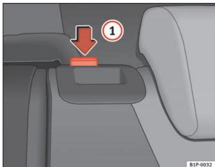
Fig. 94 Sollevamento dello schienale del sedile posteriore
