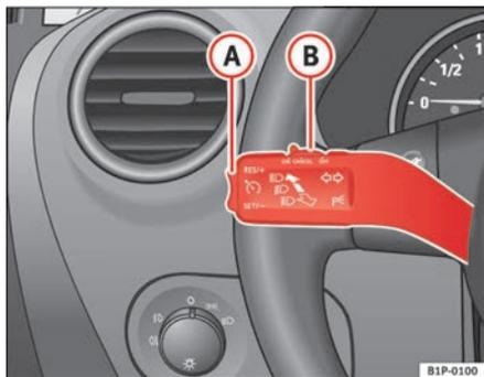
Fig. 130 Leva degli indicatori di direzione e degli abbaglianti: interruttore e tasto di comando del regolatore di velocità
