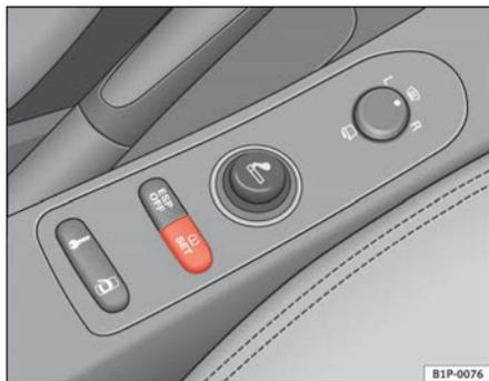
**Fig. 47 Console centrale: tasto del sistema controllo dei pneumatici**
