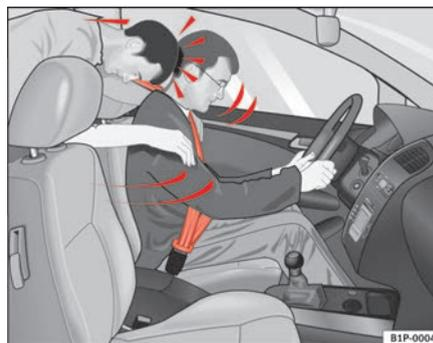
**Fig. 9** Non indossando la cintura, il passeggero seduto sul sedile posteriore viene scagliato in avanti, colpendo il conducente (che invece indossa la cintura).
