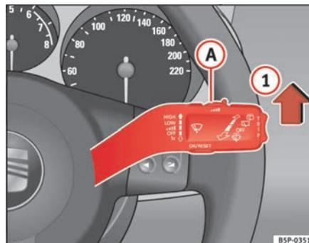
Fig. 84 Leva dell'impianto tergicristalli ▶
