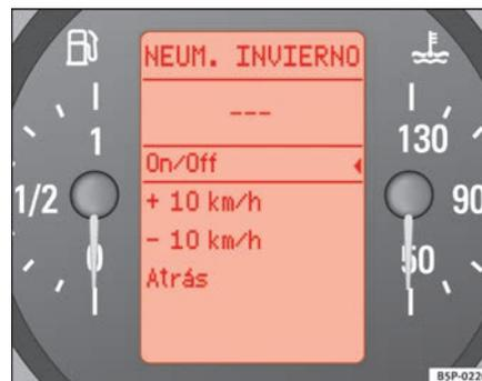
Fig. 45 Display digitale del quadro strumenti: indicatore pneumatici invernali
