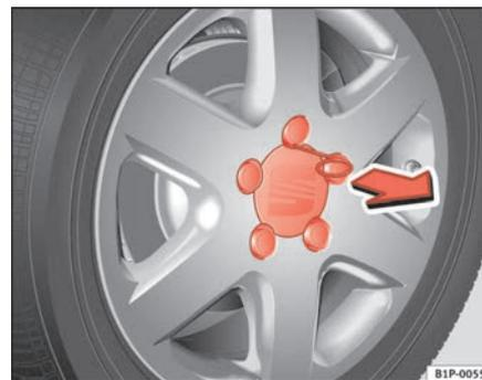
**Fig. 154** Cambio di una ruota: rimuovere il coprimozzo della ruota
