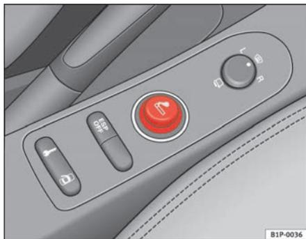
Fig. 100 Accendisigari all'interno della presa di corrente della console centrale anteriore
