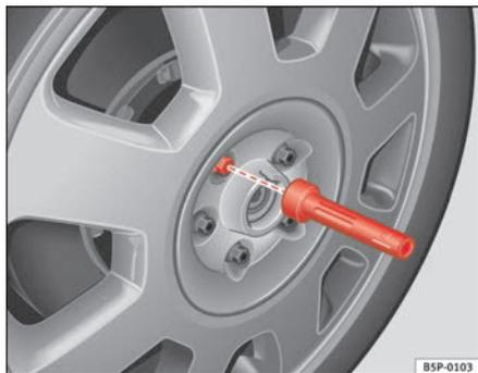
**Fig. 158** Cambio di una ruota: utensile ad esagono cavo per svitare le viti
