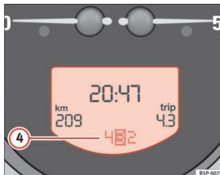
Fig. 36 Dettaglio del quadro strumenti: display con indicatore di marcia del Tiptronic
