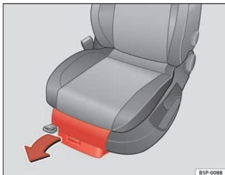
Fig. 96 Rangements sous les sièges avant
