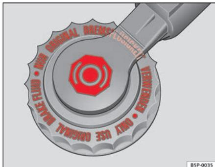
Fig. 150 Dans le compartiment-moteur : bouchon du réservoir de liquide de frein
