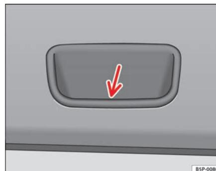
Fig. 66 Détail de la garniture intérieure du capot arrière : cavité pour tirer
