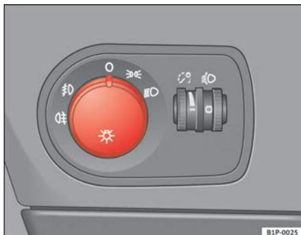
Fig. 72 Vue partielle du tableau de bord : commande des feux, feux antibrouillards avant et arrière
