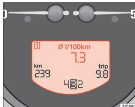
Fig. 41 Afficheur numérique du combiné d'instruments : indicateur de consommation moyenne de carburant.
