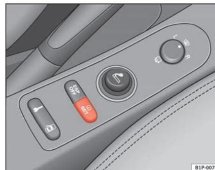
Fig. 47 Console centrale : touche du système de contrôle des pneus
