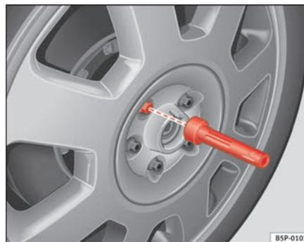
Fig. 158 Changement d'une roue : Outil à six pans creux pour tourner les boulons
