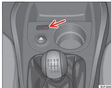
Fig. 26 Témoin de désactivation de l'airbag du passager
