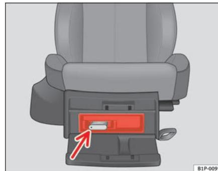
Fig. 103 Connexion iPod sous le siège passager
