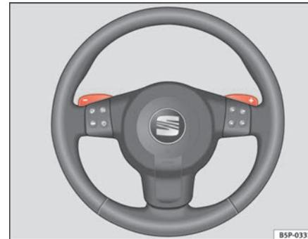
**Fig. 124** Volant avec leviers pour boîte de vitesses automatique
