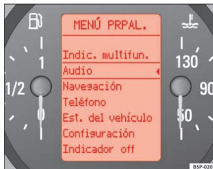
Fig. 43 Afficheur numérique du combiné d'instruments : Menu principal
