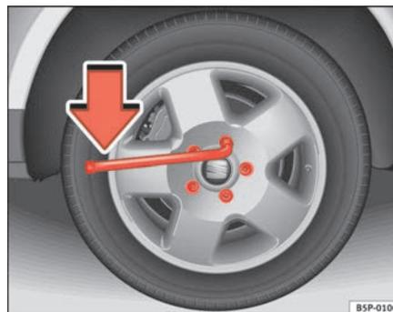
**Fig. 155** Changement d'une roue : desserrer les boulons de roue
