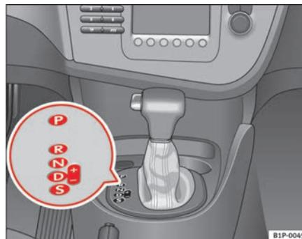
Fig. 119 Console centrale : levier sélecteur de la boîte automatique ou de la boîte DSG
