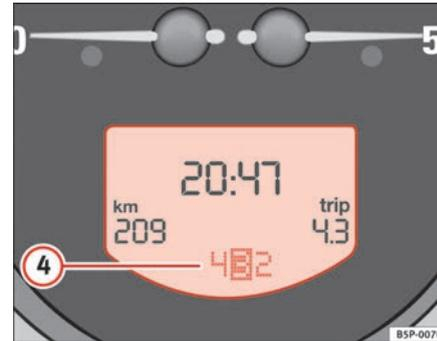
Fig. 36 Détail du combiné d'instruments : afficheur avec indicateur des rapports de la commande Tiptronic
