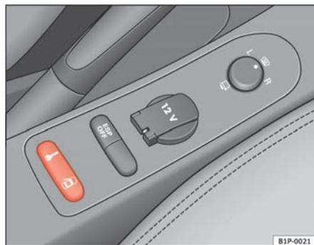
Fig. 59 Détail de la console centrale : Touche de verrouillage central
