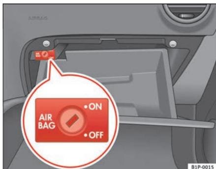
Fig. 25 Dans la boîte à gants se trouve la commande à clé pour activer et désactiver l'airbag du passager
