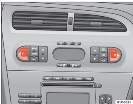
**Fig. 92** Molettes des chauffages de sièges avant
