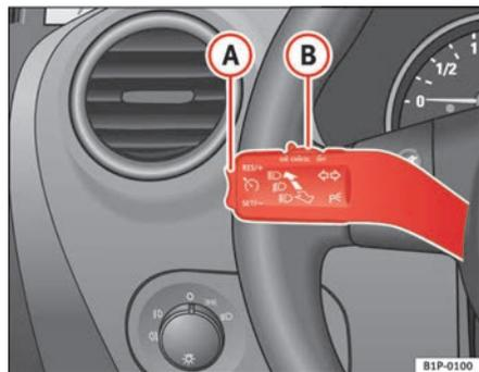
Fig. 127 Levier des clignotants et de l'inverseur-codes : contacteur et touche à bascule pour le régulateur de vitesse
