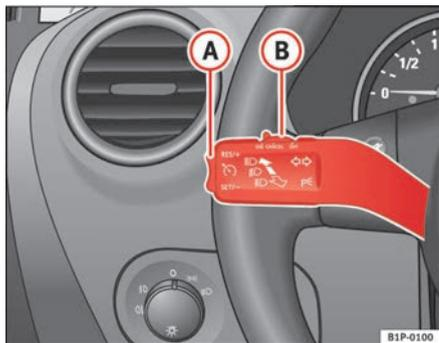
Fig. 129 Levier des clignotants et de l'inverseur-codes : contacteur et touche à bascule pour le régulateur de vitesse
