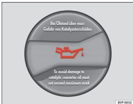
**Fig. 145** Dans le compartiment-moteur : bouchon de l'orifice de remplissage d'huile-moteur
