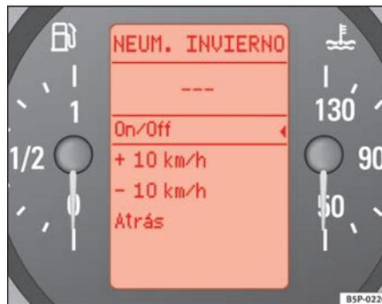
Fig. 45 Afficheur numérique du combiné d'instruments : indicateur de pneus d'hiver
