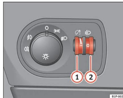
Fig. 74 Tableau de bord : Régulateurs d'éclairage des instruments et des commandes et du site des projecteurs
