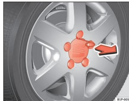
**Fig. 154** Changement d'une roue : Retirer l'enjolveur de roue
