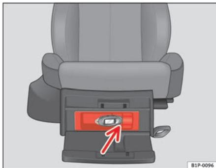
Fig.104 Connexion USB\* sous le siège passager
