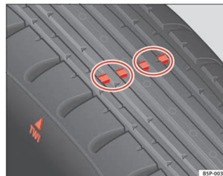
Fig. 151 Indicadores de desgaste del perfil del neumático
