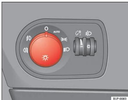
Fig. 73 Encendido automático de luces
