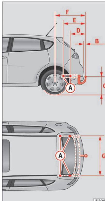
Fig. 139 Puntos de fijación del dispositivo de remolque
