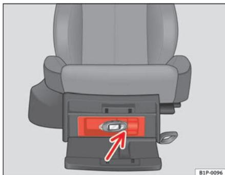
Fig. 104 Conexión USB\* bajo asiento acompañante
