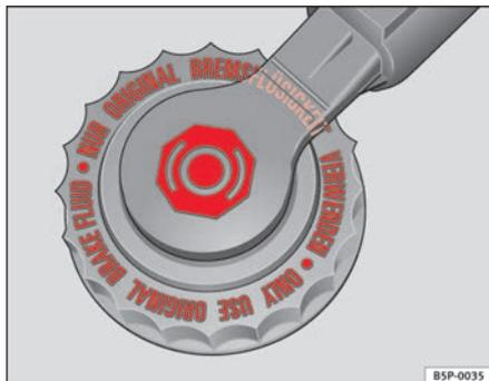
Fig. 150 Tapón del depósito del líquido de frenos en el vano motor
