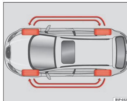
Fig. 152 Esquema para el cambio de ruedas
