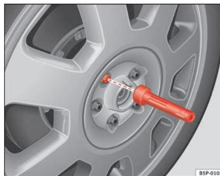
Fig. 158 Cambio de rueda: Útil de hexágono interior para girar los tornillos
