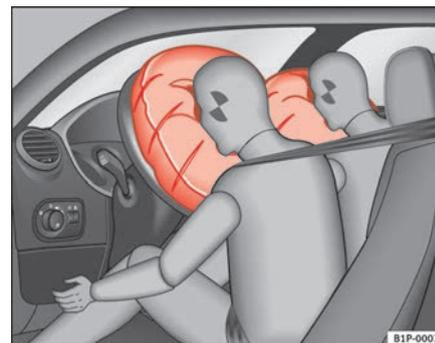
Abb. 19 Aufgeblasene Frontairbags
