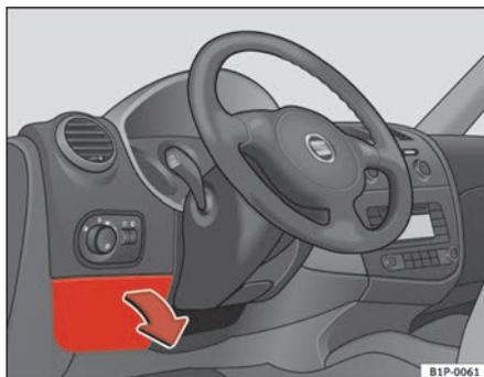
Abb. 160 Links in der Instrumententafel: Abdeckung des Sicherungskastens
