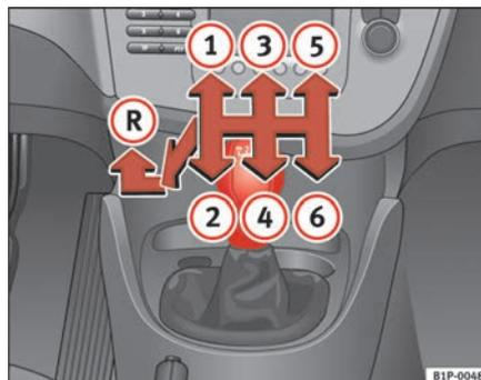
Abb. 118 Ausschnitt aus der Mittelkonsole: Schalt-schema des 6-Gang-Schaltgetriebes ▶
