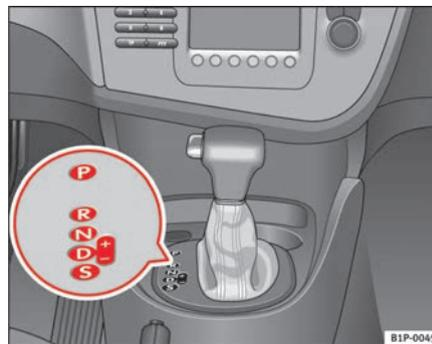
Abb. 119 Ausschnitt aus der Mittelkonsole: Wählhebel des Automatikgetriebes / Direktschaltgetriebes DSG
