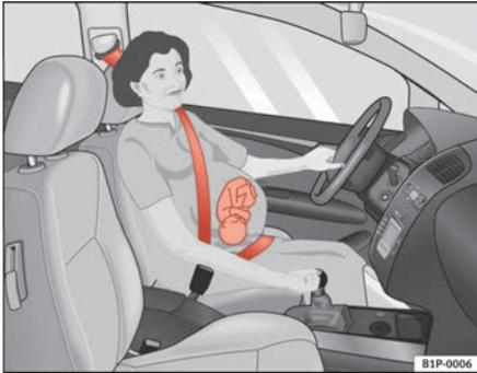
Abb. 14 Gurtbandverlauf bei schwangeren Frauen
