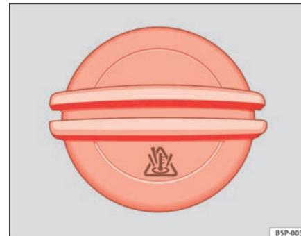
Abb. 146 Im Motorraum: Deckel des Kühlmittel-Ausgleichsbehälters
