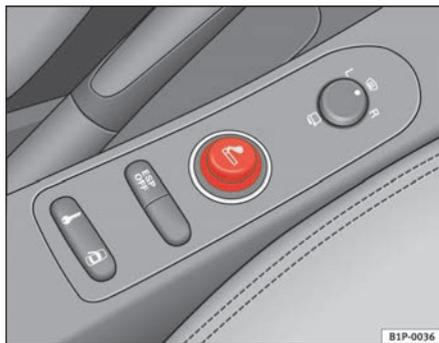
Abb. 100 Der Zigarettenanzünder befindet sich im der Steckdose der vorderen Mittelkonsole
