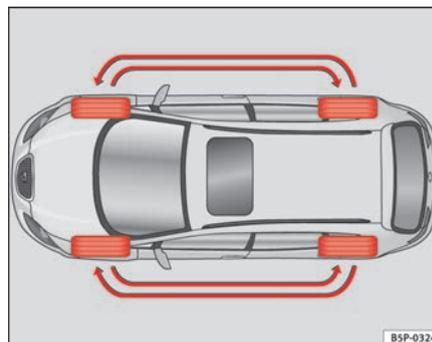
Abb. 152 Schema für das Tauschen der Räder
