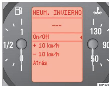
Abb. 45 Display im Kombiinstrument: Anzeige Winterreifen
