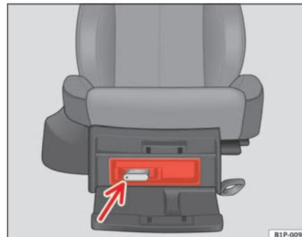
Abb. 103 Anschluss iPod unter dem Beifahrersitz
