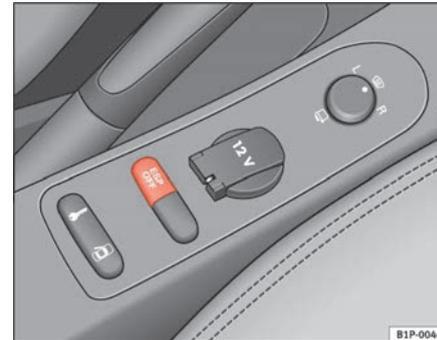
**Abb. 115** Ausschnitt aus der Mittelkonsole: ESP-Taste
