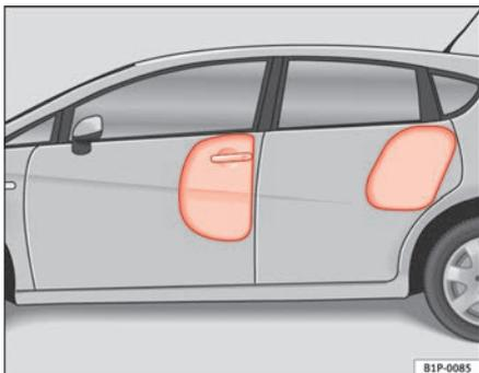
**Abb. 22** Prinzipdarstellung: Aufgeblasene Seitenairbags auf der linken Fahrzeugseite
