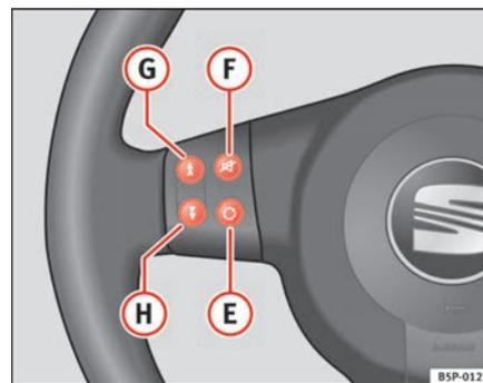
Abb. 49 Lenkradschalter
