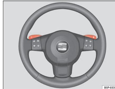
Abb. 124 Lenkrad mit Wippen für Automatikgetriebe
