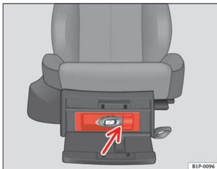
Abb. 104 USB-Anschluss\* unter dem Beifahrersitz
