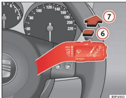
Abb. 85 Scheibenwischer- und Scheibenwischerhebel: Scheibenwischer für die Heckscheibe
