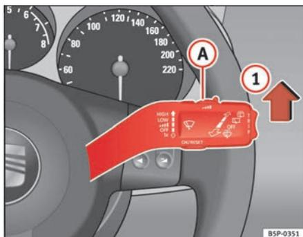
Abb. 84 Scheibenwischerhebel
