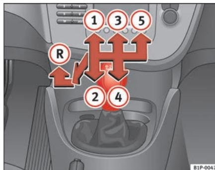
Abb. 117 Ausschnitt aus der Mittelkonsole: Schalt-schema des 5-Gang-Schaltgetriebes
