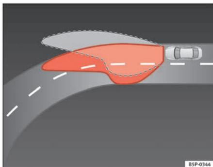
Abb. 75 Beleuchtung der Kurve mit automatisch gerichteten Scheinwerfern
