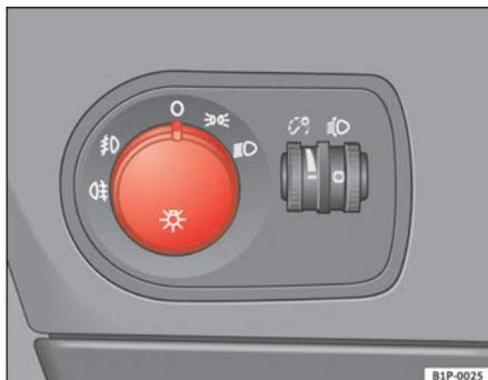
Abb. 72 Ausschnitt aus der Instrumententafel: Schalter für Licht, Nebelscheinwerfer und Nebelschlussleuchte
