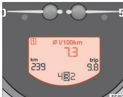
Abb. 41 Display im Kombiinstrument: Anzeige des durchschnittlichen Kraftstoffverbrauchs
