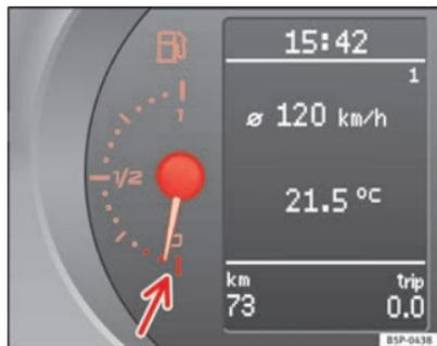
Fig. 33 Quadro strumenti: indicatore del livello del serbatoio carburante
