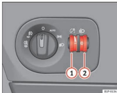
Fig. 74 Plancia portastrumenti: regolatori dell'intensità di illuminazione degli strumenti e degli interruttori e regolatore assetto fari
