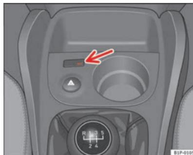
Fig. 26 Spia della disattivazione degli airbag del passeggero anteriore
