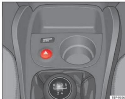
**Fig. 76** Plancia portastrumenti: interruttore lampeggio di emergenza
