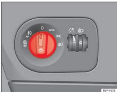
Fig. 72 Dettaglio della plancia portastrumenti: interruttore luci, fari fendinebbia e retronebbia
