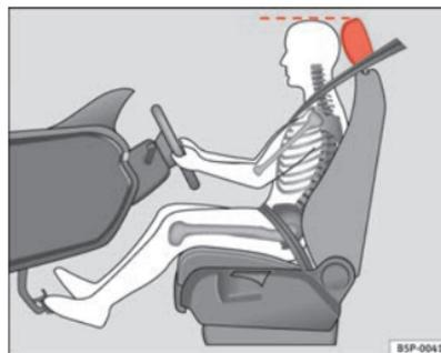
Fig. 2 Corretto posizionamento del poggiatesta del conducente
