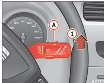
Fig. 84 Leva dell'impianto tergicristalli ►
