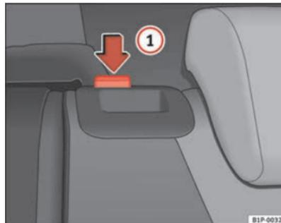
Fig. 95 Sollevamento dello schienale del sedile posteriore
