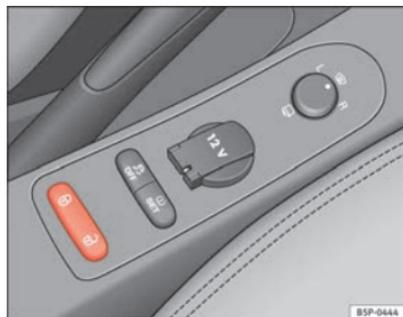
Fig. 58 Dettaglio della console centrale: interruttore della chiusura centralizzata
