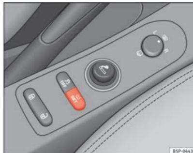
Fig. 49 Console centrale: tasto del sistema controllo dei pneumatici: ►
