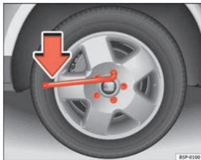
**Fig. 157** Cambio di una ruota: allentare le viti della ruota
