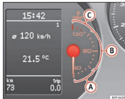
Fig. 34 Quadro strumenti: indicatore della temperatura del liquido di raffreddamento
