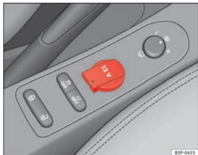
Fig. 101 Presa di corrente console centrale anteriore
