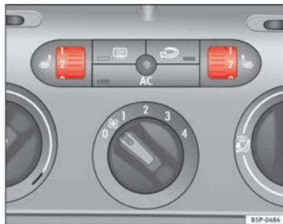
**Fig. 92** Rotelle zigrinate per il riscaldamento dei sedili anteriori
