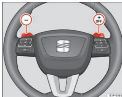
**Fig. 129** Volante con leve per il cambio automatico ▶
