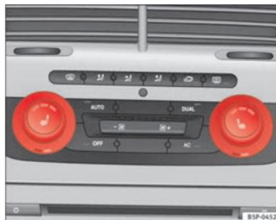
**Fig. 93** Riscaldamento sedili anteriori con Climatronic
