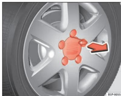
**Fig. 156** Cambio di una ruota: rimuovere il coprimozzo della ruota
