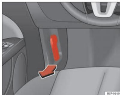
**Fig. 142** Dettaglio del vano piedi sul lato del conducente: leva per l'apertura del cofano del vano motore.
