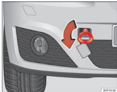
**Fig. 183** Lato anteriore destro del veicolo: montaggio dell'anello per traino anteriore
