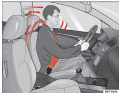
**Fig. 10** Conducente con la cintura di sicurezza allacciata correttamente: durante una frenata brusca viene trattenuto dalla cintura di sicurezza
