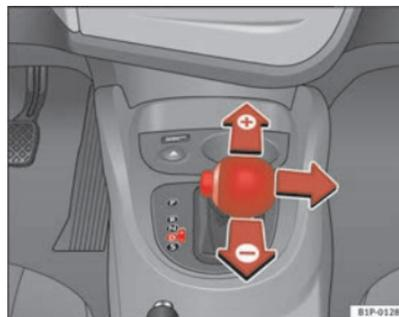
**Fig. 128** Cambio del rapporto di marcia con Tiptronic
