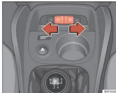
Fig. 103 Apertura del connettore nella console centrale
