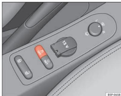
**Fig. 117** Dettaglio della console centrale: tasto ESP
