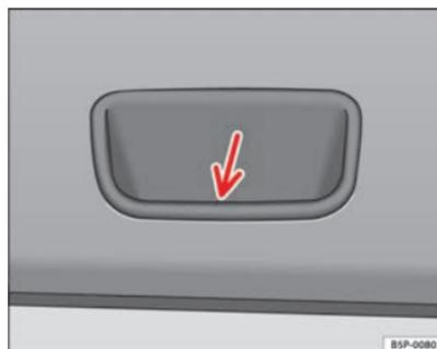
Fig. 66 Dettaglio del rivestimento interno del cofano vano bagagli: maniglia di presa ad incavo
