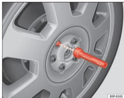
Fig. 160 Cambio di una ruota: utensile ad esagono cavo per svitare le viti
