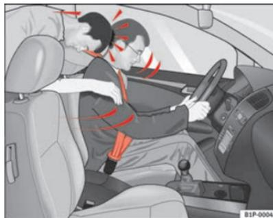
**Fig. 9 Non indossando la cintura, il passeggero seduto sul sedile posteriore viene scagliato in avanti, colpendo il conducente (che invece indossa la cintura)**
