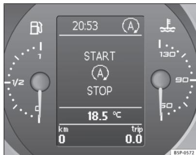
Fig. 121 Indicazione nel display del quadro strumenti durante la modalità Start-Stop.
