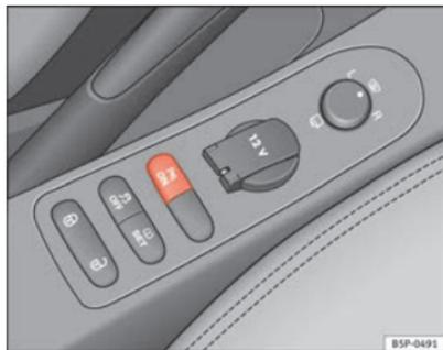
Fig. 131 Console centrale: Interruttore del sistema di assistenza per il parcheggio
