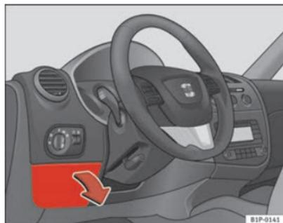
**Fig. 162** Lato sinistro della plancia portastrumenti: copertura della scatola dei fusibili
