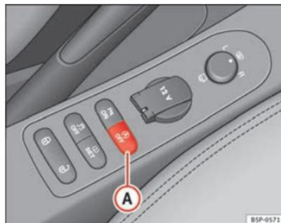
Fig. 120 Dettaglio del pulsante della modalità Start-Stop.
