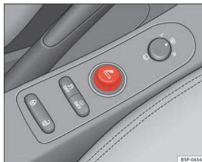
Fig. 100 Accendisigari all'interno della presa di corrente della console centrale anteriore
