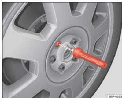
Fig. 160 Cambio de rueda: Útil de hexágono interior para girar los tornillos
