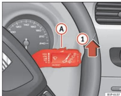
Fig. 84 Palanca del limpiaparabrisas
