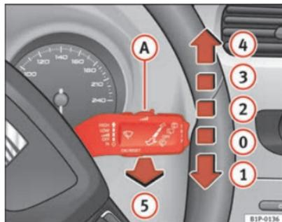
Fig. 82 Palanca del limpia-lavacristales
