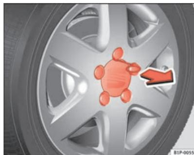
**Fig. 156** Cambio de rueda: Retirar el embellecedor de la rueda
