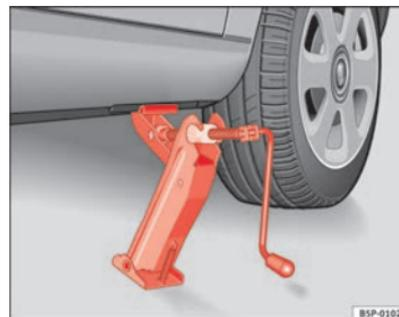
Fig. 159 Colocación del gato
