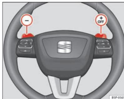
Fig. 129 Volante con palancas para cambio automático
