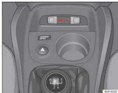
Fig. 104 Conector en consola central
