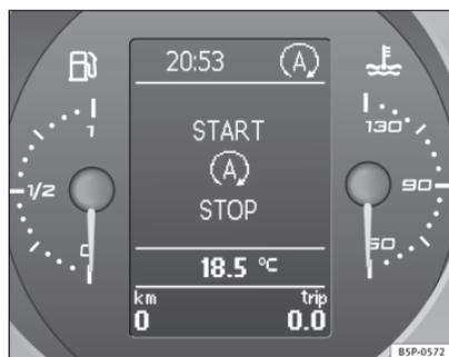
Fig. 121 Indicación en la pantalla del cuadro de instrumentos durante el funcionamiento Start-Stop.
