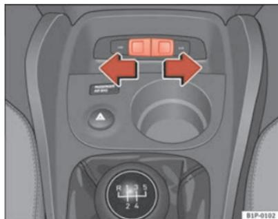
Fig. 103 Apertura del conector en consola central
