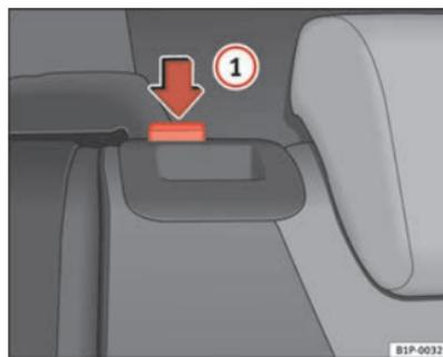
Fig. 95 Levantar el respaldo del asiento trasero
