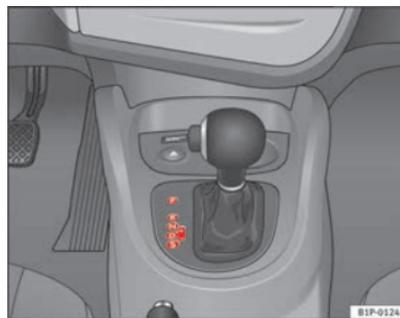
Fig. 124 Consola central: palanca selectora del cambio automático / cambio automático DSG
