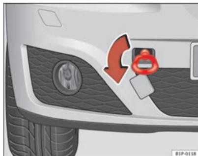
Fig. 183 Atornillado de la argolla de remolque en la parte delantera derecha del vehículo
