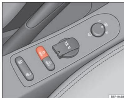
**Fig. 117** Detalle de la consola central: tecla ESP
