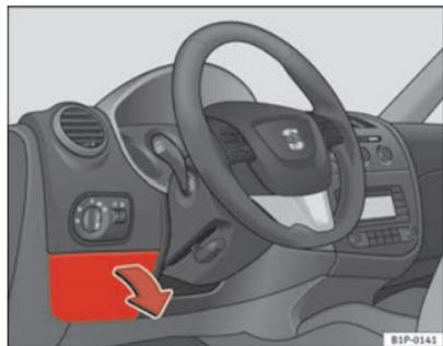
Fig. 162 Tapa de la caja de fusibles en el lado izquierdo del tablero de instrumentos
