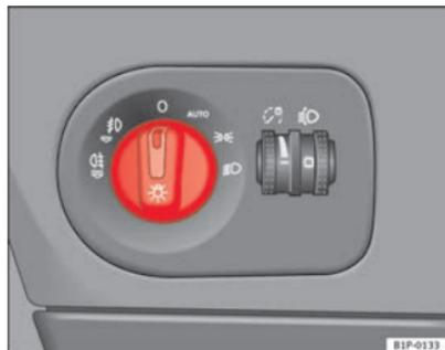
Fig. 73 Encendido automático de luces
