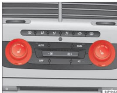
**Fig. 93** Calefacción asientos delanteros con Climatronic
